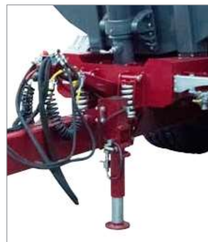
Hydrauliczna, łamana podpora dyszla z odcinającym zaworem kulowym
