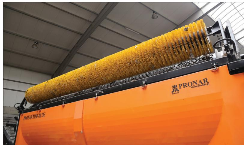
△ W celu zapewnienia stałej skuteczności przesiewania, w górnej części perforowanego bębna zamontowano szczotkę walcową, która wypycha odpady nagromadzo-ne w oczkach. Jest ona opuszczana i podnoszona hydraulicznie
