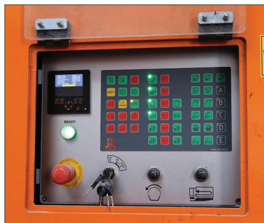
▷ Regulacja prędkości prze-nośników taśmowych odbywa się w bardzo prosty spo-sób za pomocą potencjome-trów hydraulicznych. Zwiększąc prędkość można la-two usypywać większe przy-zmy, bez konieczności prze-mieszczania całej maszyny
