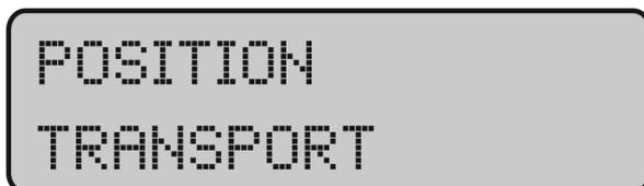
Stellen Sie nach dem Entladen des Ballens den Drehtisch in die Transportposition. Halten Sie die **ENTER**-Taste (9) und die Tischhubtaste (16) gedrückt.
