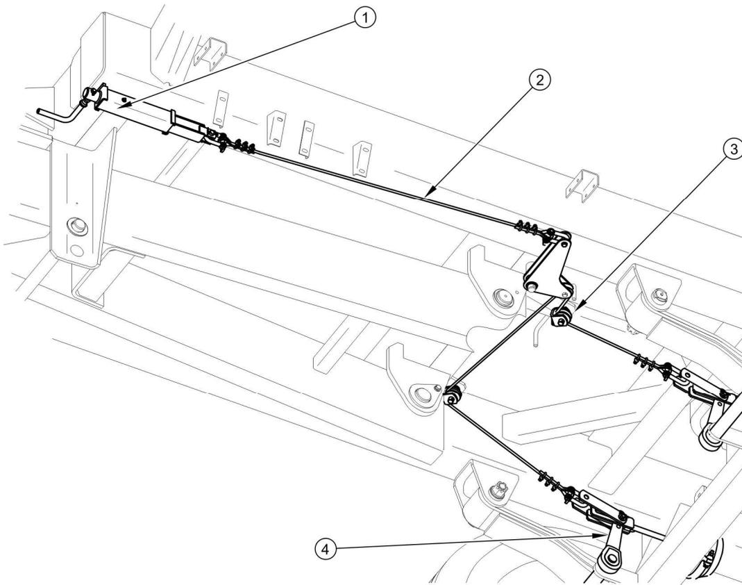
**ABBILDUNG 3.11 Aufbau der Feststellbremse**
