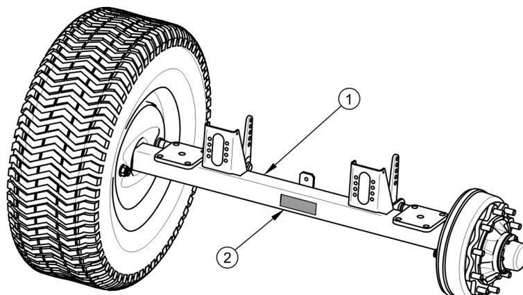
**ABBILDUNG 1.2** Lokalisierung des Typenschildes an der Fahrachse
