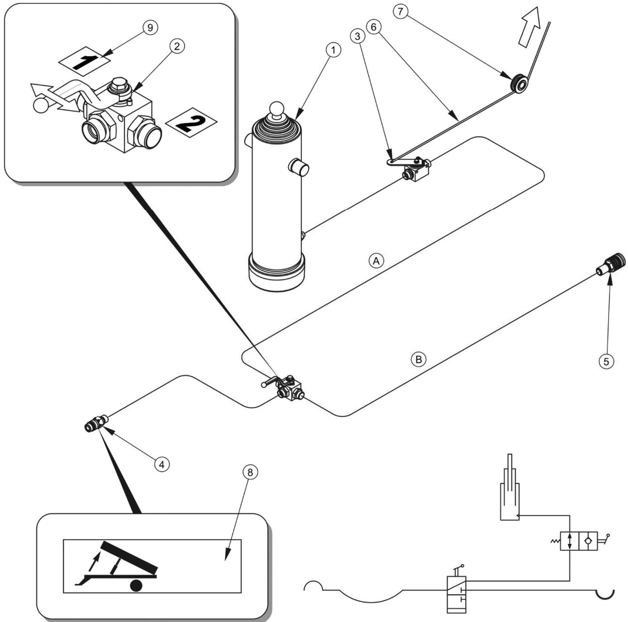
**ABBILDUNG 3.9** Aufbau und Schema der Hydraulikanlage der Kippvorrichtung
