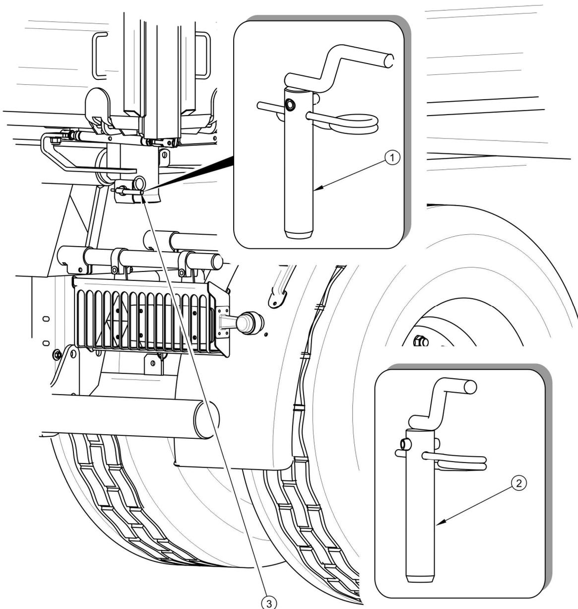
**ABBILDUNG 4.3** Verriegelung der Kippbolzen
