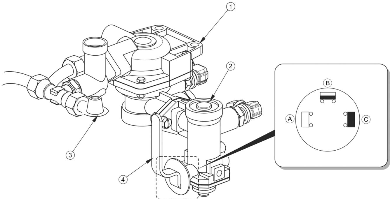
**ABBILDUNG 3.8 Steuerventil und Bremskraftregler**
