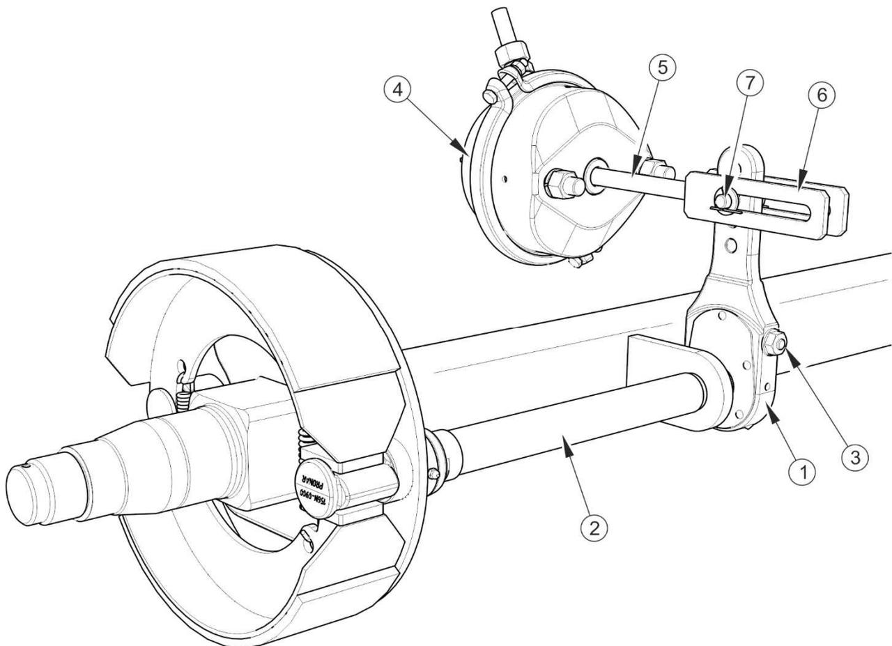
**ABBILDUNG 5.5** Aufbau der Bremse an der Fahrachse
