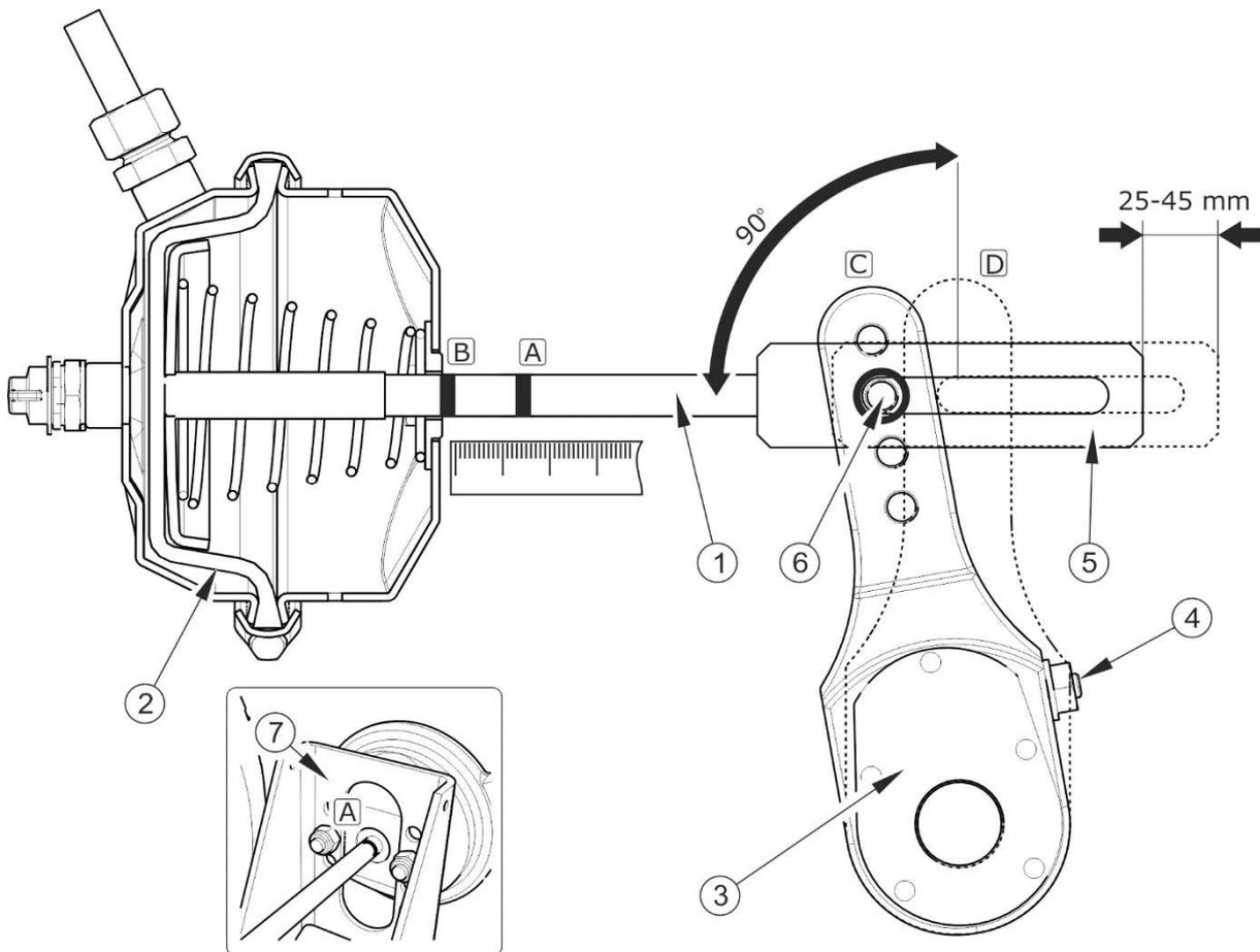
**ABBILDUNG 5.6 Regeln bei der Einstellung der Bremse**
