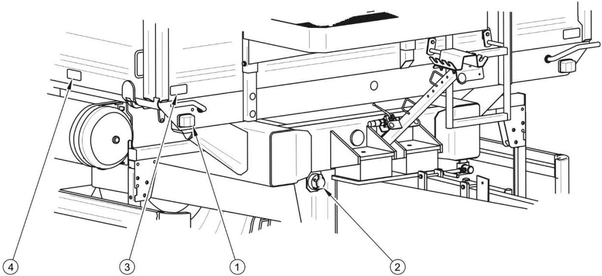
**ABBILDUNG 3.14 Anordnung der Elemente der Elektroinstallation und der Rückstrahler – Vorderansicht**
