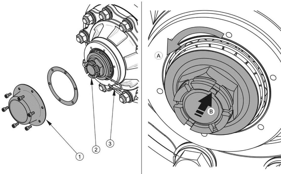
**ABBILDUNG 5.2 Einstellen des Lagers an der Fahrachse**
