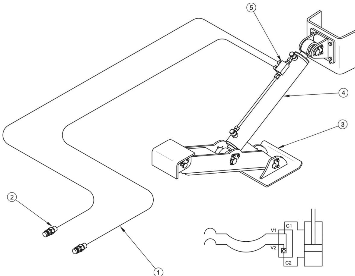
**ABBILDUNG 3.10** Aufbau und Schema der Hydraulikanlage des Stützfußes
