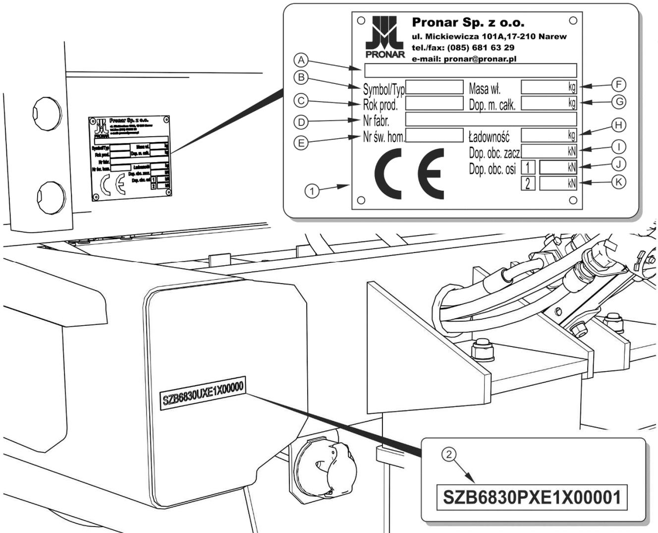
**ABBILDUNG 1.1** Lokalisierung des Typenschilds und der eingeschlagenen Seriennummer
