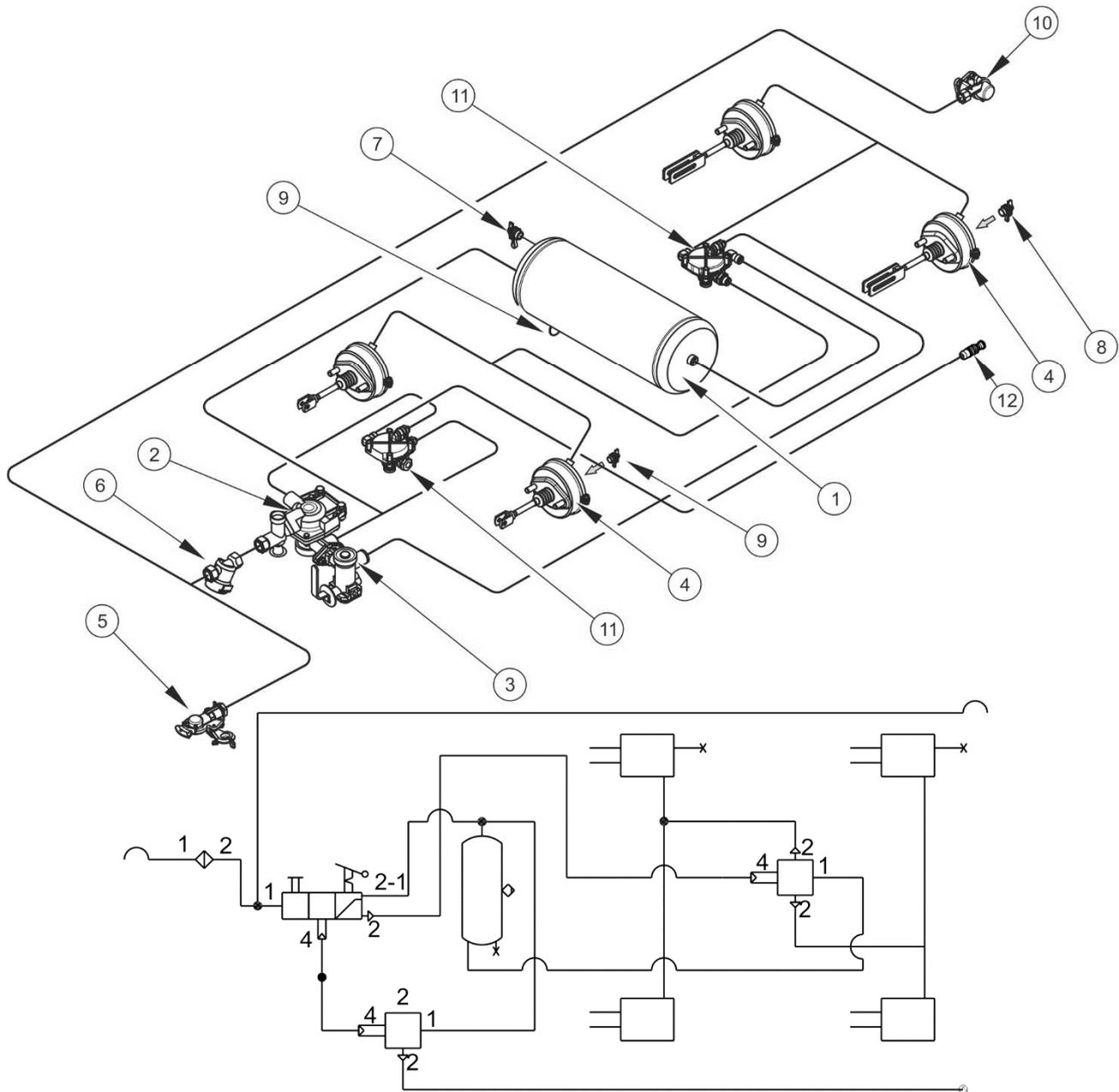
**ABBILDUNG 3.4 Aufbau und Schema der Einkreis-Druckluftbremse**
