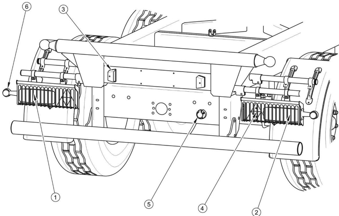
**ABBILDUNG 3.13 Anordnung der Elemente der Elektroinstallation und der Rückstrahler – Rückansicht**
