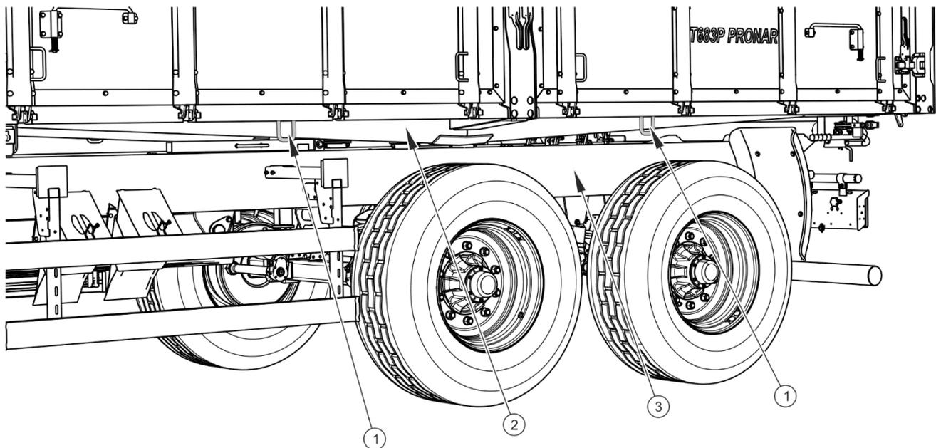
**ABBILDUNG 1.3 Anordnung der Transporthalterungen**
