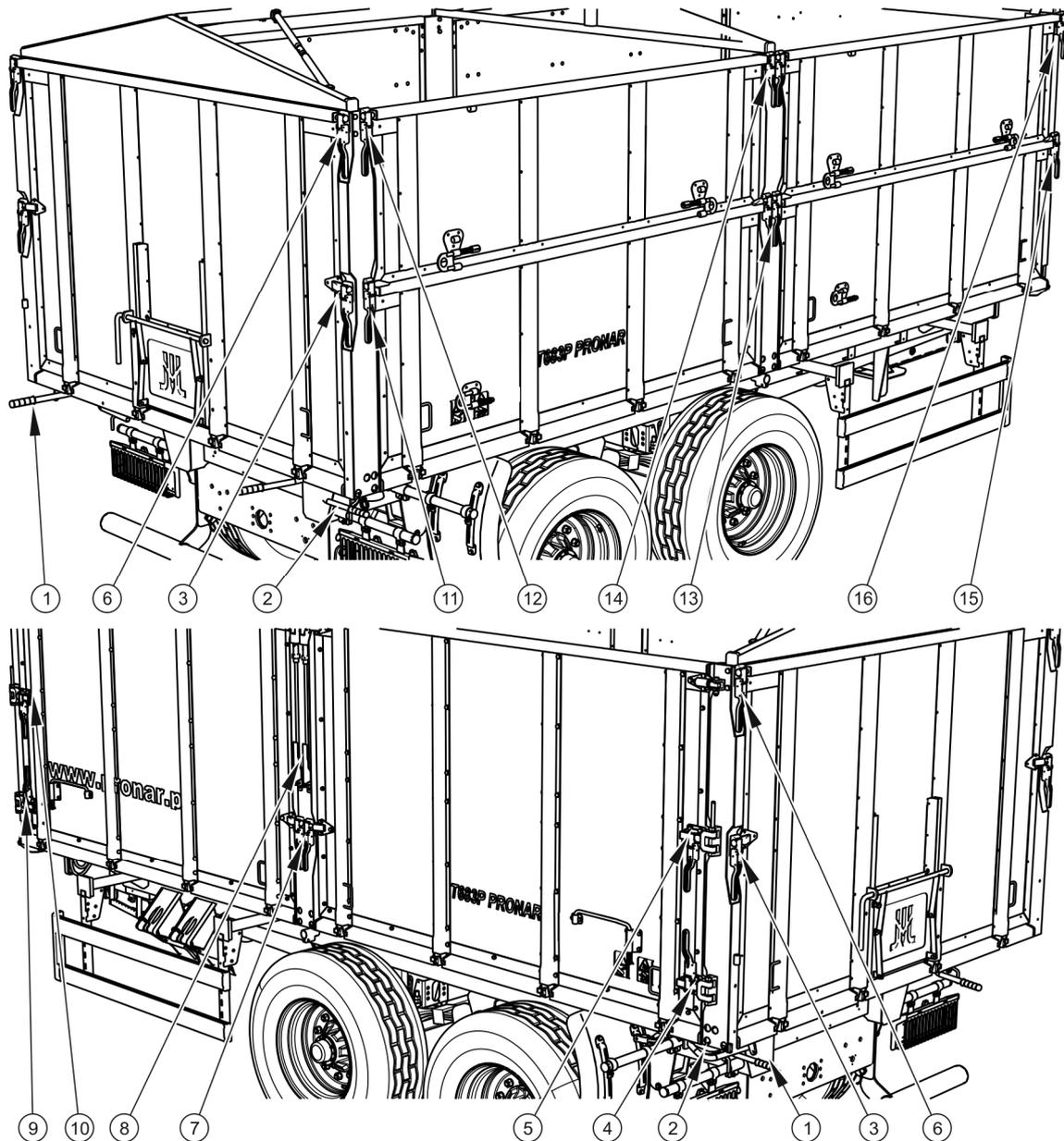
**ABBILDUNG 4.5 Anordnung der Schlösser und Riegel an den Anhängerwänden**
