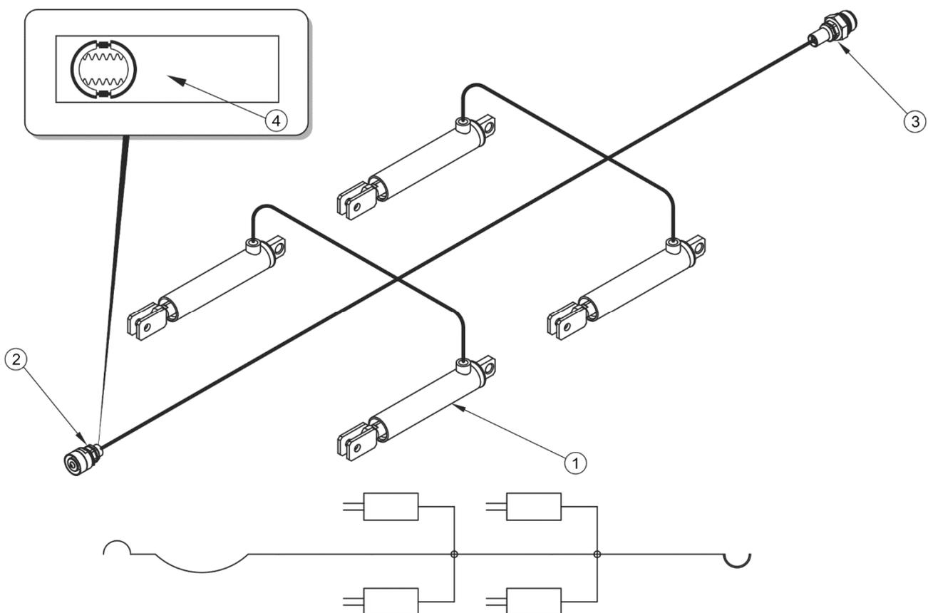
**ABBILDUNG 3.7** Aufbau und Schema der Hydraulikbremse
