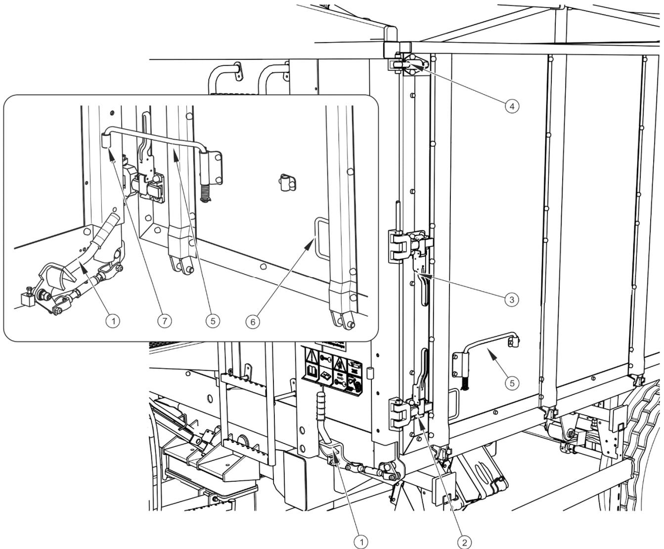
**ABBILDUNG 4.4** Öffnen der linken Portalwand des Ladekastens
