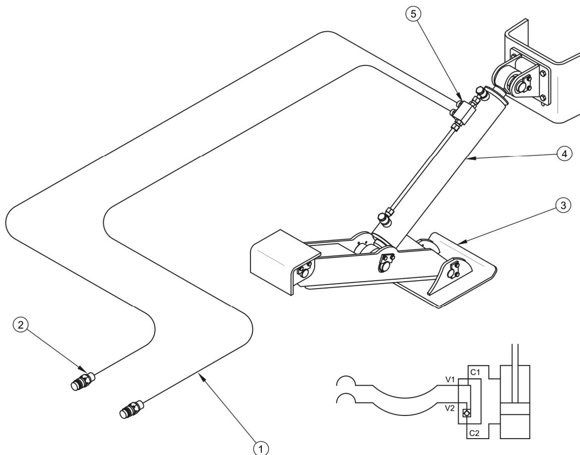
**РИСУНОК 3.10 Устройство и схема гидравлической системы ножевой опоры**
