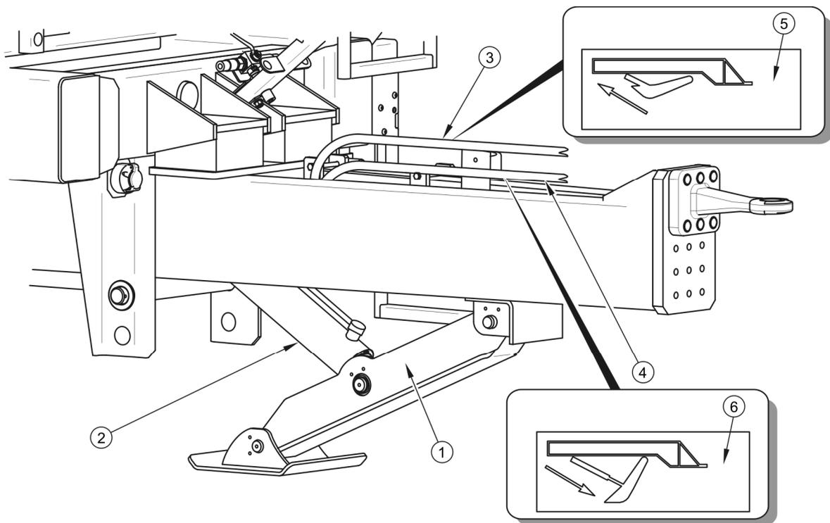
**РИСУНОК 4.1 Опора прицепа**
