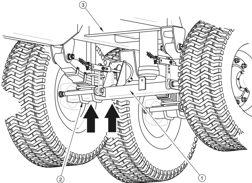
**РИСУНОК 5.1 Точка поддомкрачивания**
