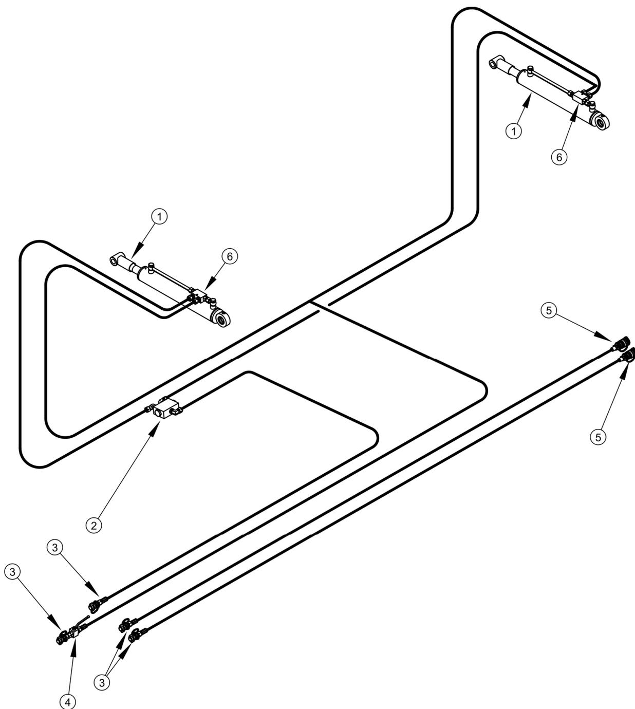
**РИСУНОК 3.11 Устройство и схема гидравлической системы открытия бортов**
