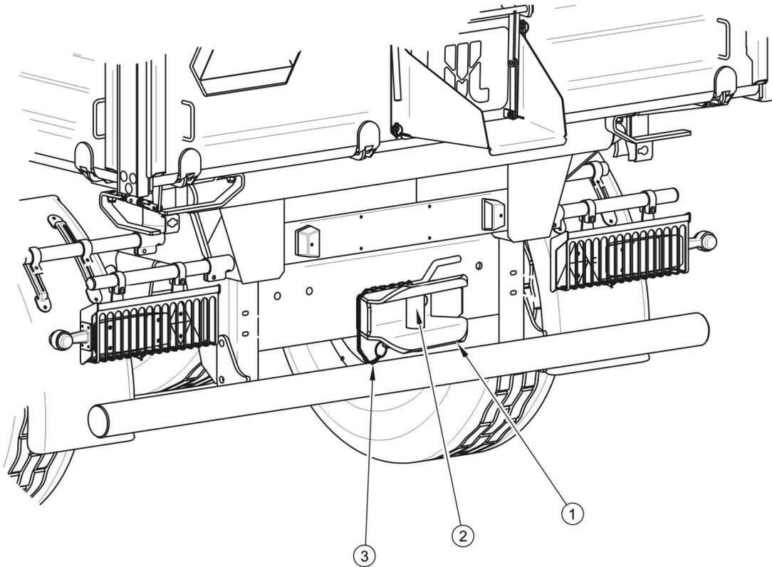
**РИСУНОК 4.2** Заднее тяговое устройство прицепа
