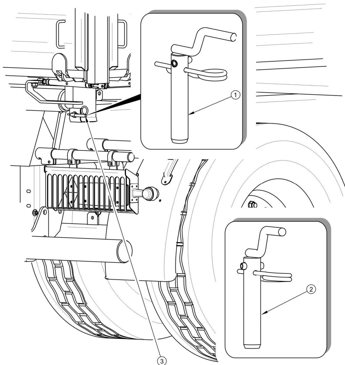
**РИСУНОК 4.4** Блокировка болтов опрокидывающего механизма
