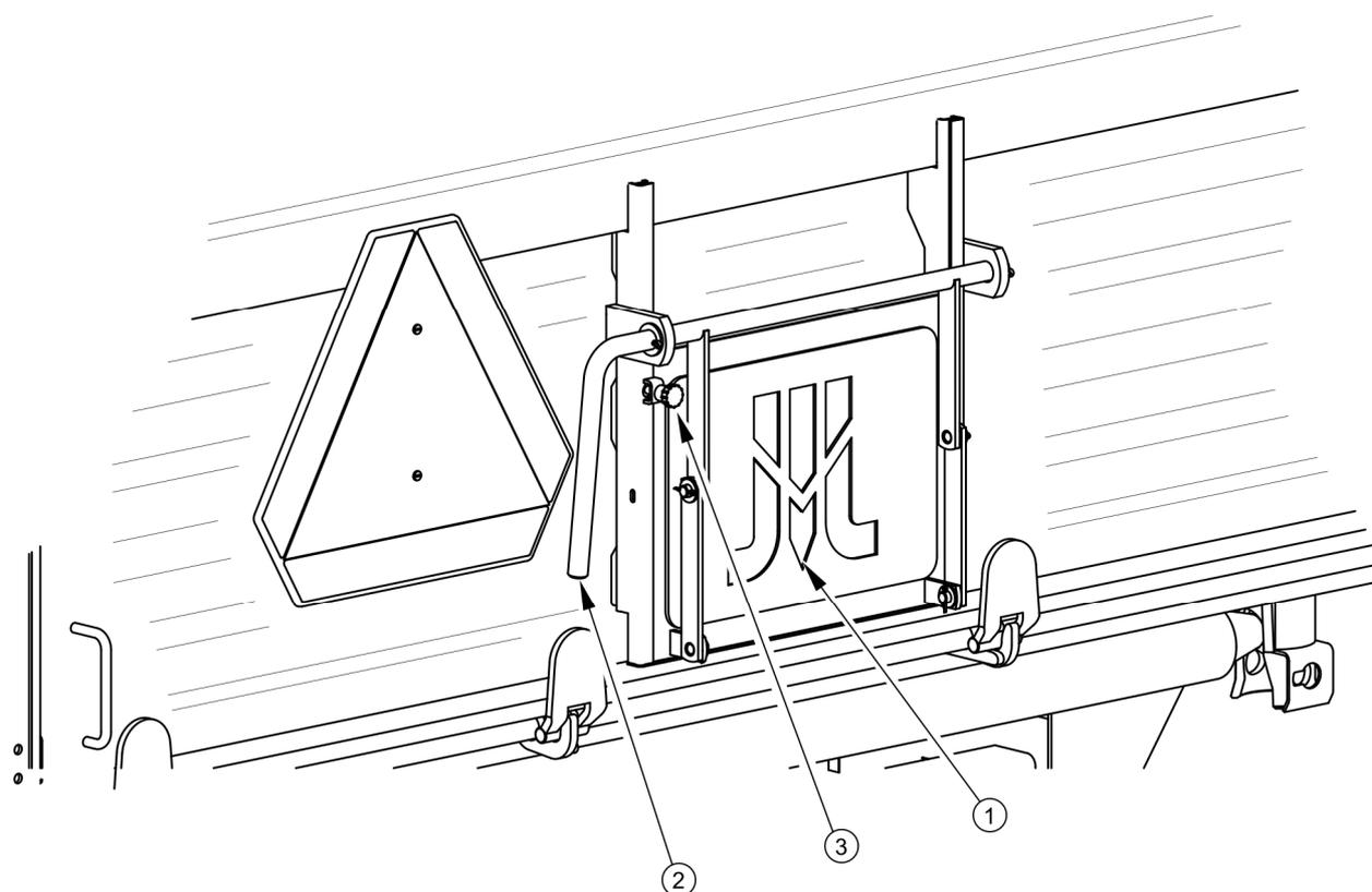
**РИСУНОК 3.3 Разгрузочный люк в заднем борту**
