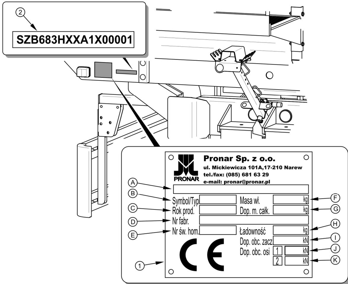
**РИСУНОК 1.1** Размещение заводского щитка и заводского номера
