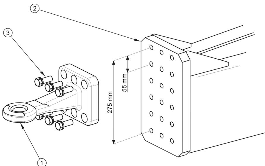
**РИСУНОК 5.11** Регулировка положения тяги дышла
