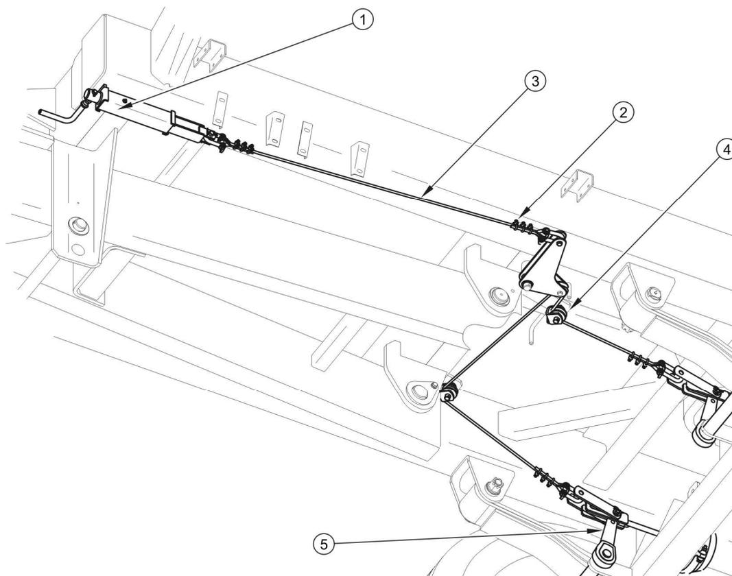
**РИСУНОК 5.5** Регулирование натяжения тросов стояночного тормоза
