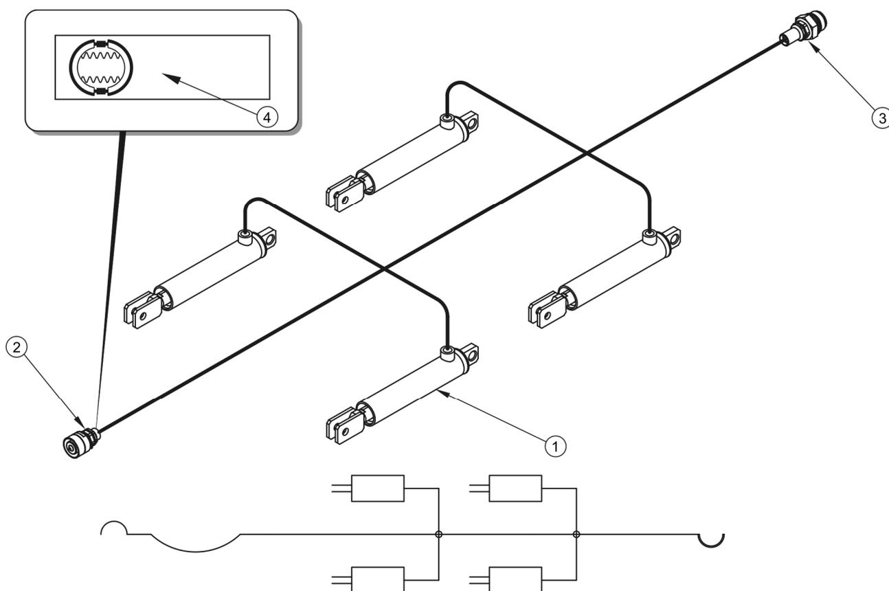
**РИСУНОК 3.7 Устройство и схема гидравлической тормозной системы**
