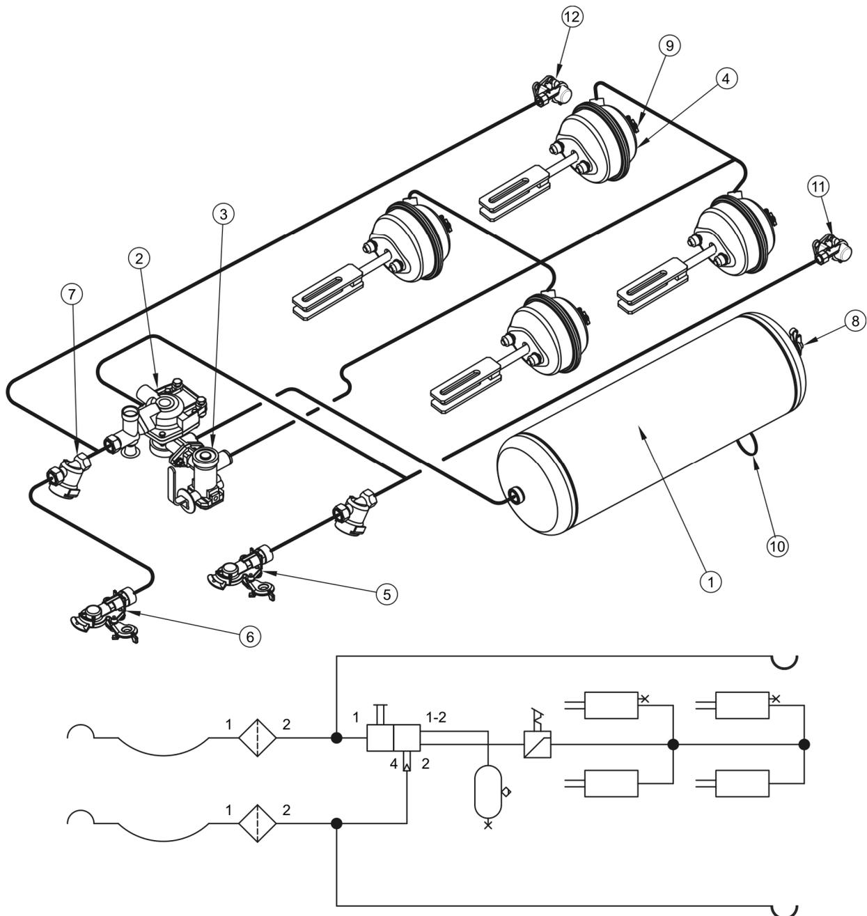
**РИСУНОК 3.5 Устройство и схема двухпроводной пневматической тормозной системы с ручным регулятором силы торможения**
