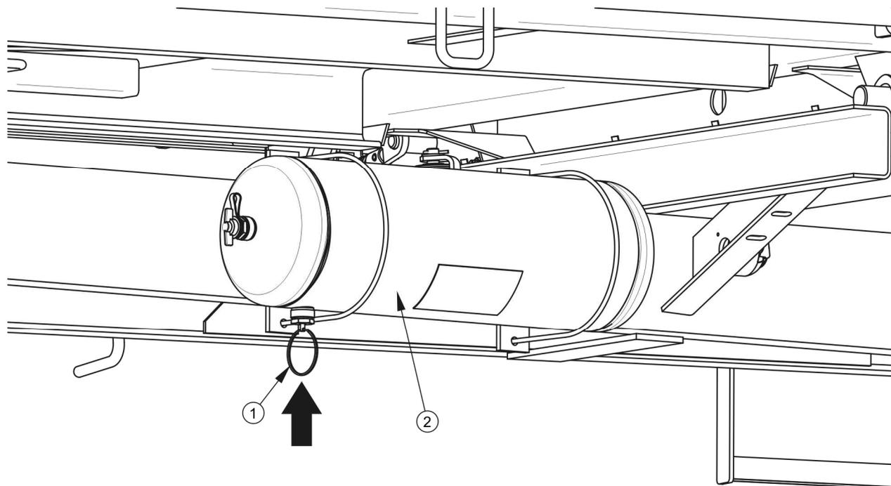
**РИСУНОК 5.7 Отвод конденсата из емкости для сжатого воздуха**
