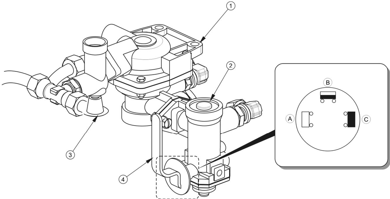
**РИСУНОК 3.8** Управляющий клапан и регулятор силы торможения
