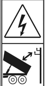
A two-part warning sign. The top part shows a lightning bolt inside an equilateral triangle, indicating a risk of electric shock. The bottom part shows a trailer being lowered from a truck, with a lightning bolt striking it, illustrating the hazard of proximity to power lines.                                                | <p>Внимание: Риск поражения током.</p> <p>При разгрузке прицепа необходимо следить за тем, чтобы прицеп находился на безопасном расстоянии от воздушных силовых линий.</p> |
