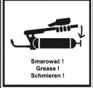
An illustration of a grease gun being applied to a cylindrical component. Below the gun, the text "Smarować ! Grease ! Schmieren !" is repeated in three languages: Polish, English, and German, all meaning "Grease!"                                                                                                             | <p>Смазку прицепа производить в соответствии с указаниями, изложенными в руководстве по эксплуатации.</p>                                                                  |
