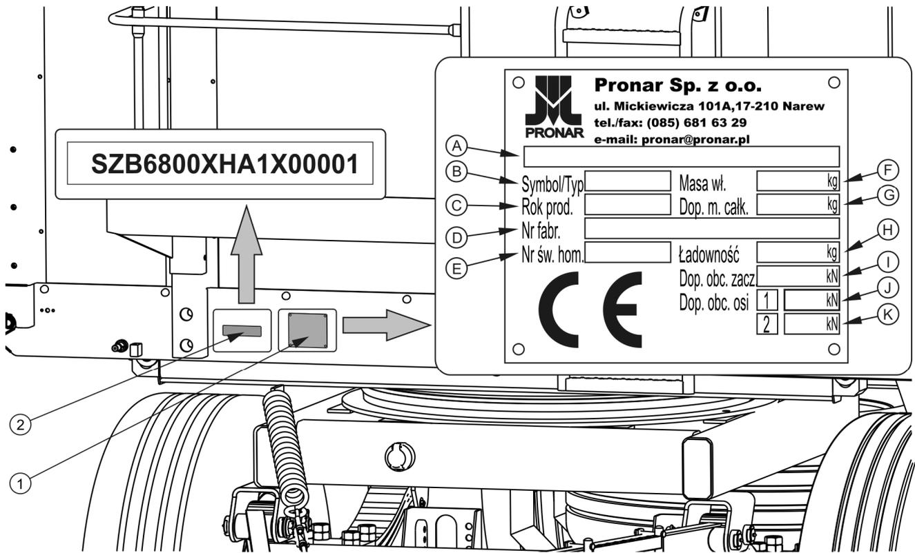
**РИСУНОК 1.1** Размещение заводского щитка
