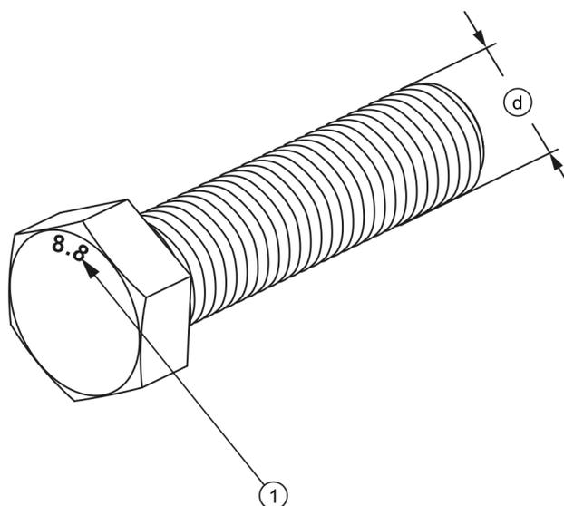
**РИСУНОК 5.10** Болт с метрической резьбой
