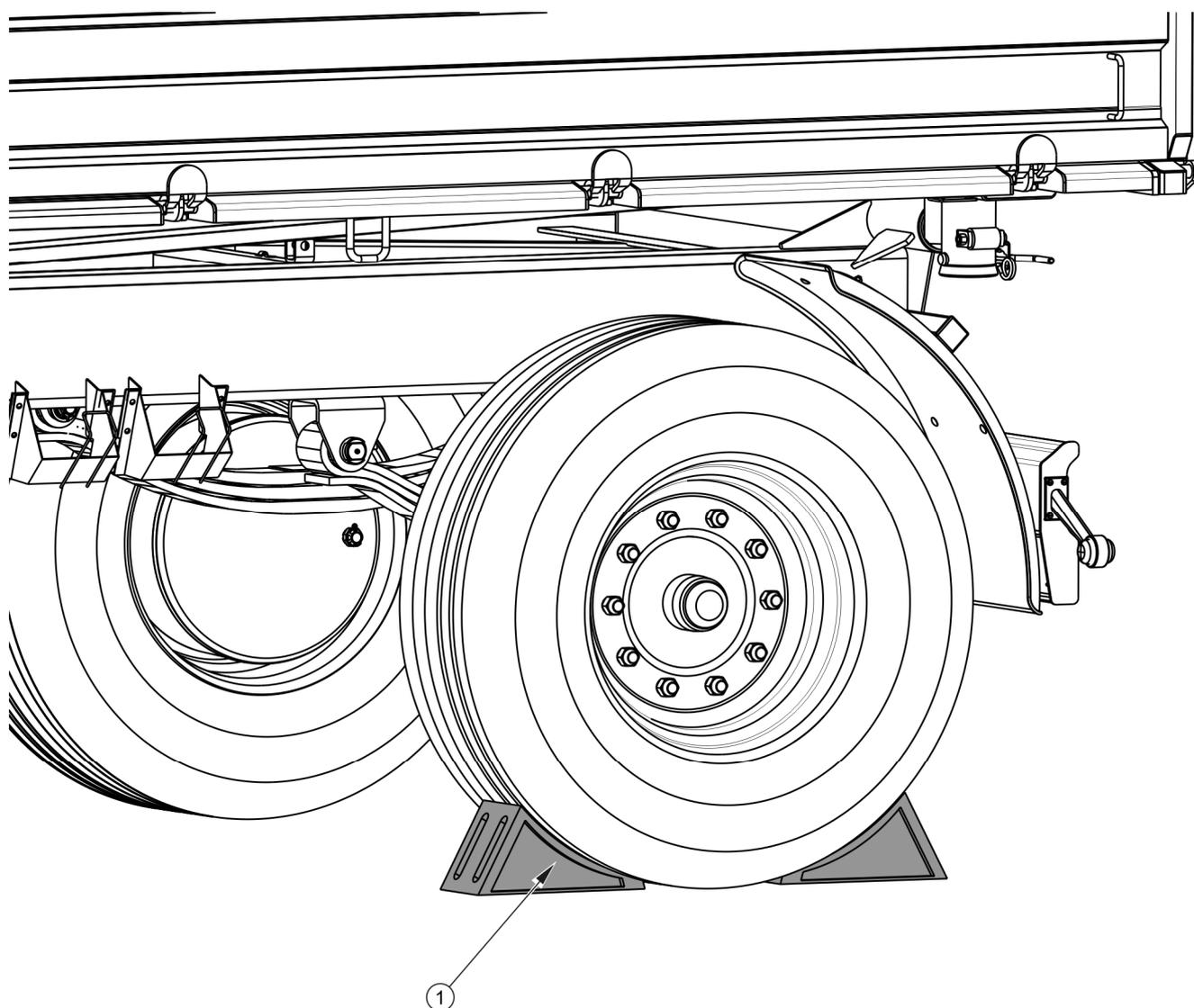
**РИСУНОК 2.1** Способ установки клиньев
