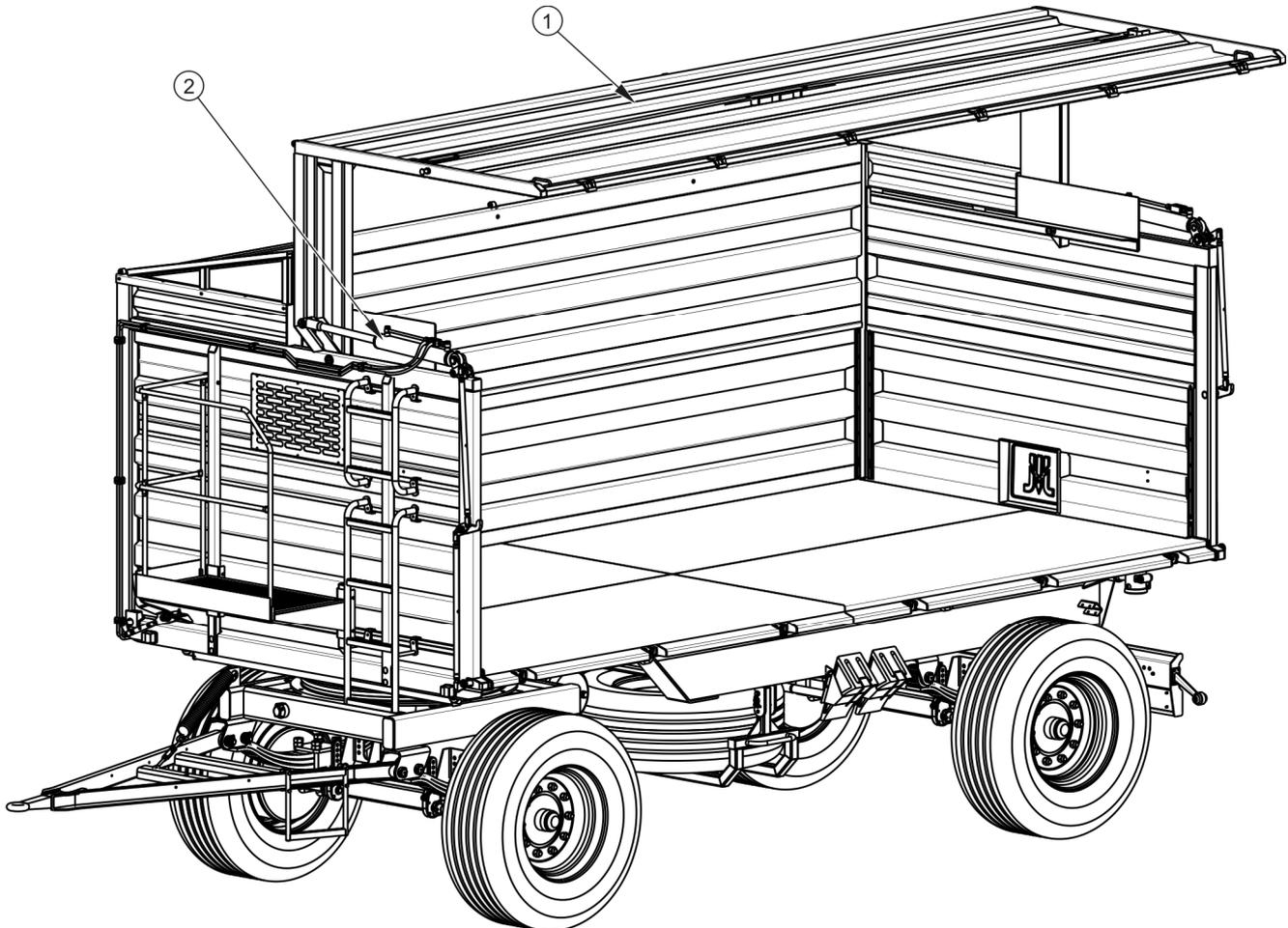
**РИСУНОК 4.3** Гидравлически поднимающийся борт
