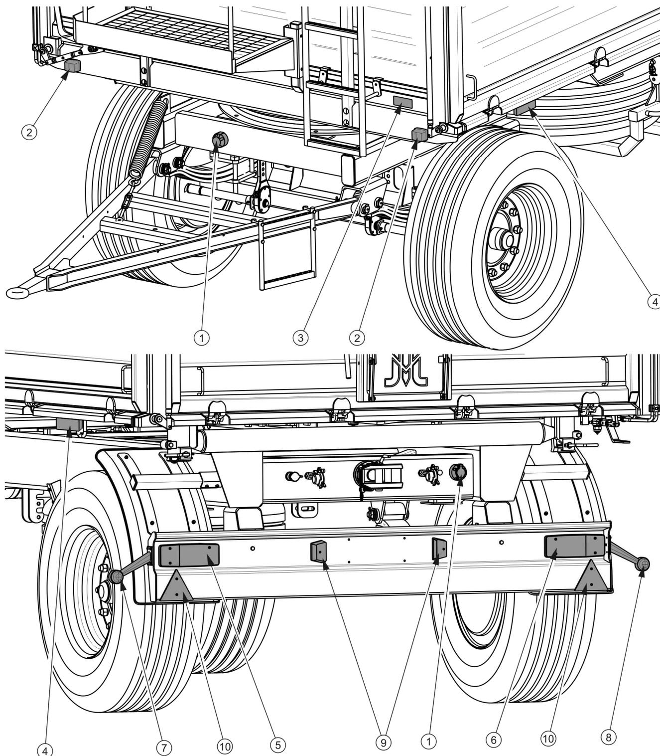
**РИСУНОК 3.14** Размещение элементов электрической системы и светоотражающей сигнализации
