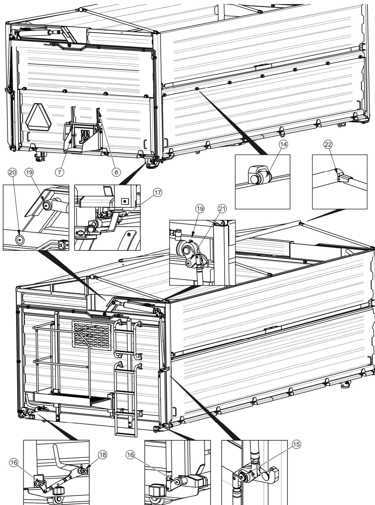
РИСУНОК 5.9 Точки смазки прицепа, часть 2
