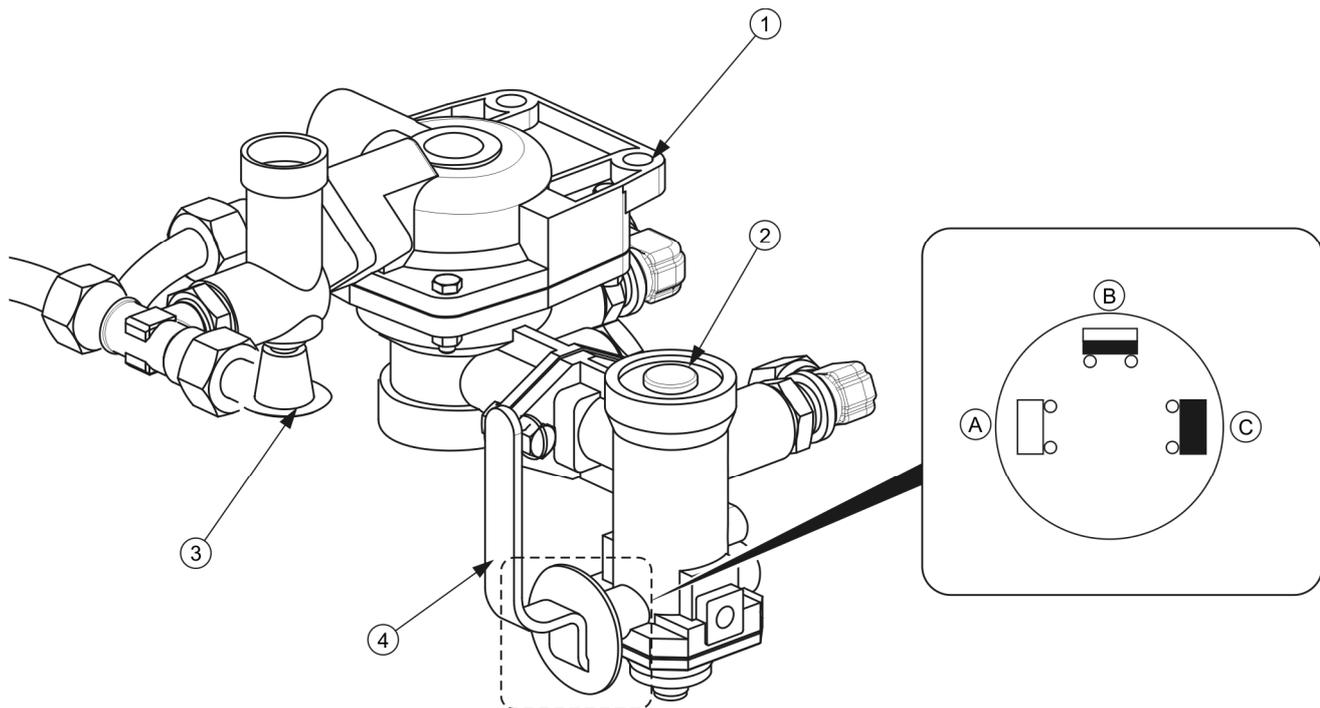
**РИСУНОК 3.8 Управляющий клапан и регулятор силы торможения**
