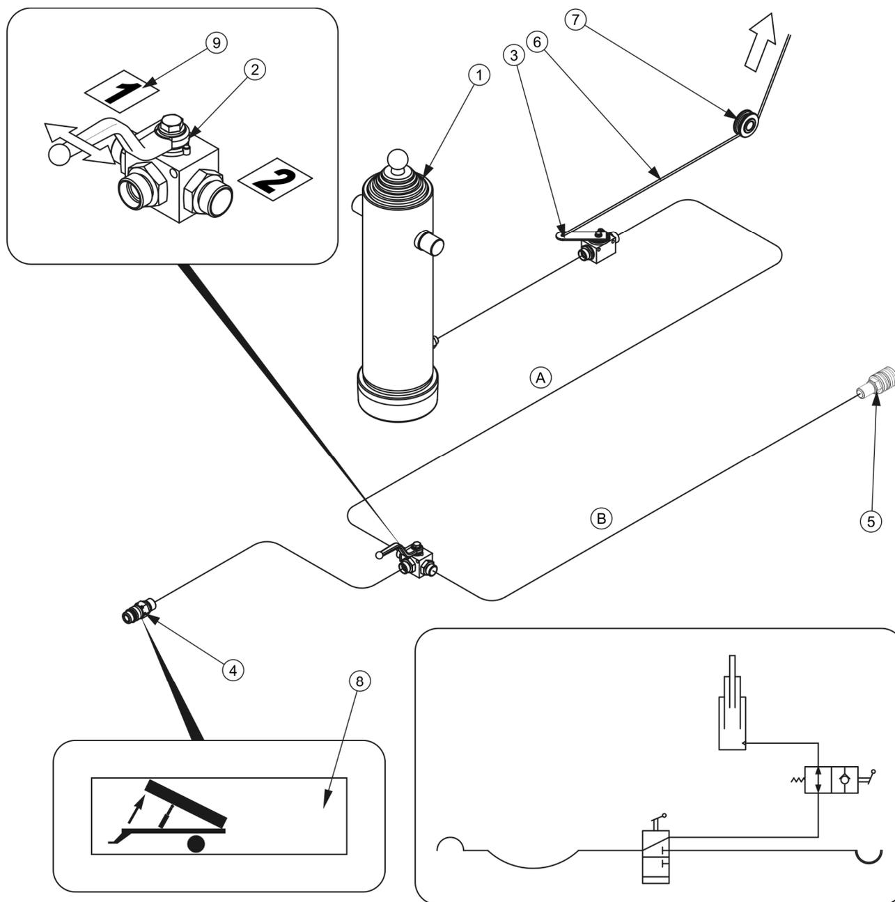
**РИСУНОК 3.9** Схема гидравлической системы опрокидывания
