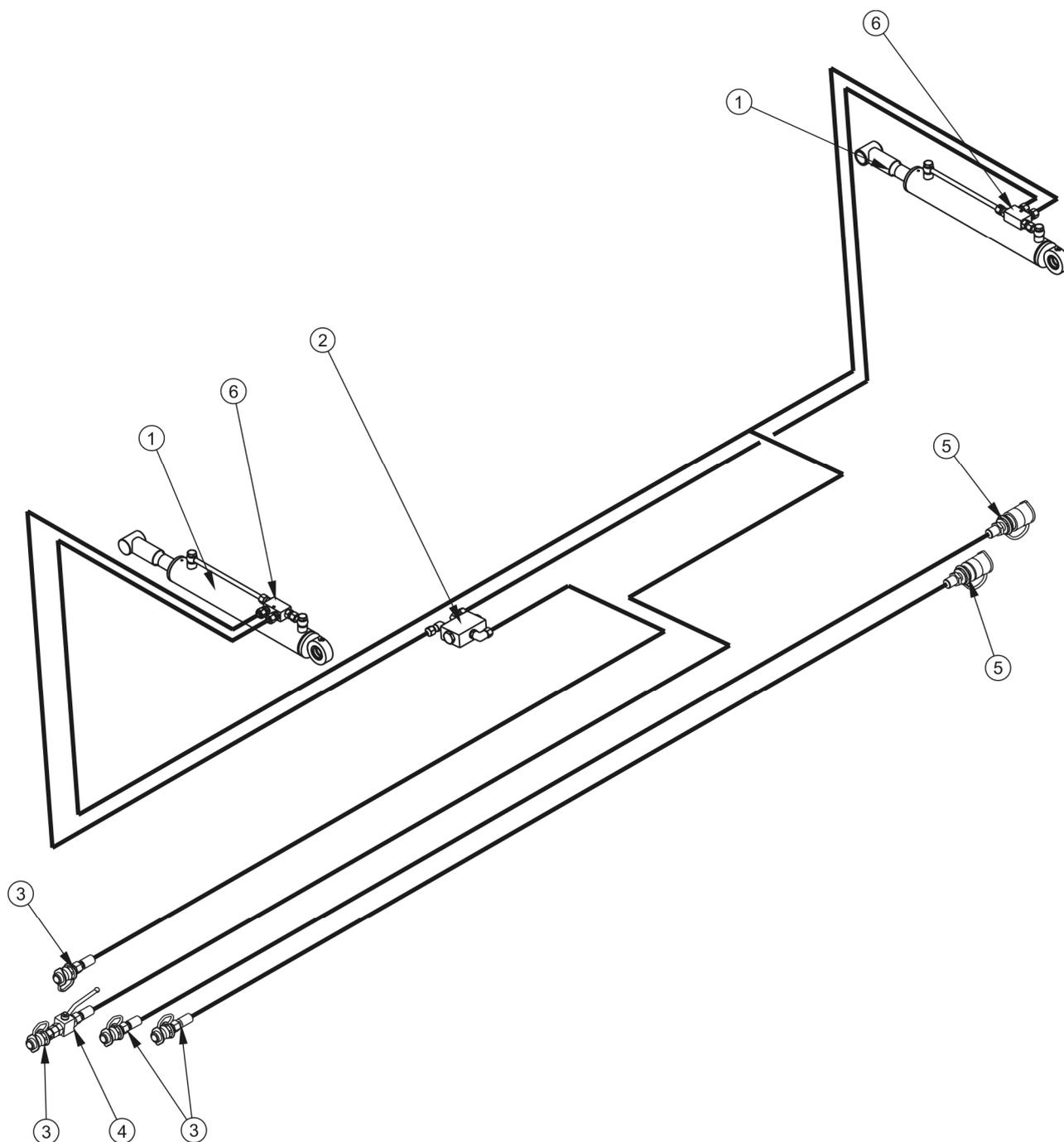
**РИСУНОК 3.12**Схема гидравлической системы открытия борта
