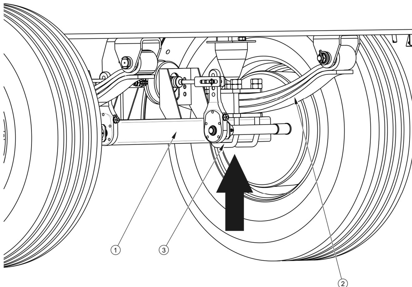
**РИСУНОК 5.1** Точка поддомкрачивания
