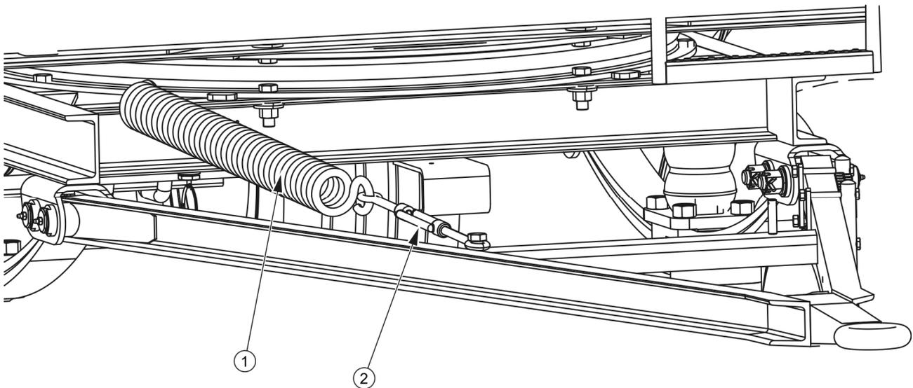
**РИСУНОК 5.11** Регулирование положения дышла
