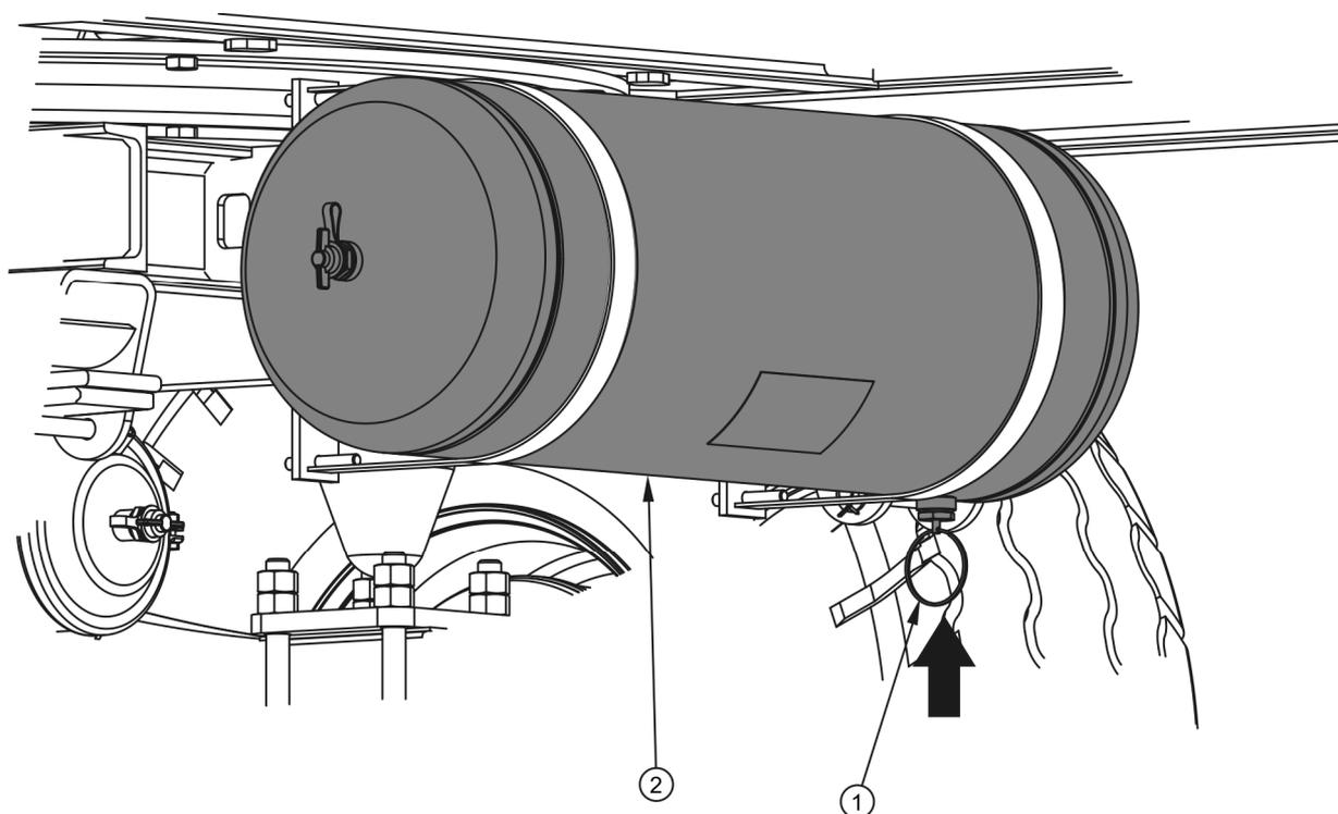
**РИСУНОК 5.7 Отвод конденсата из емкости для сжатого воздуха**
