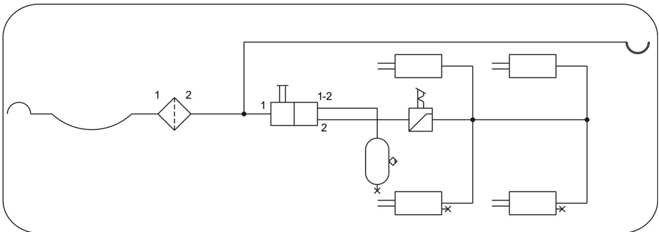
**РИСУНОК 3.4 Однопроводная пневматическая система**
