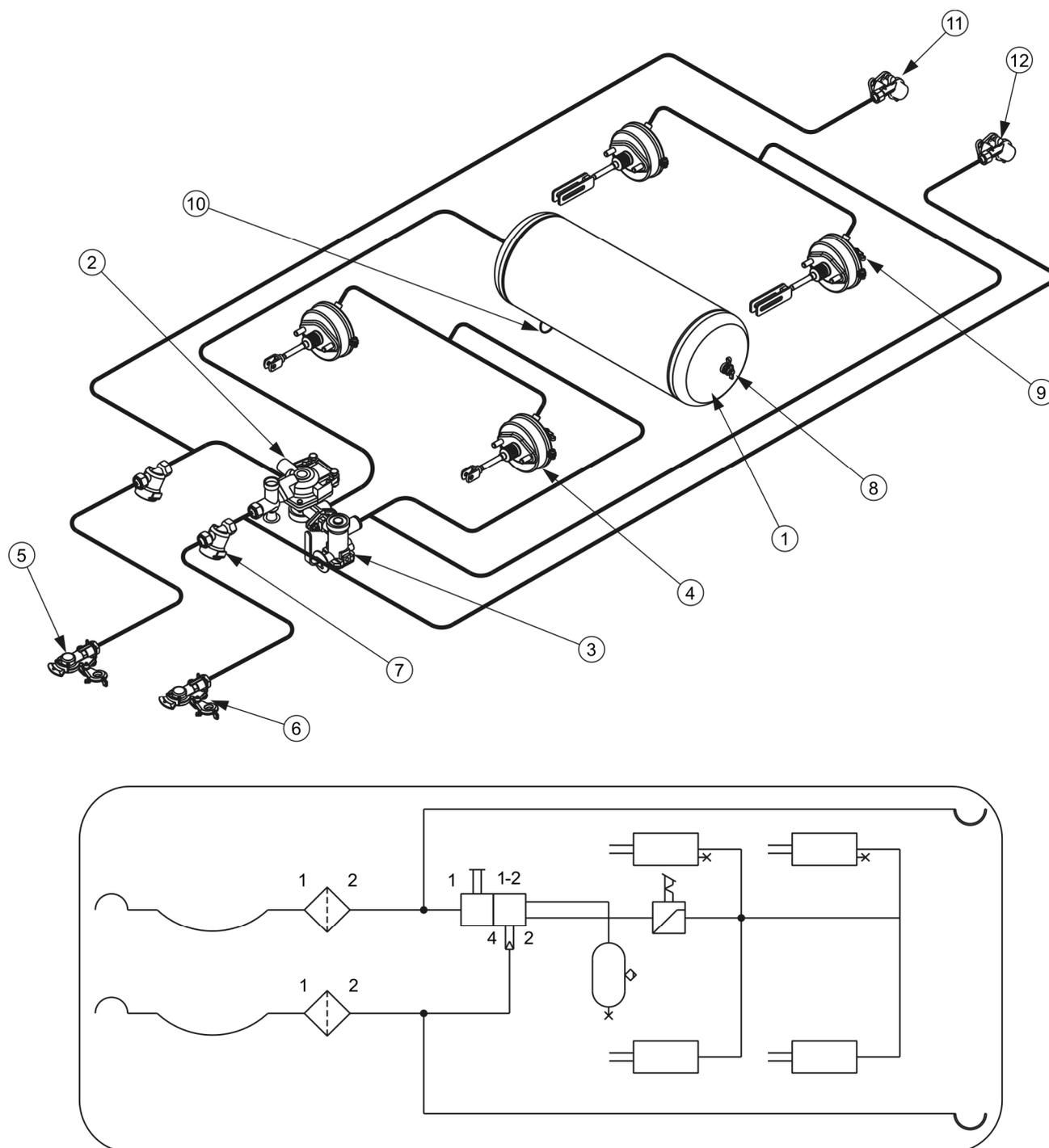
**РИСУНОК 3.5 Двухпроводная пневматическая тормозная система**
