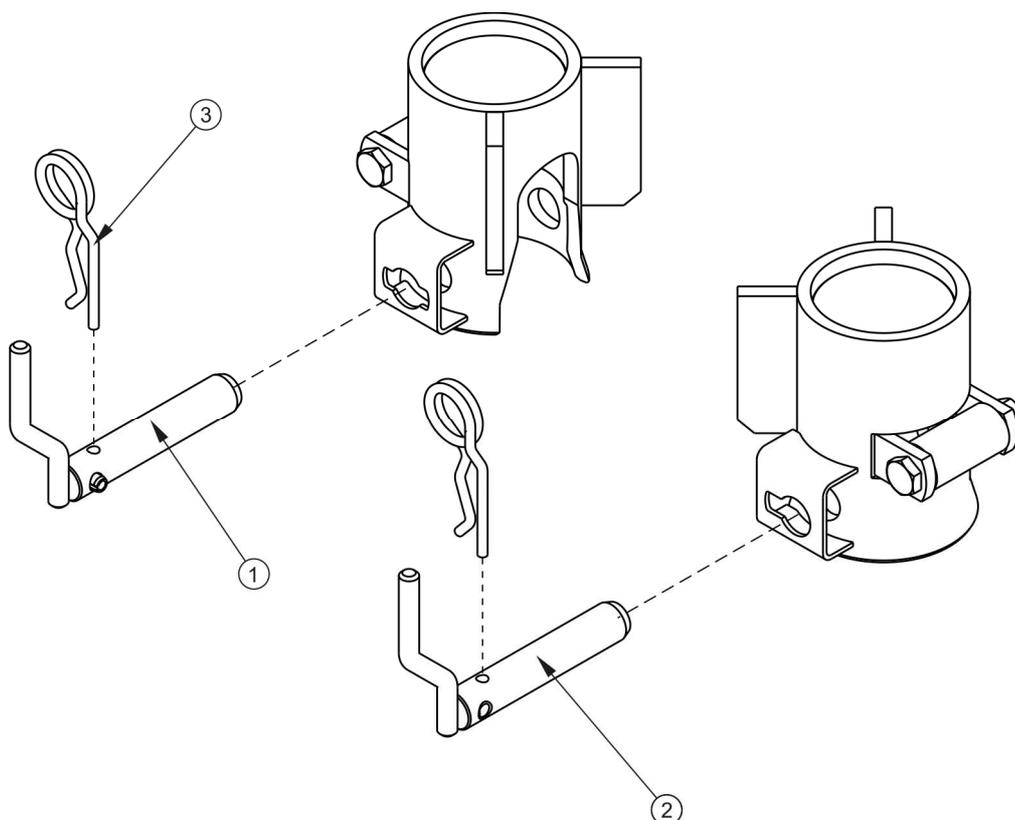
**РИСУНОК 4.4 Шарниры опрокидывающего механизма**
