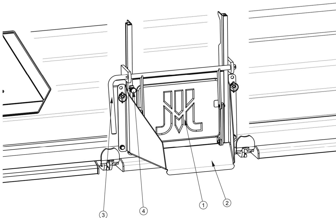
**РИСУНОК 4.6 Задний разгрузочный люк**
