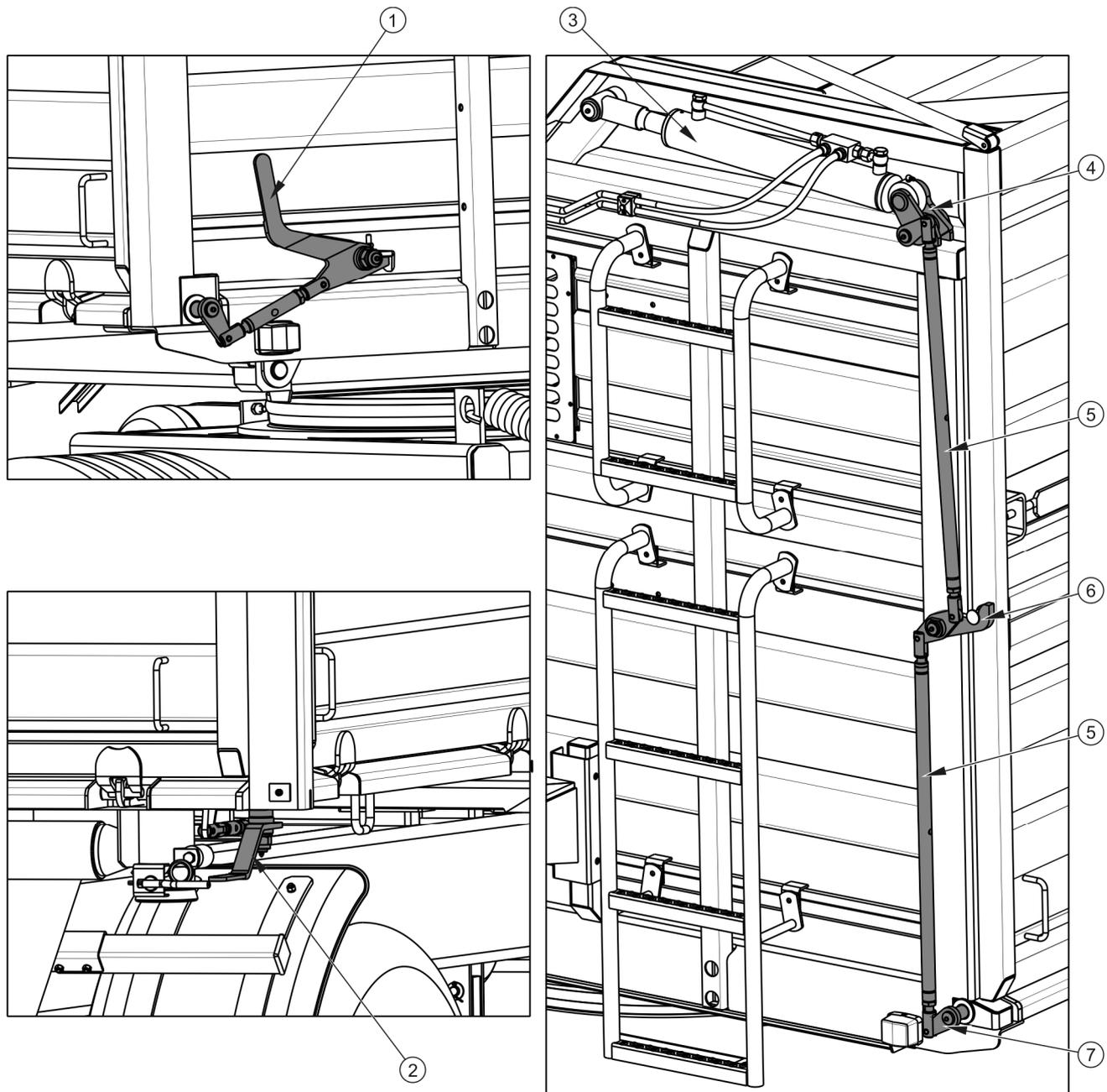
**РИСУНОК 3.11 Система центрального закрытия бортов прицепа**
