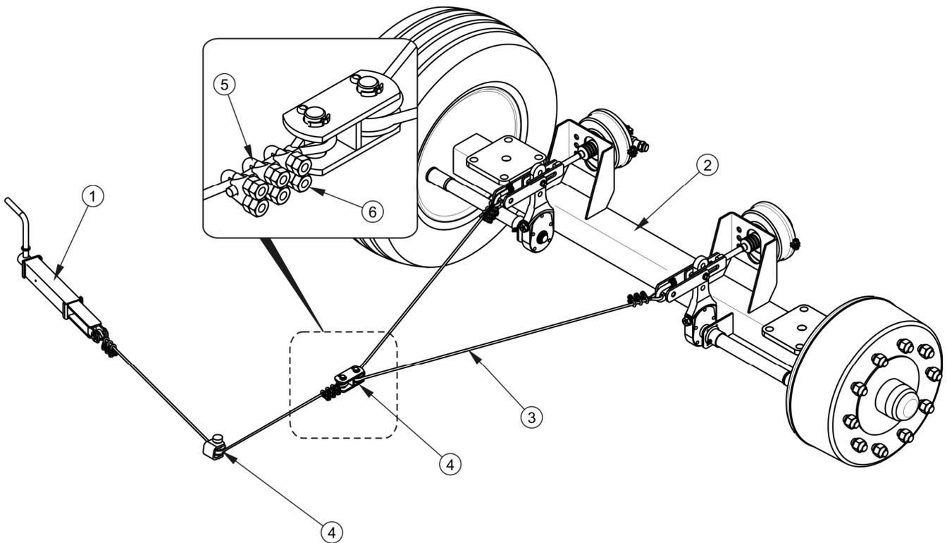
**РИСУНОК 5.5 Регулирование натяжения троса стояночного тормоза**
