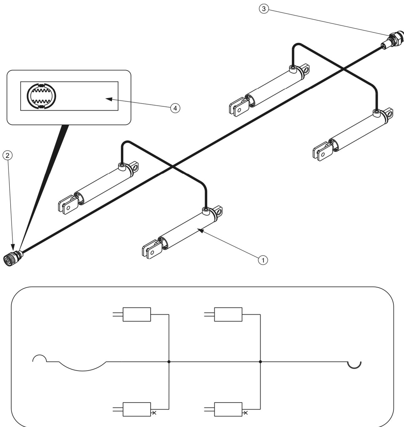
**РИСУНОК 3.7 Гидравлическая тормозная система**
