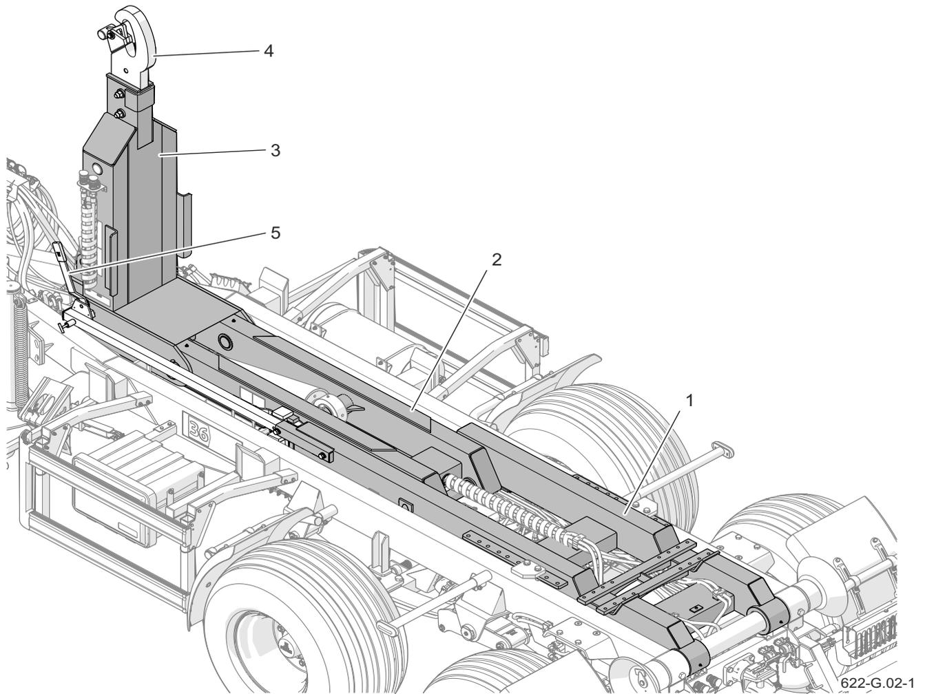
**Bild 3.2** Schwenkrahmen
