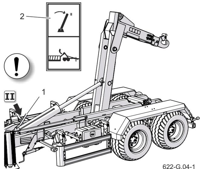
**Bild 3.5** Anheben des mittleren Rahmens
