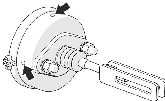
**Bild 5.6** Bremszylinder
