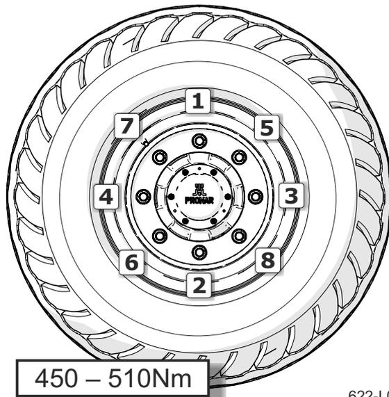
**Bild 5.15** Prinzip der Radbefestigung
