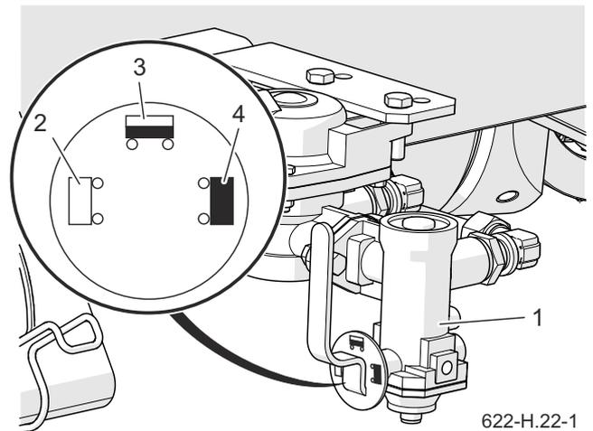
**Bild 4.22** Bremskraftregler
