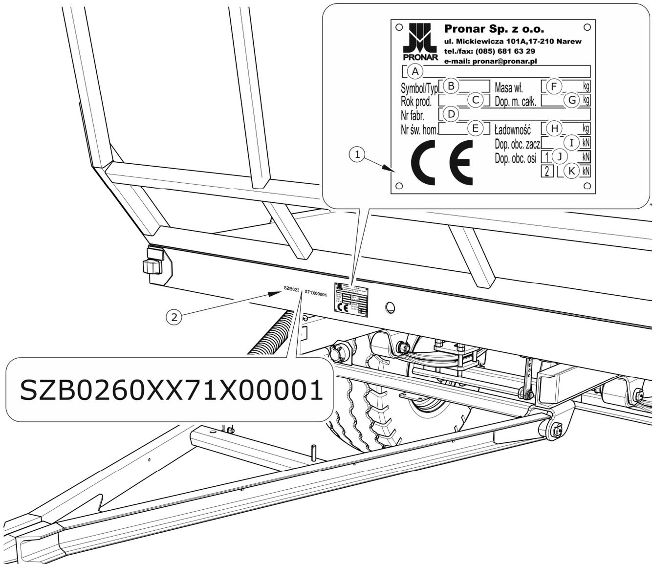
**ABBILDUNG 1.1** Lokalisierung des Typenschildes und der eingeschlagenen FIN-Nummer
