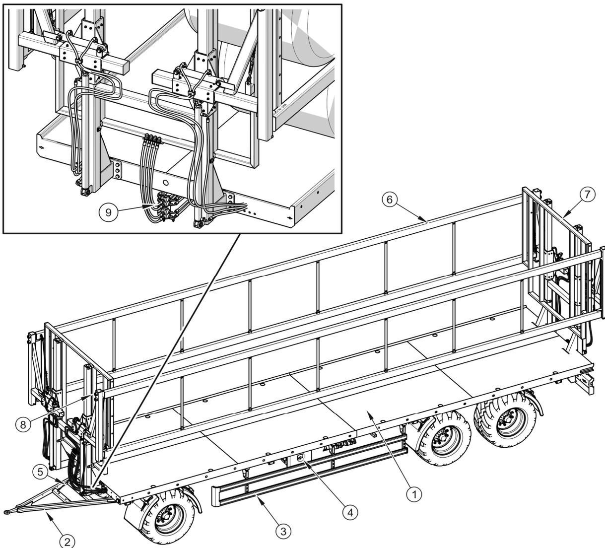
**ABBILDUNG 3.2** Aufbau des Anhängers mit hydraulischer Ladungssicherung
