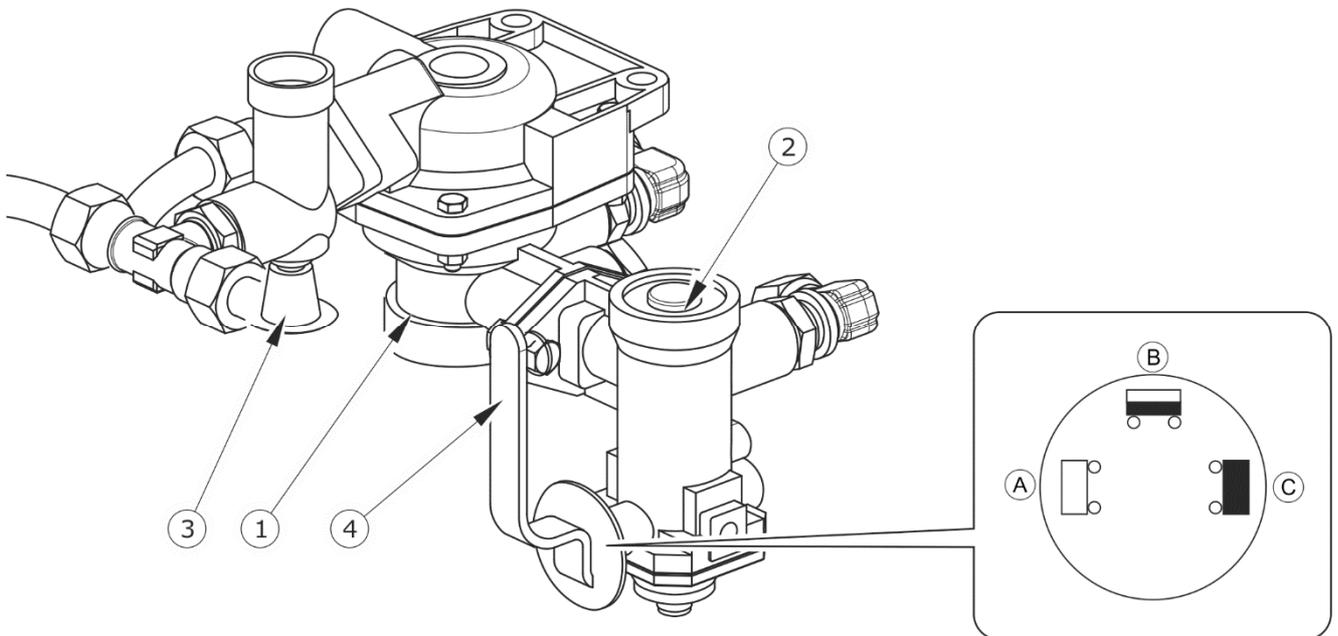
**ABBILDUNG 3.12** *Steuerventil und Bremskraftregler*
