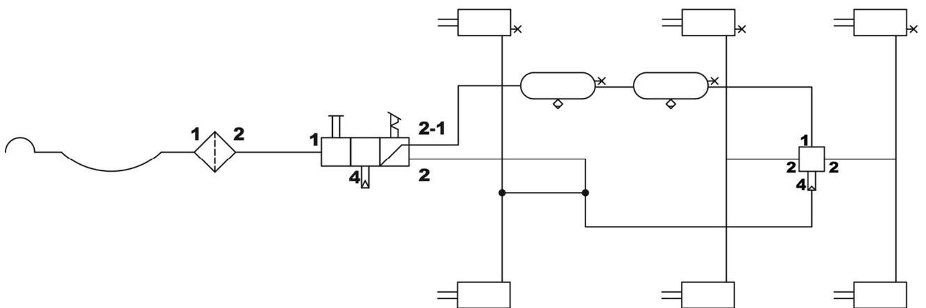
**ABBILDUNG 3.6** Schema der Einkreis-Bremsanlage mit manuellem Bremskraftregler
