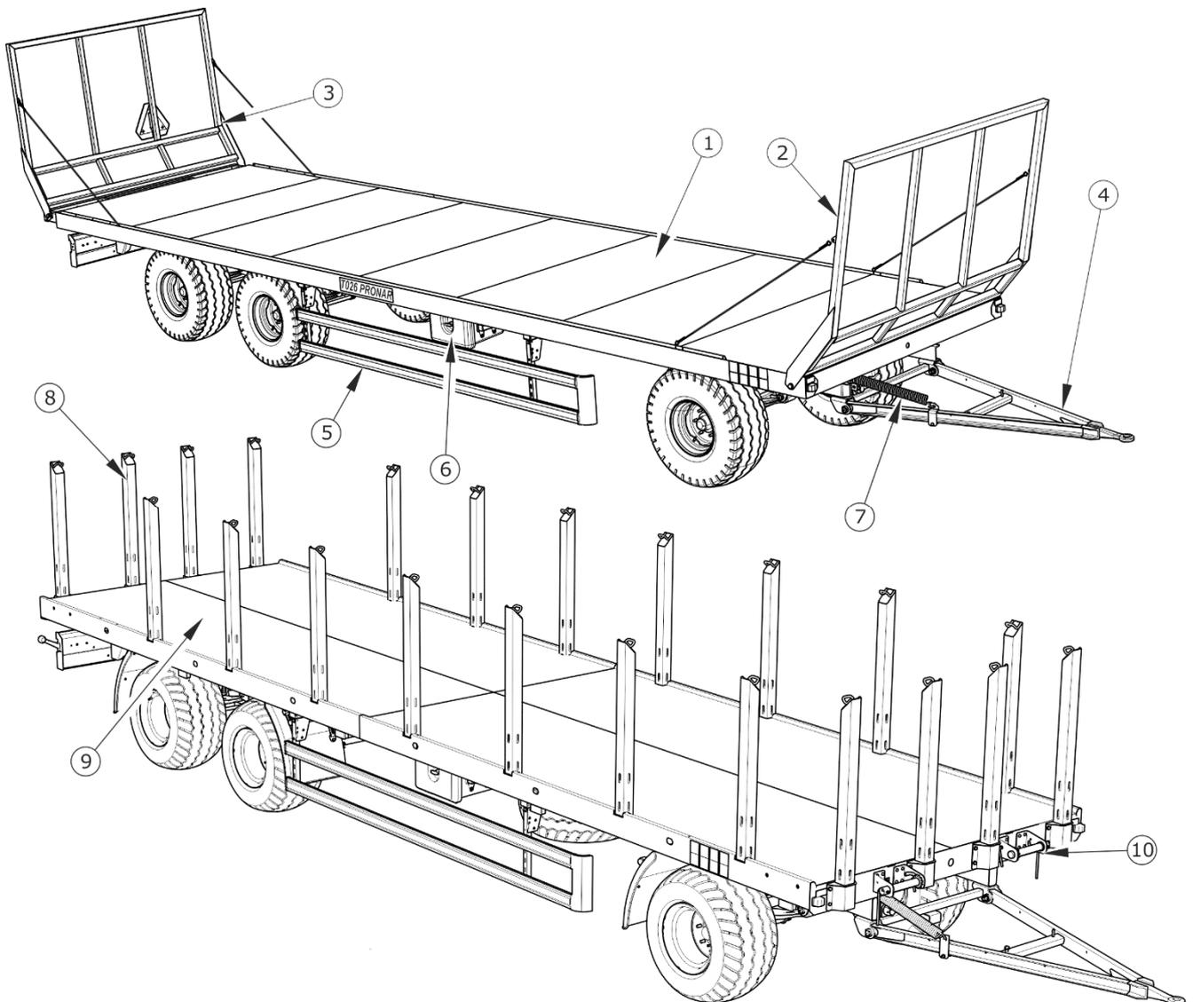
**ABBILDUNG 3.1** Aufbau des Anhängers
