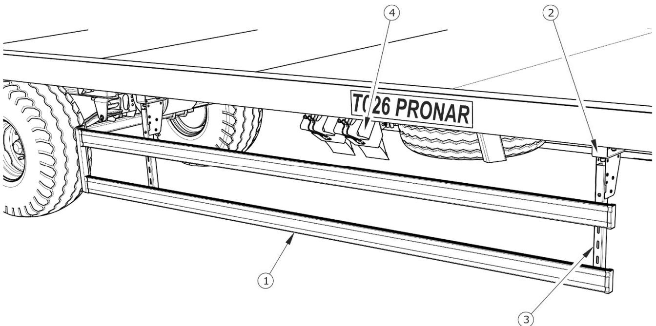
**ABBILDUNG 3.3** *Seitlicher Auffahrschutz*
