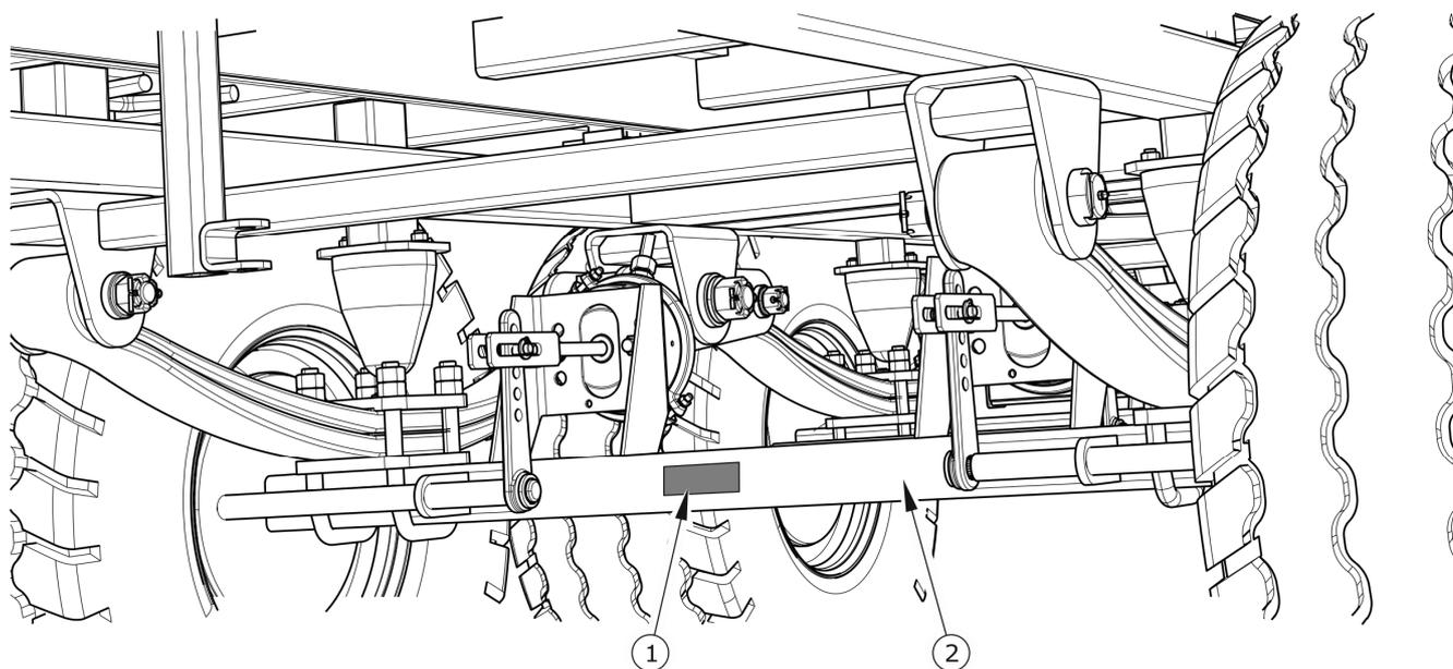
**ABBILDUNG 1.2** Lokalisierung des Typenschildes an der Fahrachse
