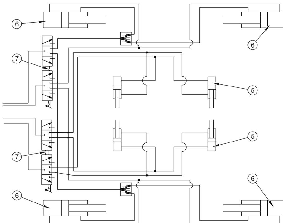
**ABBILDUNG 3.7** Schema der hydraulischen Installation zum Heben von Wänden
