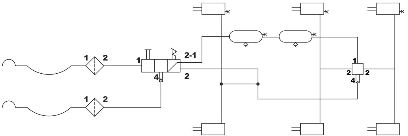
**ABBILDUNG 3.4** Schema der Zweikreis-Bremsanlage mit manuellem Bremskraftregler
