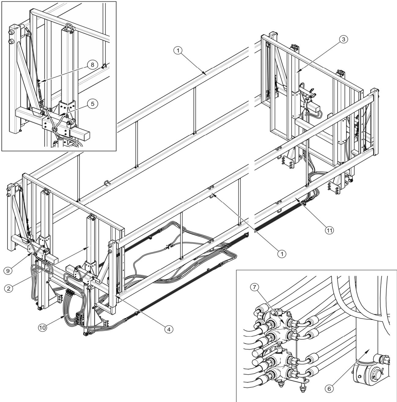
**ABBILDUNG 3.6** Aufbau des hydraulischen Wandhebesystems
