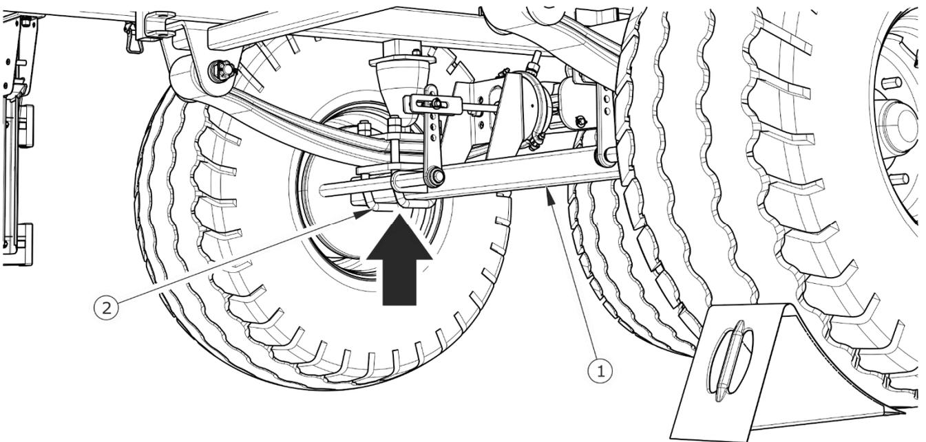
**ABBILDUNG 5.1** Ansetzpunkt für den Fahrzeugheber
