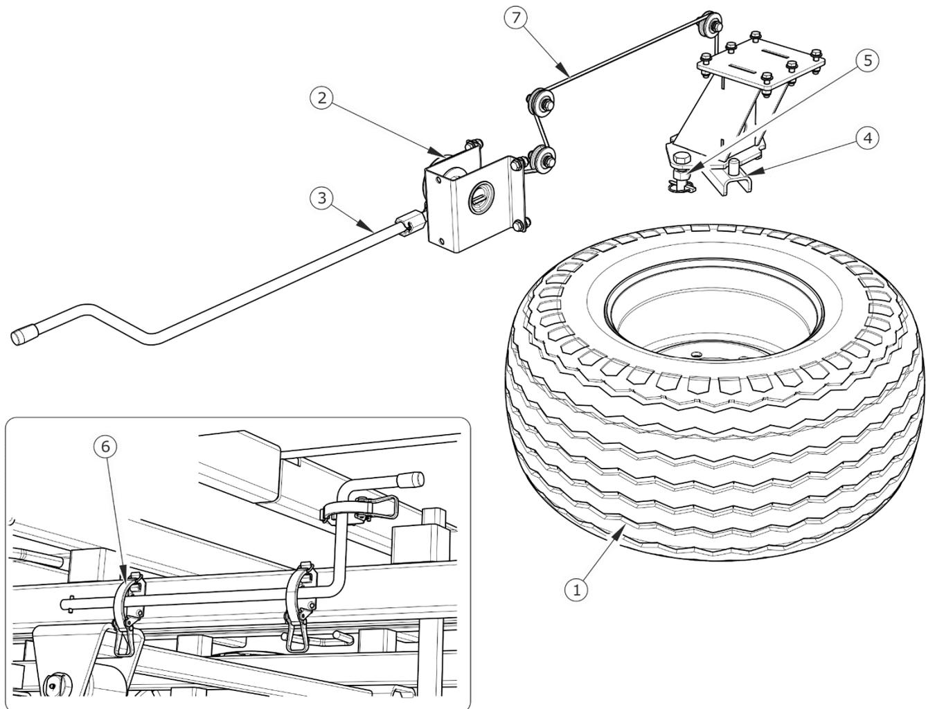
**ABBILDUNG 3.15** Aufbau der Ersatzradwinde
