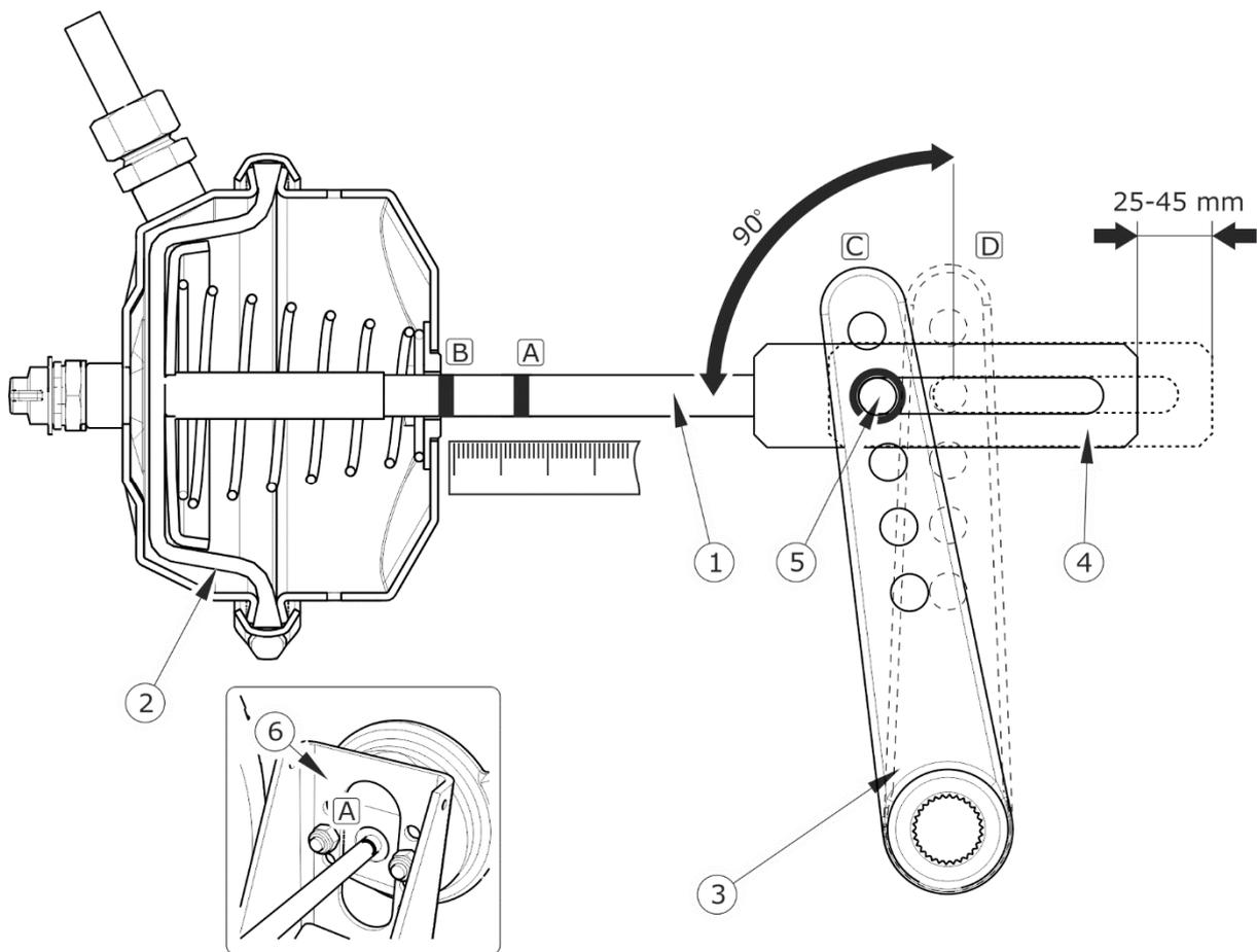
**ABBILDUNG 5.8** Regeln bei der Einstellung der Bremse
