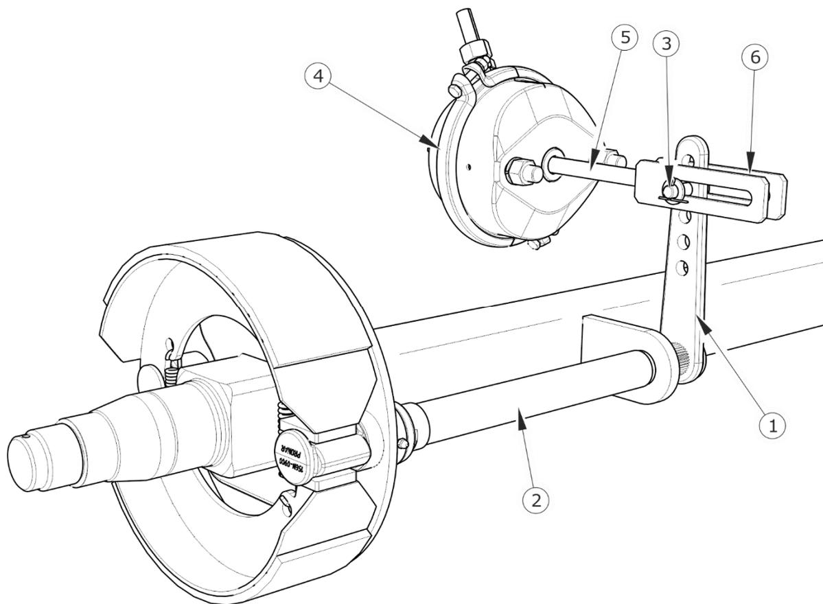
**ABBILDUNG 5.7** Aufbau der Bremse an der Fahrachse
