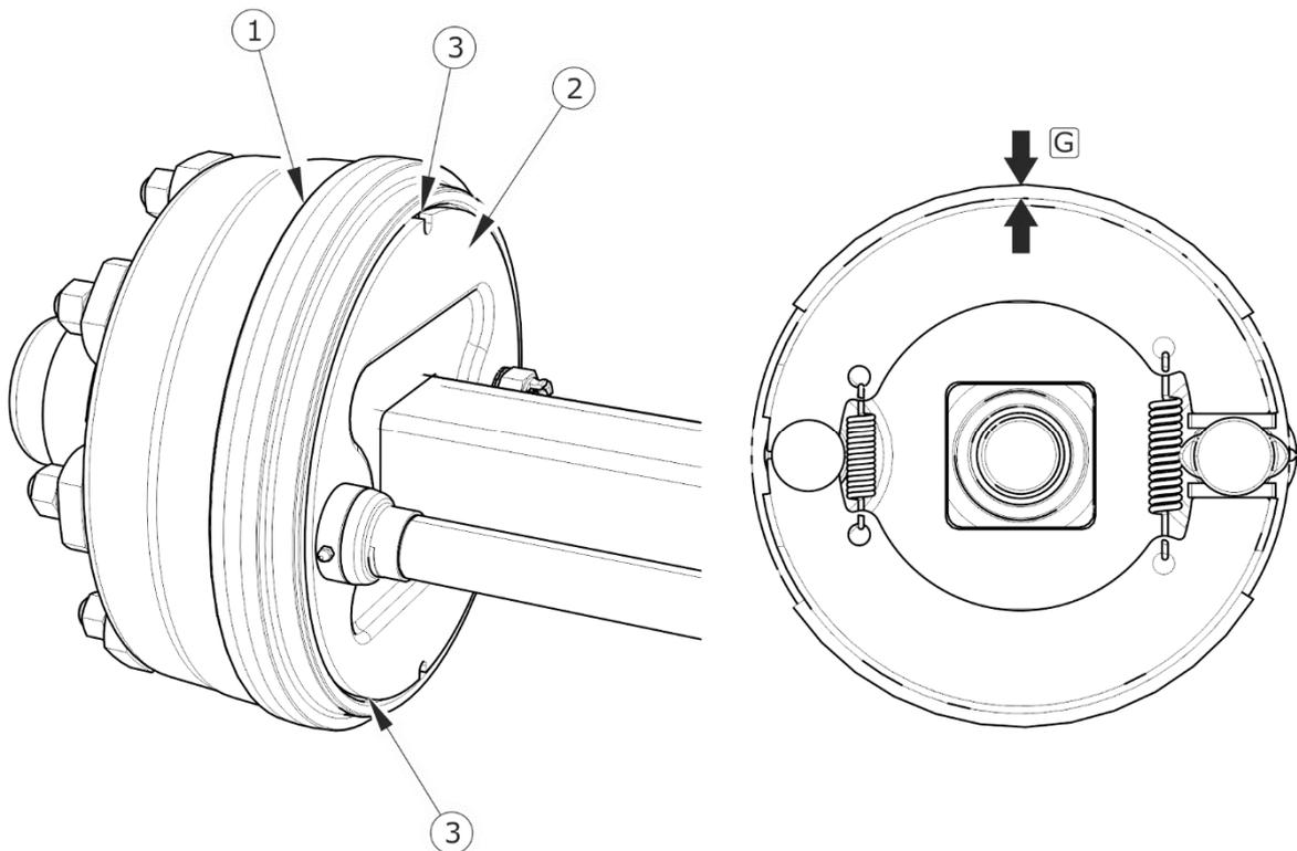
**ABBILDUNG 5.6** Kontrolle der Bremsbeläge
