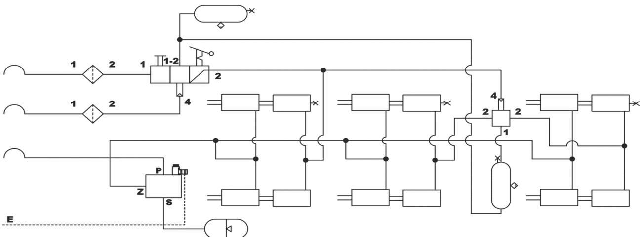
**ABBILDUNG 3.9** Schaltbild der pneumatisch-hydraulischen Installation mit elektronischer Sicherung
