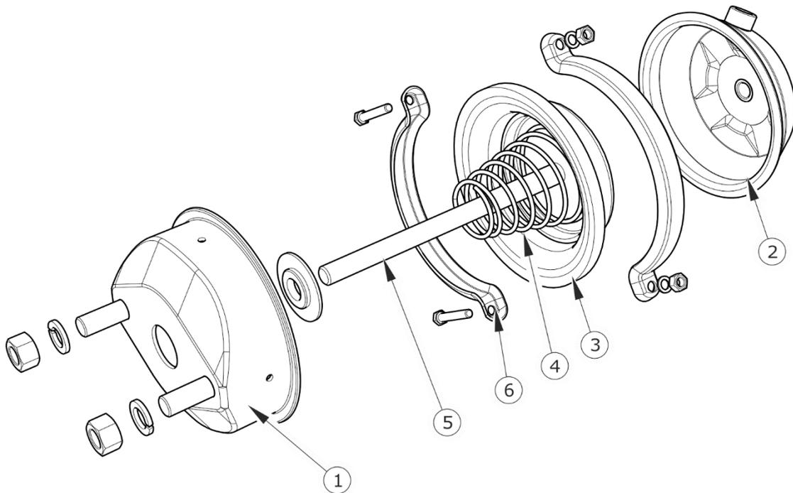
**ABBILDUNG 3.11** Aufbau des Druckluftzylinders
