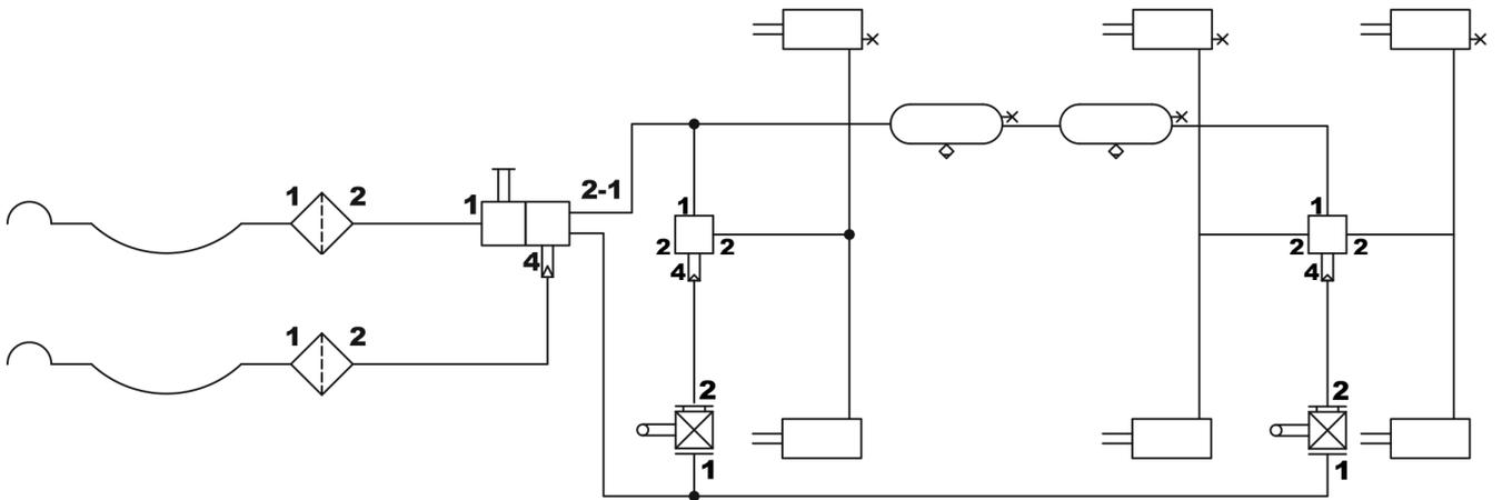
**ABBILDUNG 3.5** Schema der Zweikreis-Bremsanlage mit automatischem Bremskraftregler
