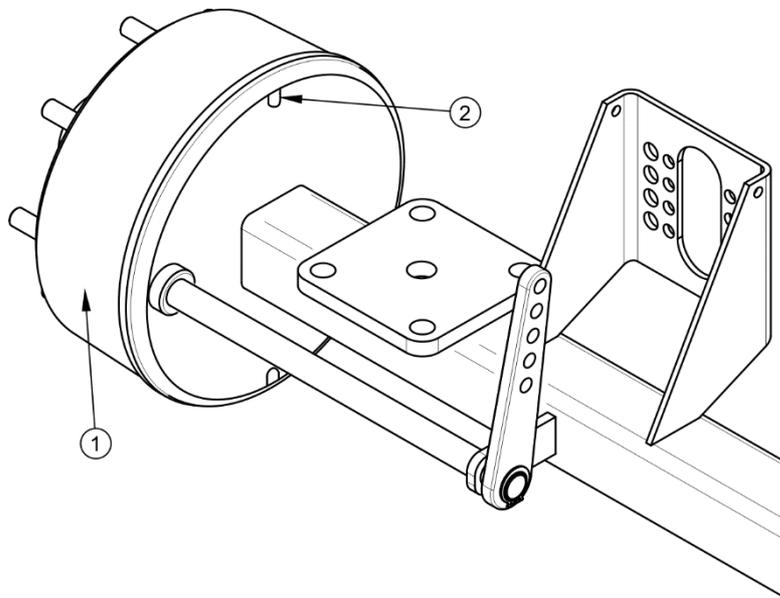
**ABBILDUNG 5.1 Kontrolle der Bremsbeläge**
