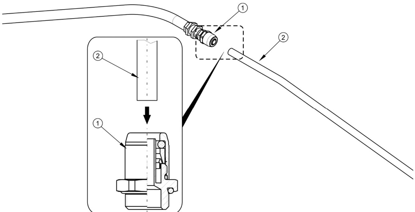
**ABBILDUNG 5.8 Anschluss der Druckluftleitung**
