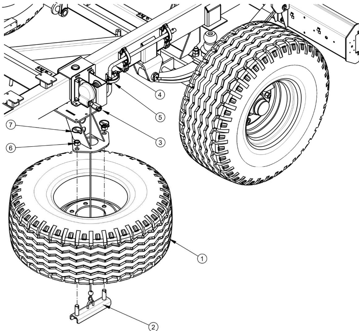
**ABBILDUNG 5.15 Befestigung des Ersatzrades unter dem Rahmen**
