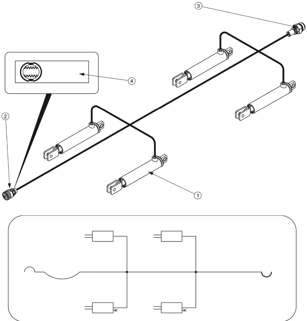
**ABBILDUNG 3.7** Aufbau und Schema der Hydraulikbremse
