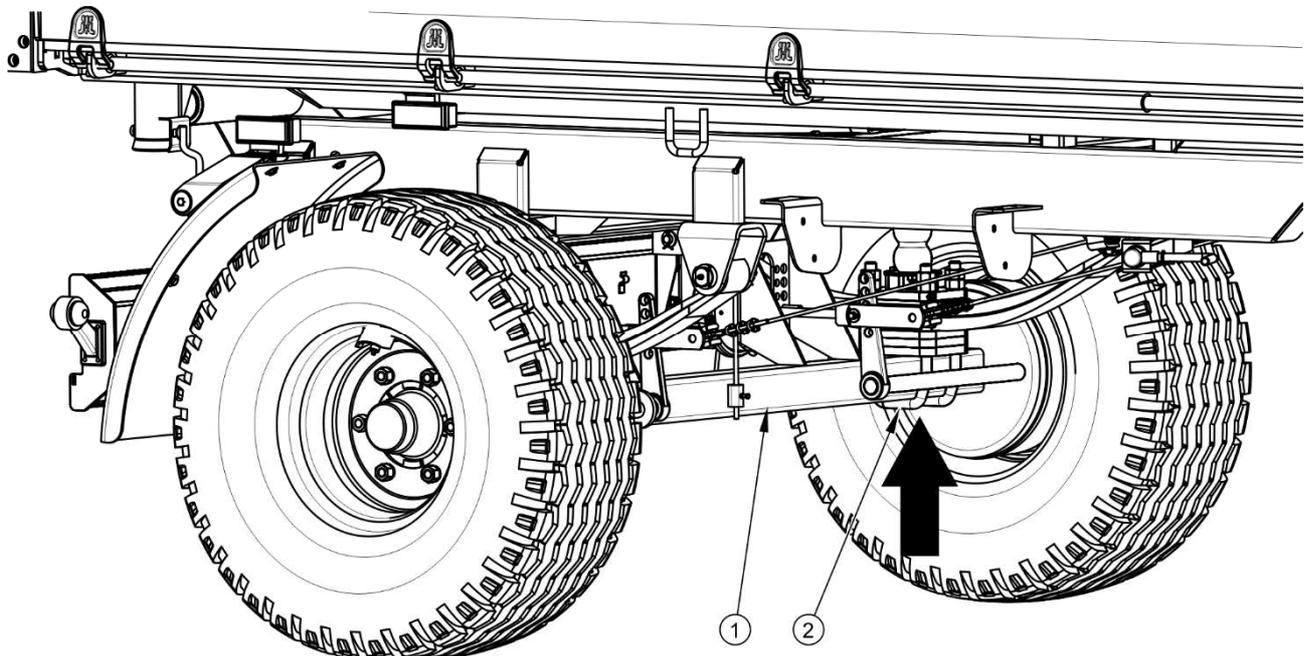
**ABBILDUNG 5.2** Ansetzpunkt für den Fahrzeugheber
