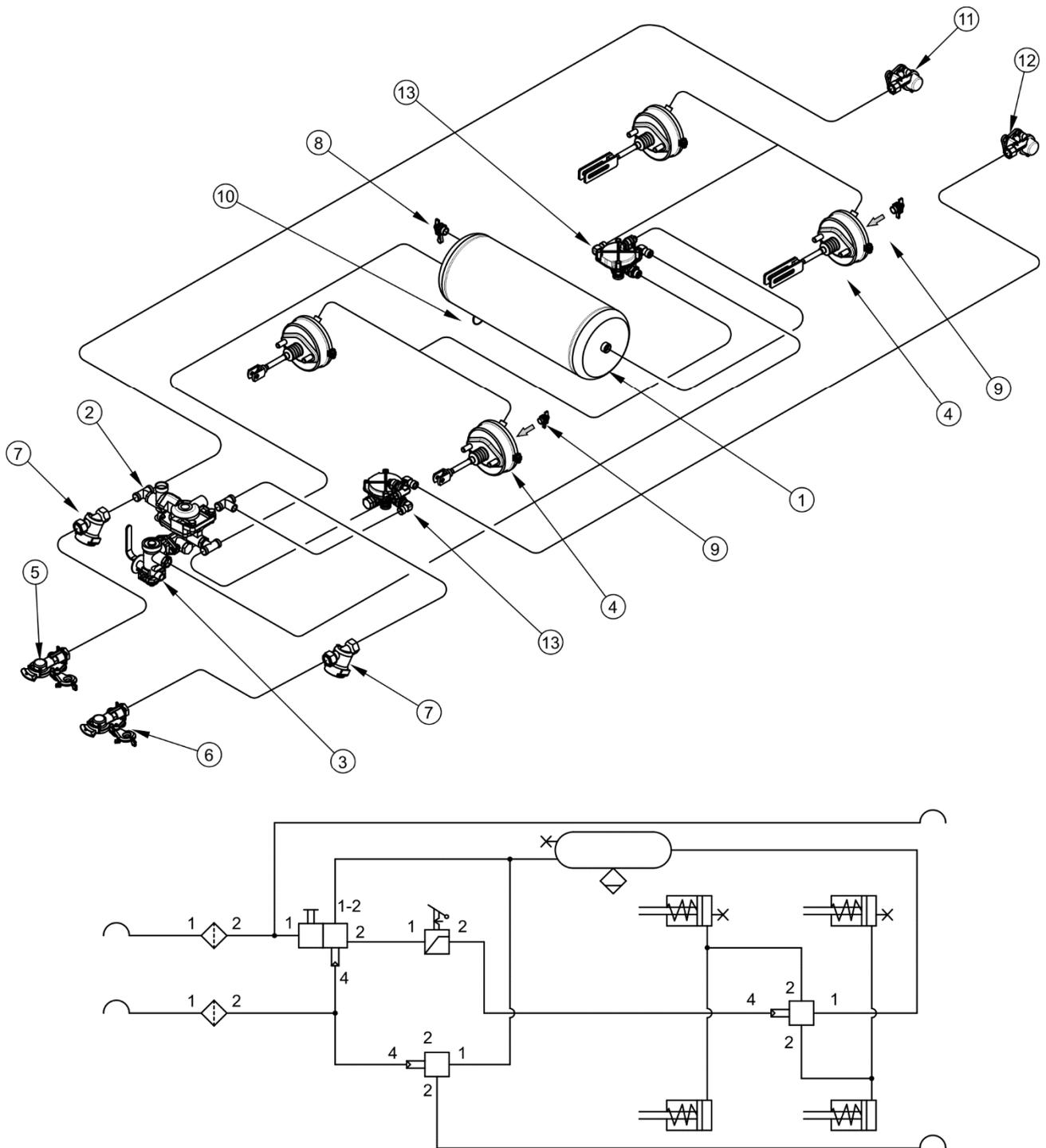
**ABBILDUNG 3.5 Aufbau und Schema der Zweikreis-Druckluftbremse**
