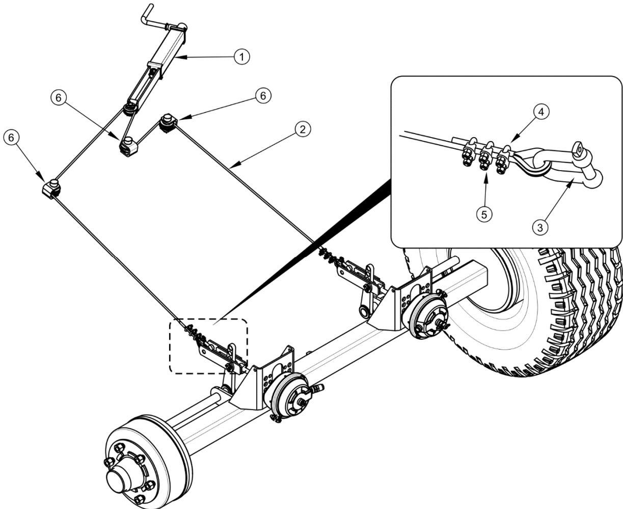
**ABBILDUNG 5.6** Einstellung der Bremsseilspannung der Feststellbremse
