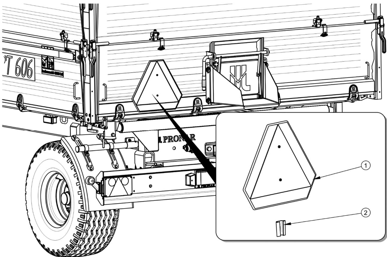
**ABBILDUNG 2.2 Befestigungsstelle der Kennzeichnungstafel für bauartbedingt langsam fahrende Fahrzeuge**
