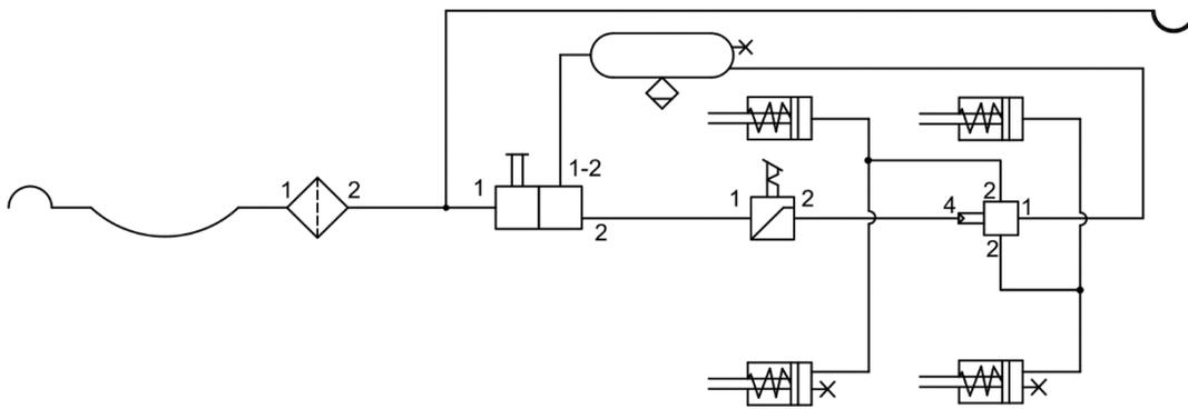
**ABBILDUNG 3.6 Aufbau und Schema der Einkreis-Druckluftbremse**
