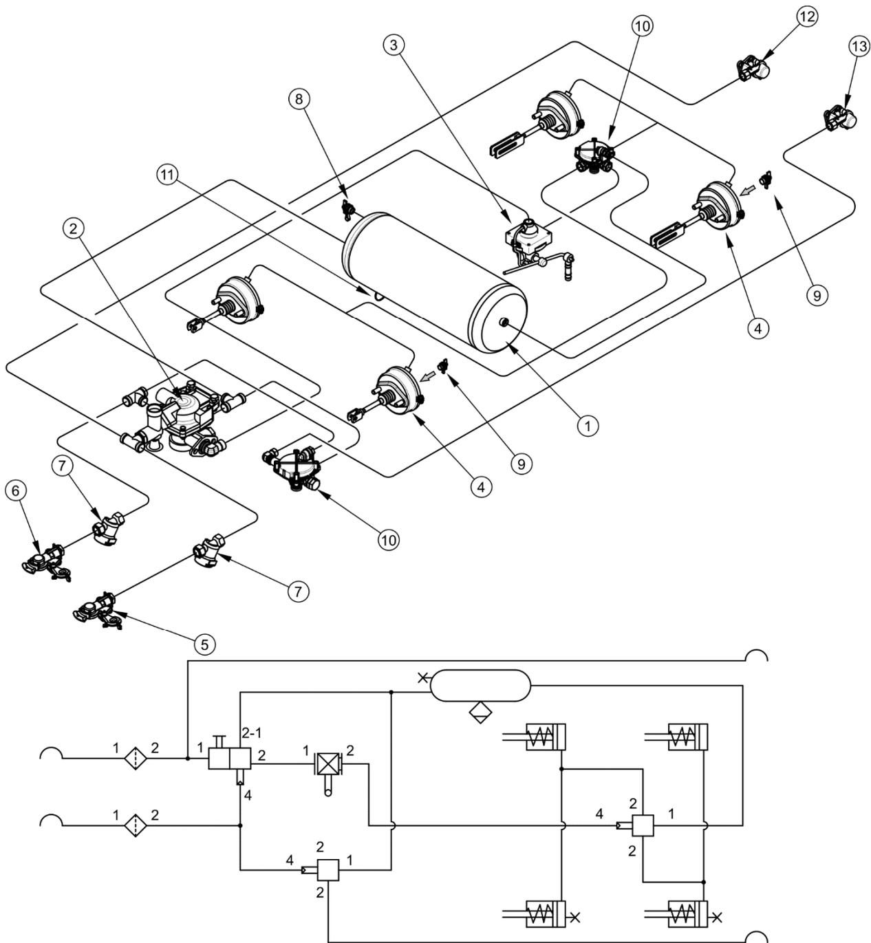
**ABBILDUNG 3.4 Aufbau und Schema der Zweikreis-Druckluftbremse mit automatischem Bremskraftregler**
