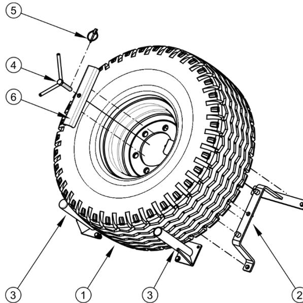
**ABBILDUNG 5.14 Befestigung des Ersatzrades an der Vorderwand**
