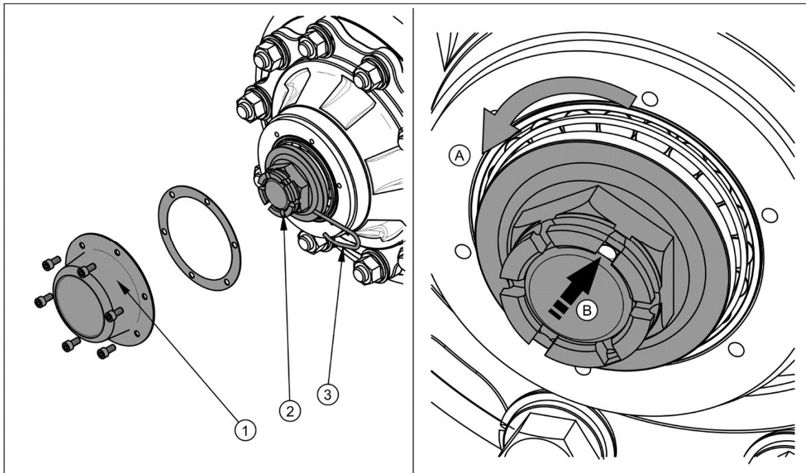
**ABBILDUNG 5.3 Einstellen des Lagers an der Fahrachse**
