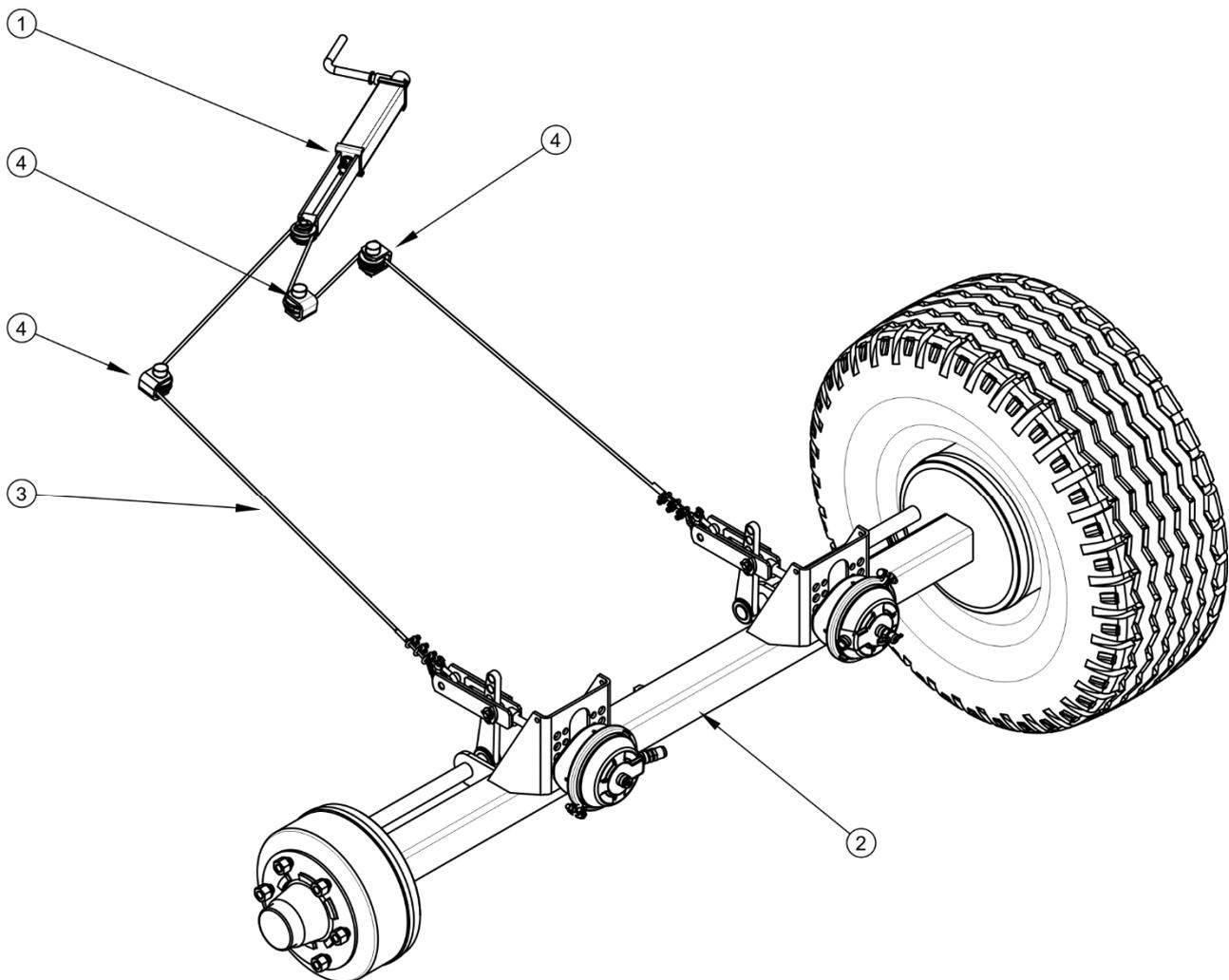
**ABBILDUNG 3.11** Aufbau der Feststellbremse
