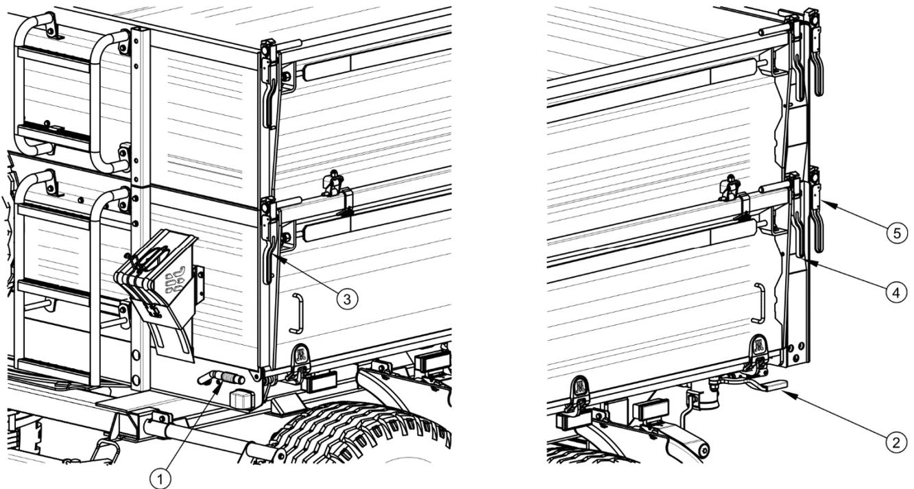
**ABBILDUNG 4.4 Öffnen der Wände**
