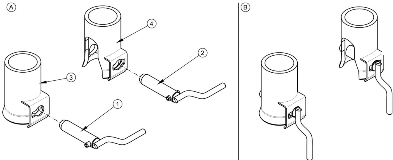
**ABBILDUNG 4.3 Verriegelung der Kippbolzen**
