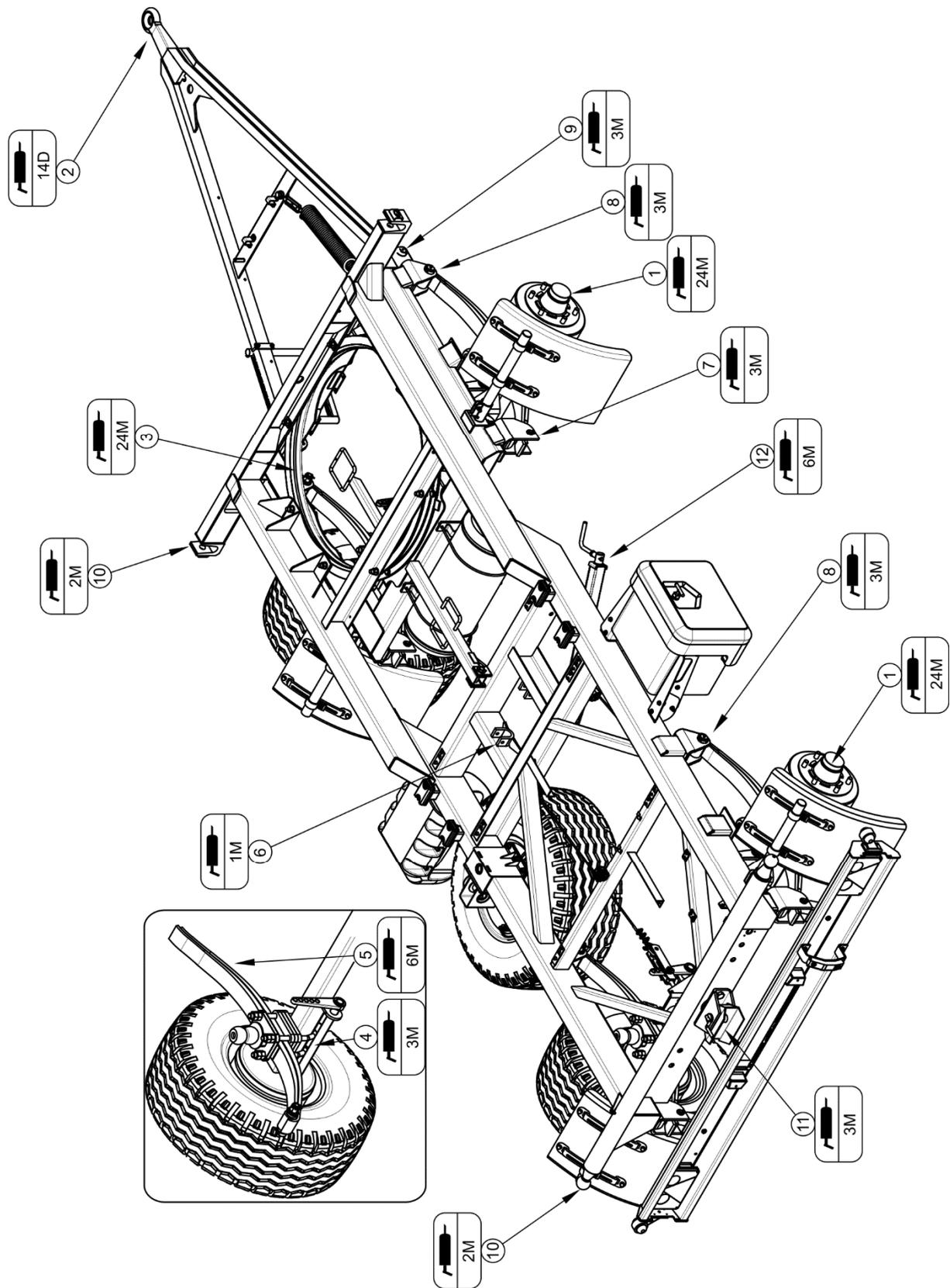
ABBILDUNG 5.11 Schmierpunkte des Fahrgestells
