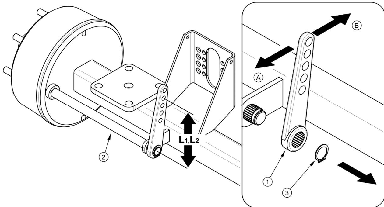
**ABBILDUNG 5.5 Einstellen der mechanischen Bremsen an den Fahrachsen**
