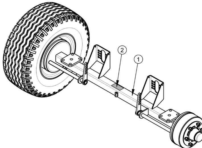
**ABBILDUNG 1.2** Lokalisierung des Typenschildes an der Fahrachse
