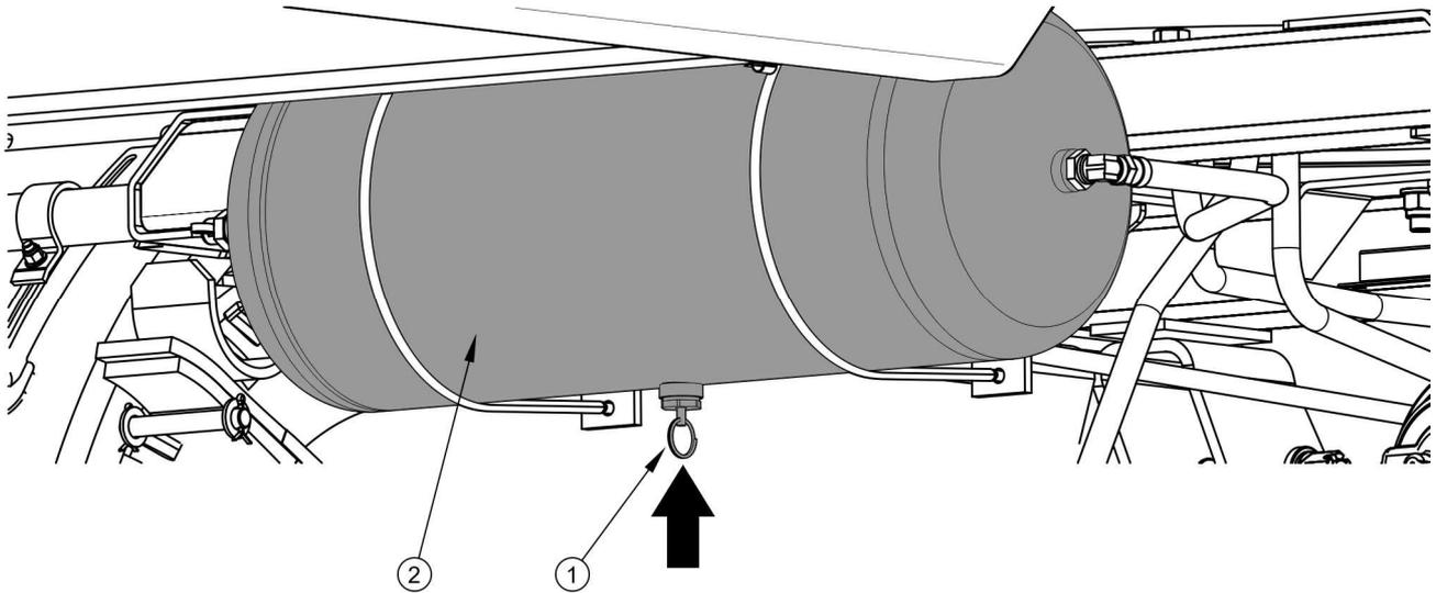
**ABBILDUNG 5.10 Entwässerung des Druckluftbehälters**
