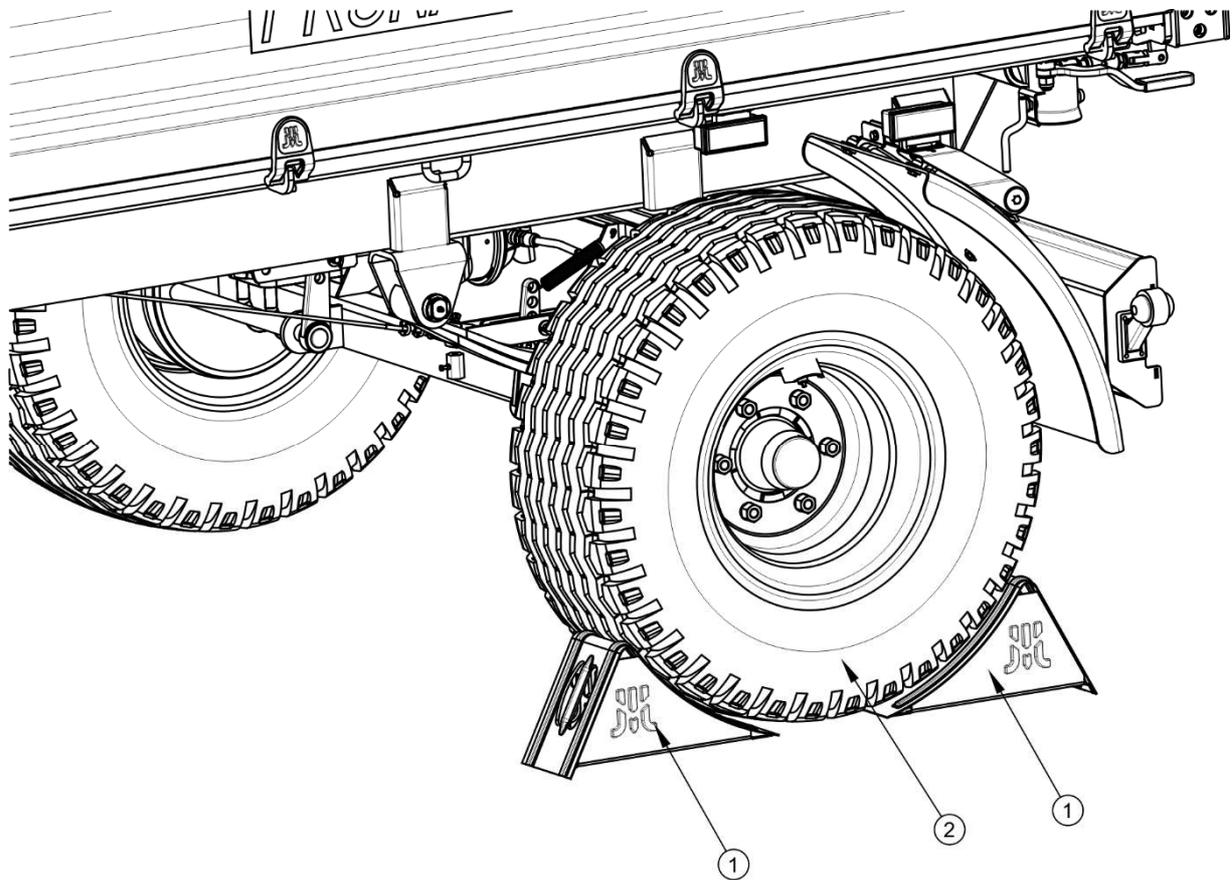
**ABBILDUNG 2.1** Unterlegen der Keile
