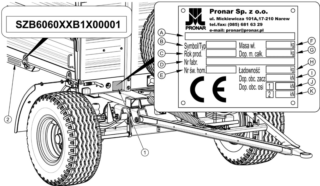
**ABBILDUNG 1.1** Lokalisierung des Typenschilds und der eingeschlagenen Seriennummer
