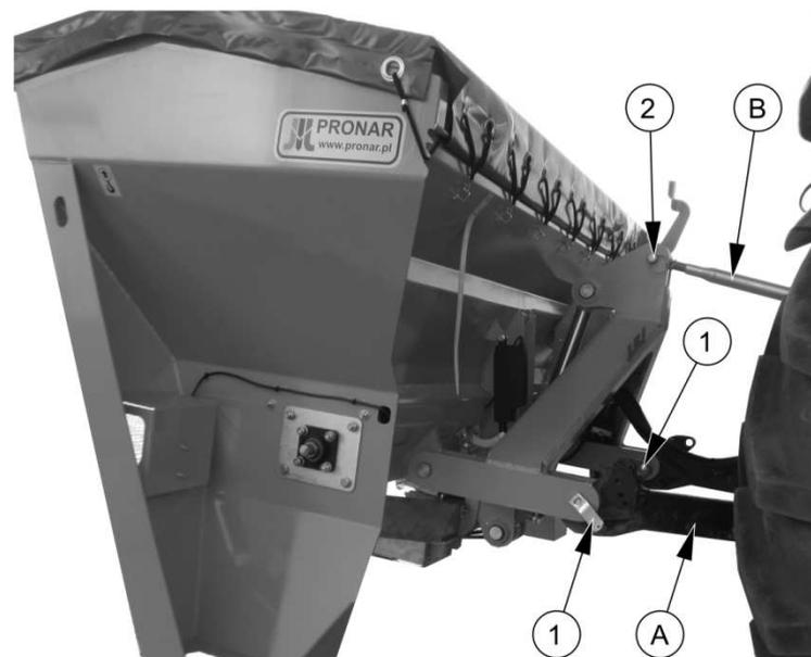
**Abb. 4.1** Ankuppeln an den Schlepper
