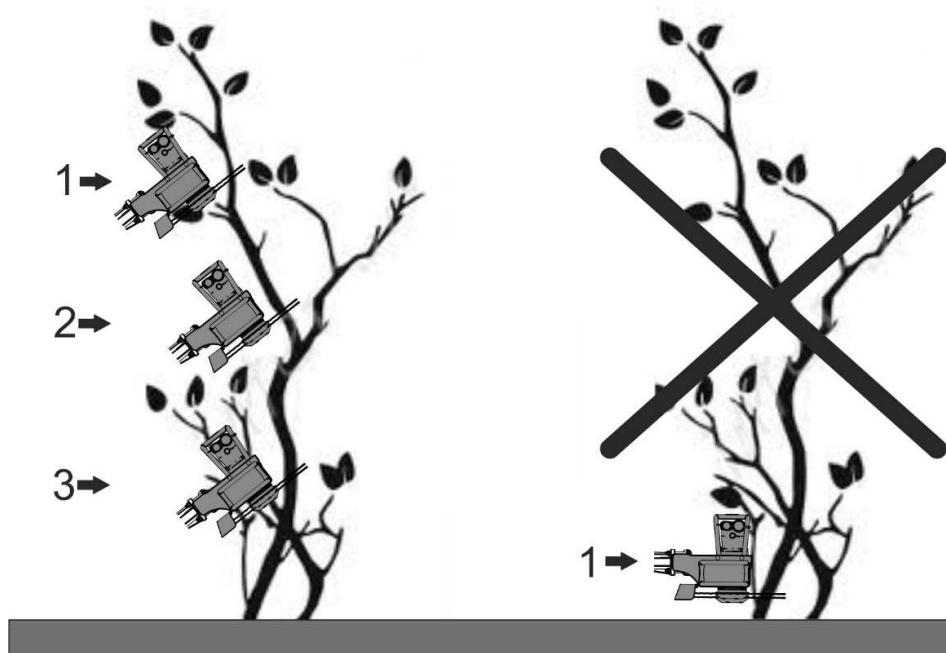
РИСУНОК 4.4 Положение пилы и последовательность обрезания пилой для ветвей.
