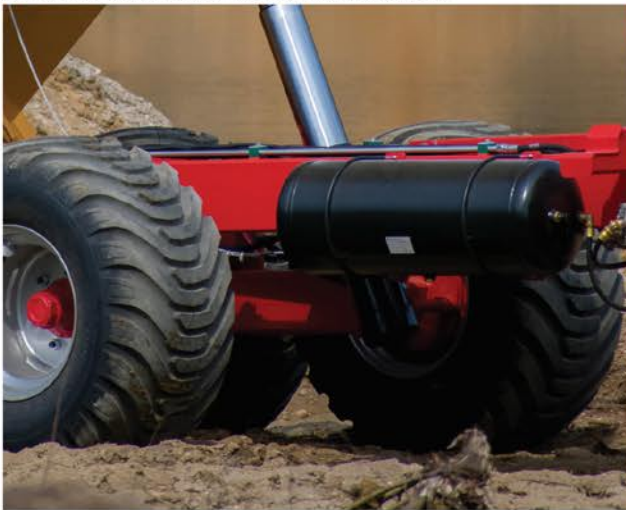
Zawieszenie tandem z wahaczami podłużnymi (duży zakres pracy)
