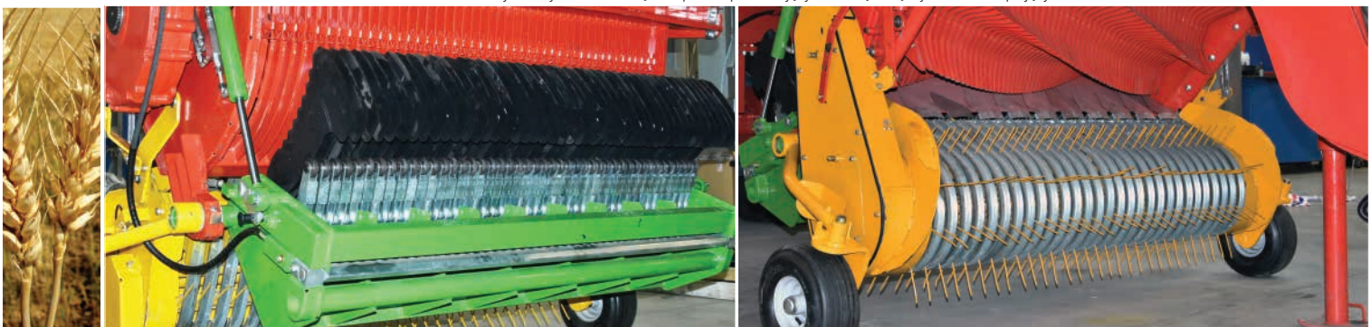
Podbieracz krzywkowy z osmioma rzędami palców podbierających z rolką i skrętnymi kołami kopiującymi
