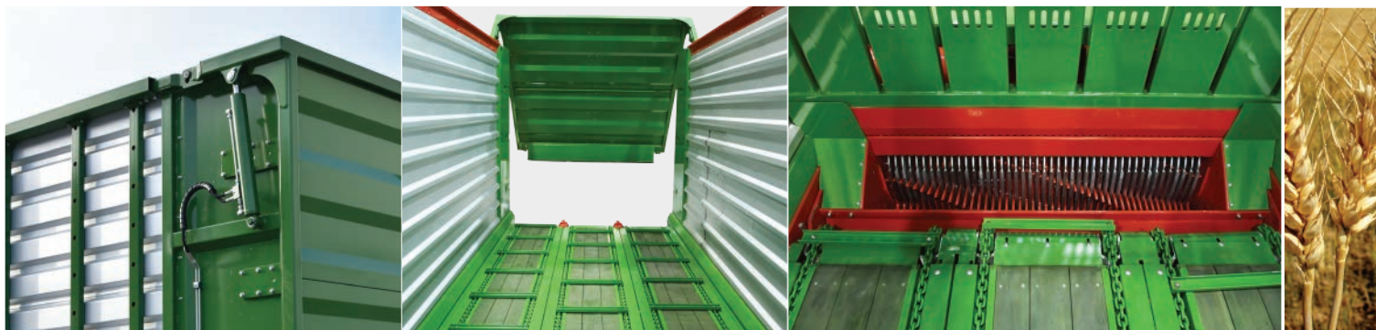
Ściana tylna podnoszona hydraulicznie, skrzynia przystosowana do montażu walców dozujących z napędem
