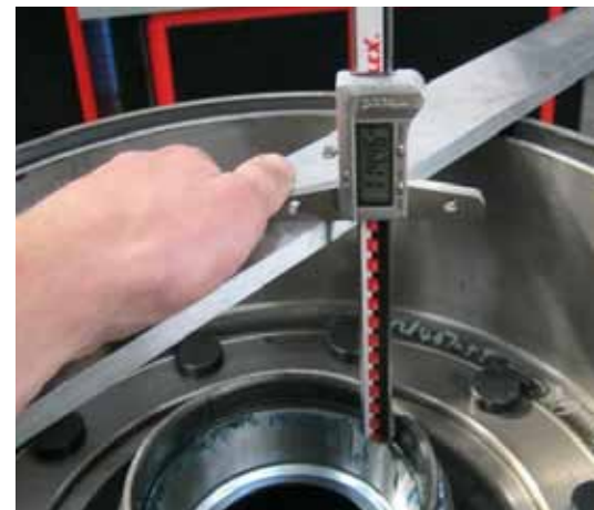
Przykładowe pomiary kontroli piasto-bębna. Na dole: pomiar przy użyciu wysokościomierza odległości od końca bębna do początku piasty ( 181 \pm 1 mm); u góry: pomiar głębokościomierzem posadowienia bieżni pod łożysko ( 114 \pm 1 mm)
