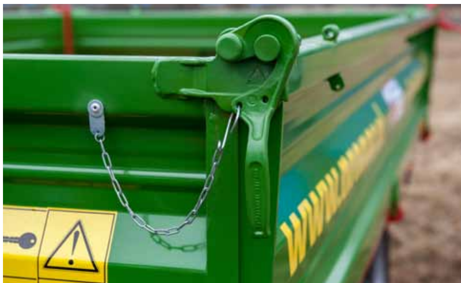
... oraz centralne ryglowanie ścian (tył, lewa, prawa)
