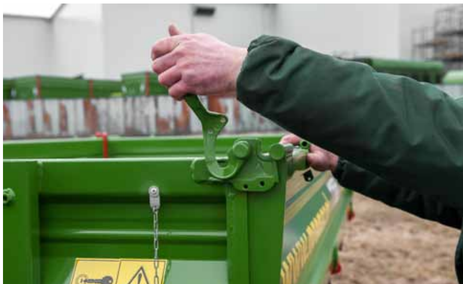
... oraz centralne ryglowanie ścian (tył, lewa, prawa)
