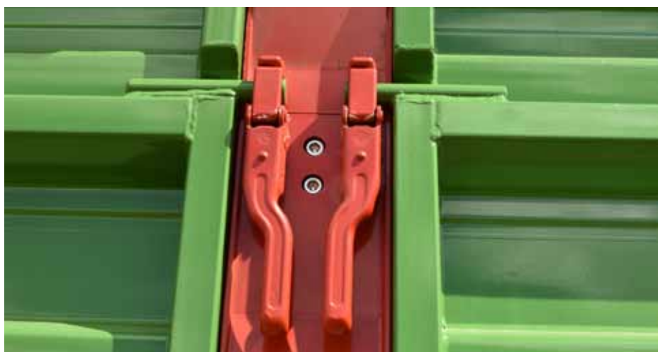
Solidne markowe zamki ścian bazujące na odkuwanych częściach
