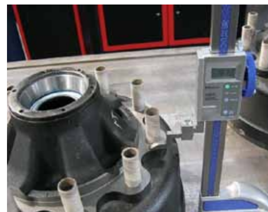
Przykładowe pomiary kontroli piasto-bębna. Na dole: pomiar przy użyciu wysokościomierza odległości od końca bębna do początku piasty ( 181 \pm 1 mm); u góry: pomiar głębokościomierzem posadowienia bieżni pod łożysko ( 114 \pm 1 mm)
