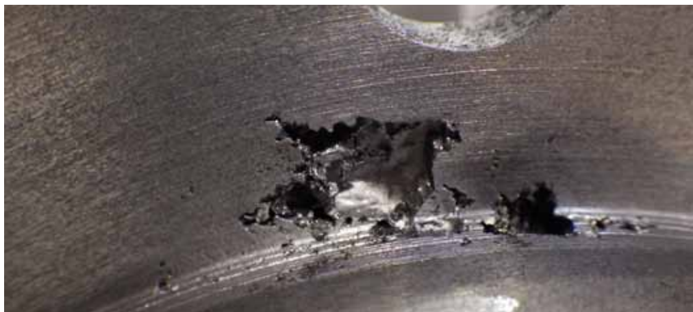
Niezgodność wykryta podczas badań RT po obróbce skrawania
