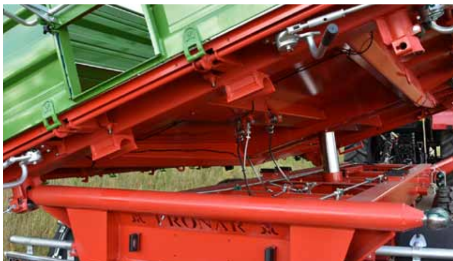
System wywrotu trzystronnego z przegubami kulowymi tylnymi amortyzowanymi
