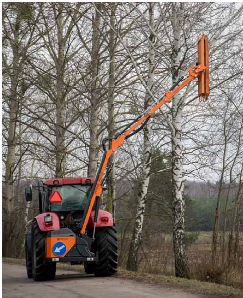
Dzięki regulowanemu przez siłowniki hydrauliczne ramieniu, dowolne zainstalowane na nim narzędzie robocze może działać pod różnym kątem, na różnych wysokościach i w trudno dostępnych miejscach
