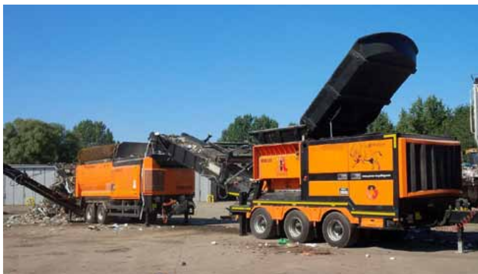
Rozdrabniacz PRONAR MRW 2.85 i Przesiewacz PRONAR MPB 18.47
