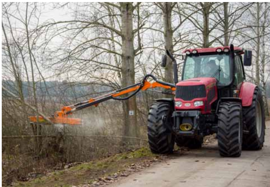
Dzięki regulowanemu przez siłowniki hydrauliczne ramieniu, dowolne zainstalowane na nim narzędzie robocze może działać pod różnym kątem, na różnych wysokościach i w trudno dostępnych miejscach
