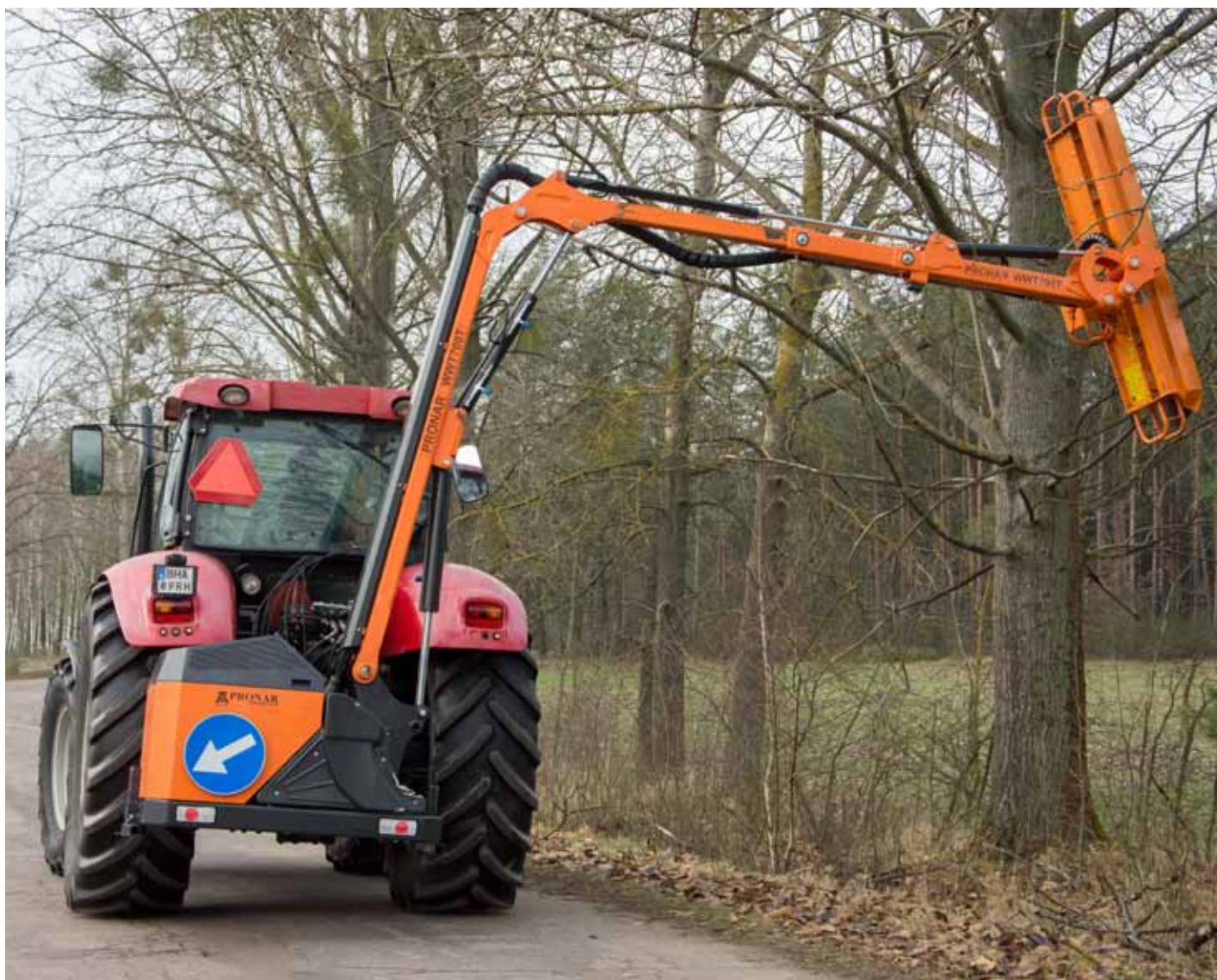
Wsięgnik PRONAR WWT700T z głowicą GP200
