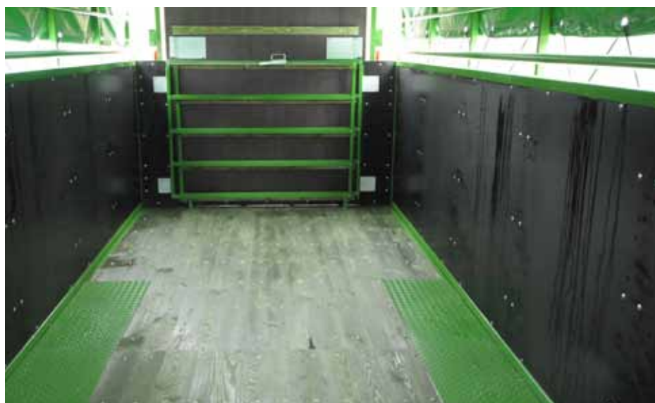
PRONAR T046/1 - podłoga wykonana jest z impregnowanego drewna, jako wyposażenie opcjonalne możliwy jest montaż podłoża metalowego z blachy ryflowanej lub antypoślizgowej, elastycznej bitumicznej wylewki z naturalnego kauczuku
