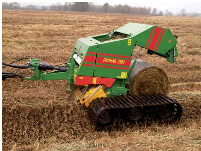
Фотография: Сворачиваемые рулоны имеют размеры 1200x1200 мм, при этом пресс собирает не обычную траву, а тростник, камыш, осоку и другие растения, произрастающие в болотистой местности
