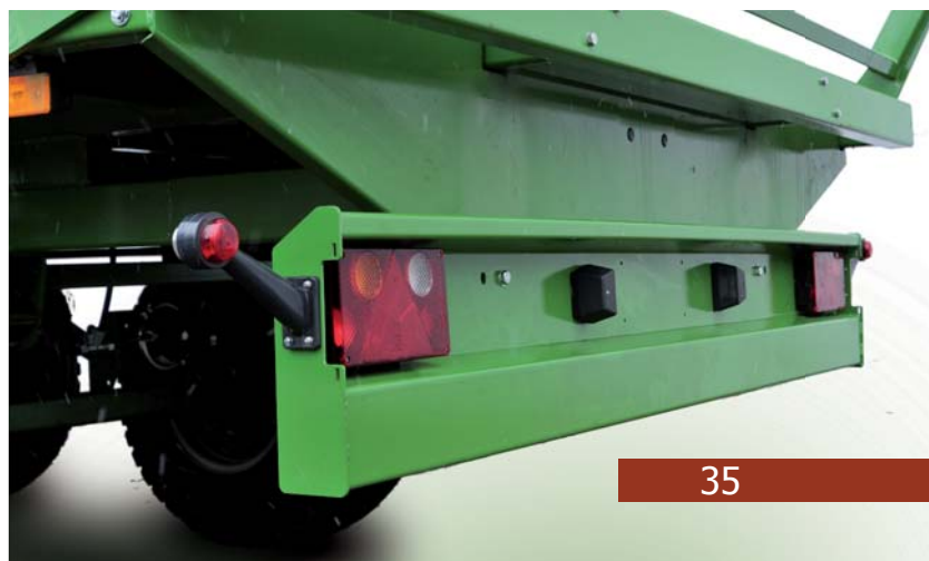
Фотография: Заднее предохраняющее устройство объединенное с задней подсветкой
