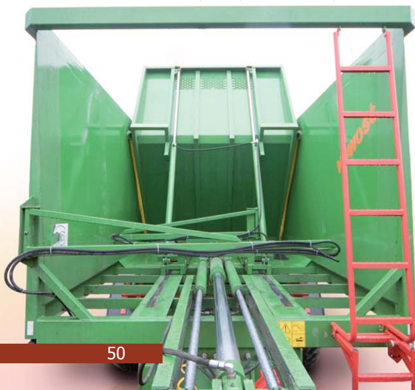
Фотография: Гидравлическая система передвижения и подъема стенки
