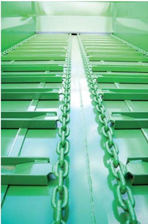
Фотография: Упрочненные планки и цепи толщиной 14 мм гарантируют надежность подающего механизма
