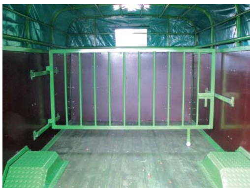
Фотография: Перегородка, разделяющая перевозимых животных, - часть опционального оборудования прицепов Kurier
