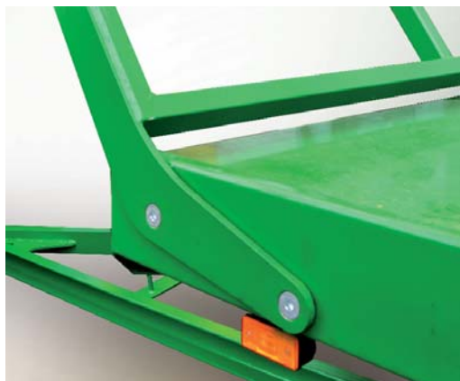
Фотография: Новая двухточечная система крепления лестницы, позволяющая отказаться от поддерживающих ступеней, которые препятствовали загрузке прицепа
