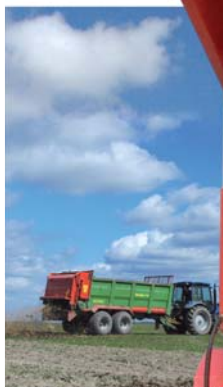
Фотография: Herkules 14 с объемом кузова 14 м 3 и грузоподъемностью 14 т
