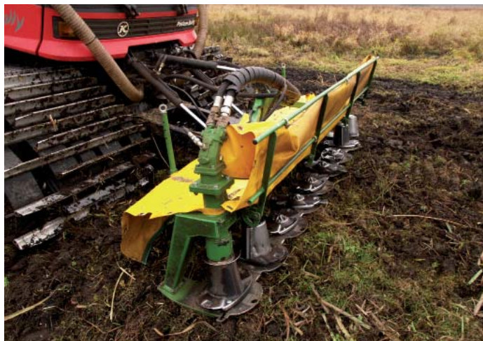
Фотография: Косилка PDF380R работает не от ВОМ, а от очень производительной гидравлической системы. При рабочей ширине 3,8 м и объеме потребления гидравлической системы, равным 115 л/мин, производительность косилки составляет около 4 га/ч. Ширина покоса составляет 1,5-2 м
