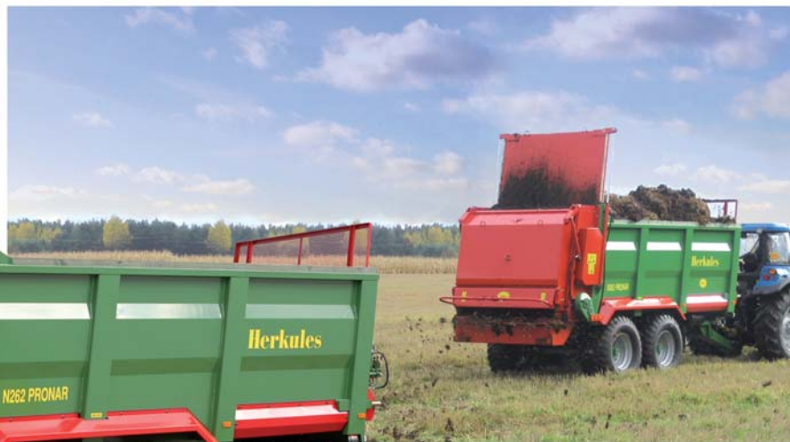
Фотография: Адаптер имеет два горизонтальных барабана с двумя разбрасывающими дисками. Ширина разброса в зависимости от вида материала может достигать до 25 м
