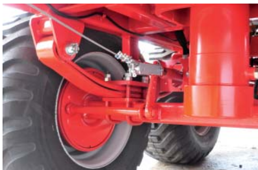
Фотография: Металлические ограничители и параболические рессоры, прикрепленные к оси квадратного сечения
