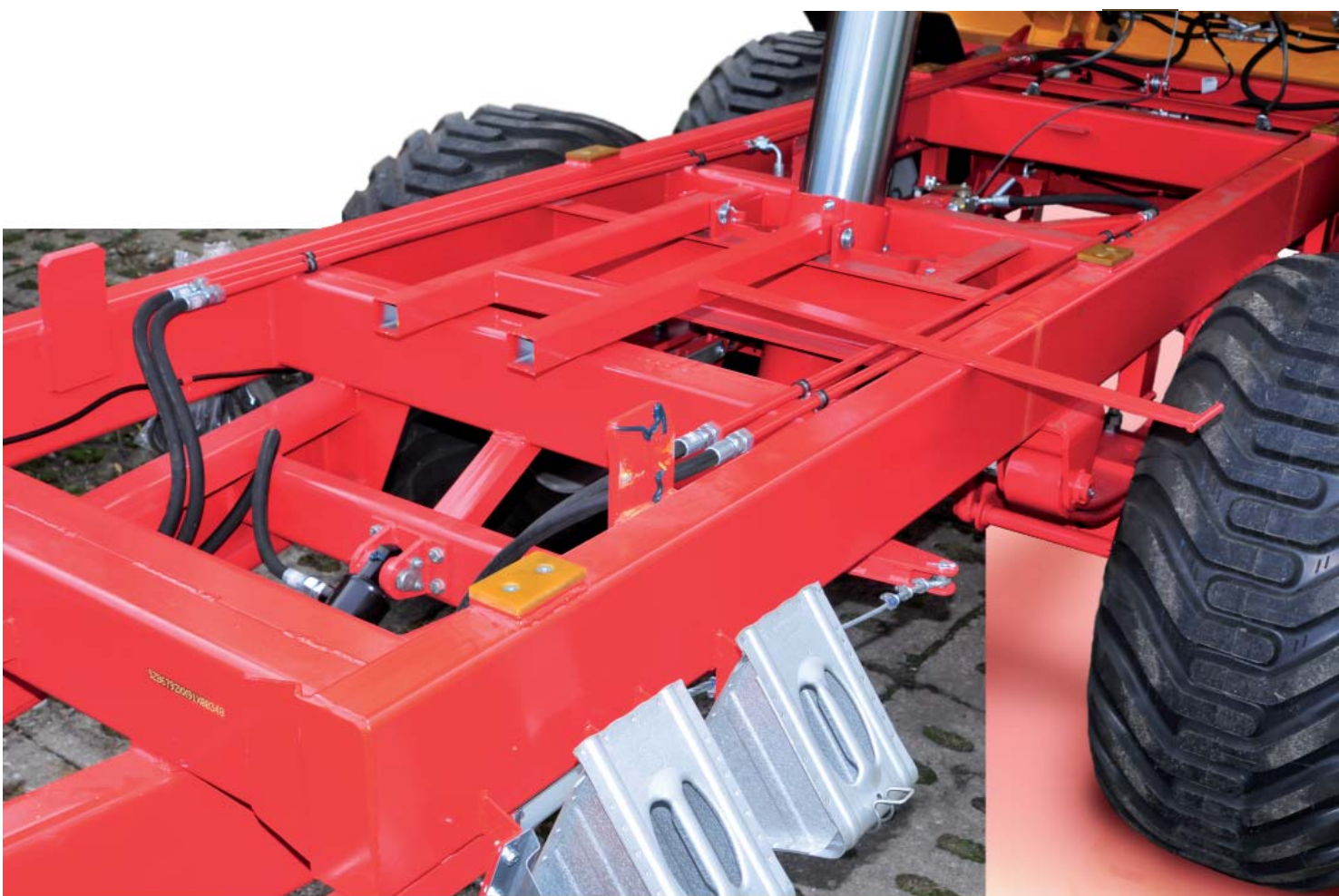
Фотография: Замкнутый профиль как базовый несущий элемент нижней рамы прицепа PRONAR T679/2
