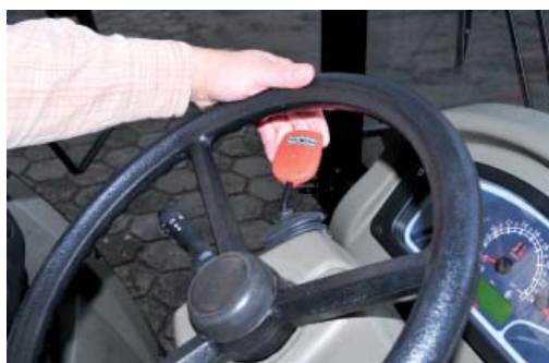
Фотография: изменение направления движения при помощи рычажка под рулем без использования сцепления
