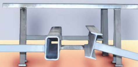
Фотография: Испытание на устойчивость к нагрузкам на изгиб замкнутого профиля (слева), который оказался более устойчивым, чем прокатный двутавр
