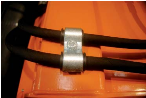
Фотография: Крепление гидравлических проводов
