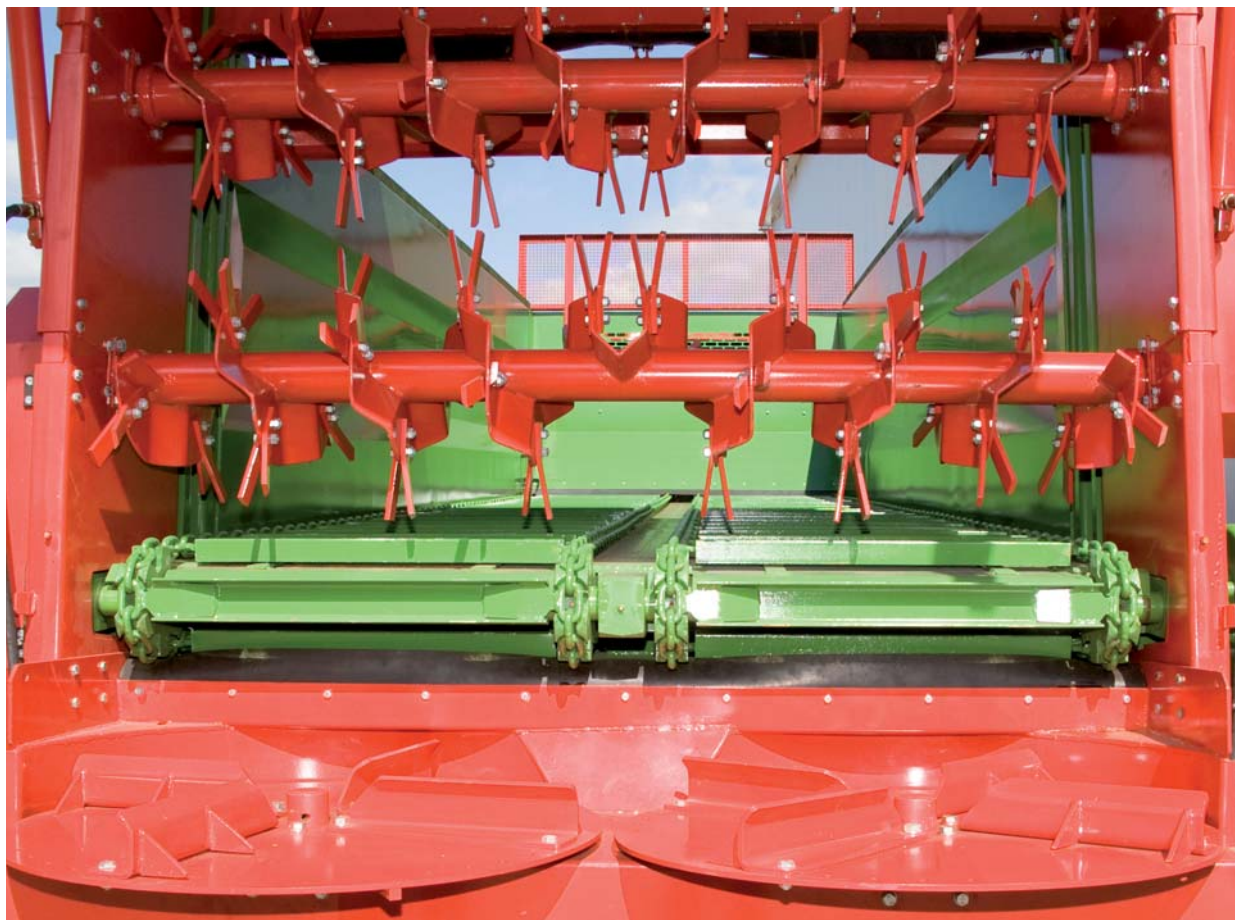
Фотография: Двухвальцевый горизонтальный адаптер, а также два разбрасывающих диска с широким диапазоном разбрасывания, разбрасыватель N262
