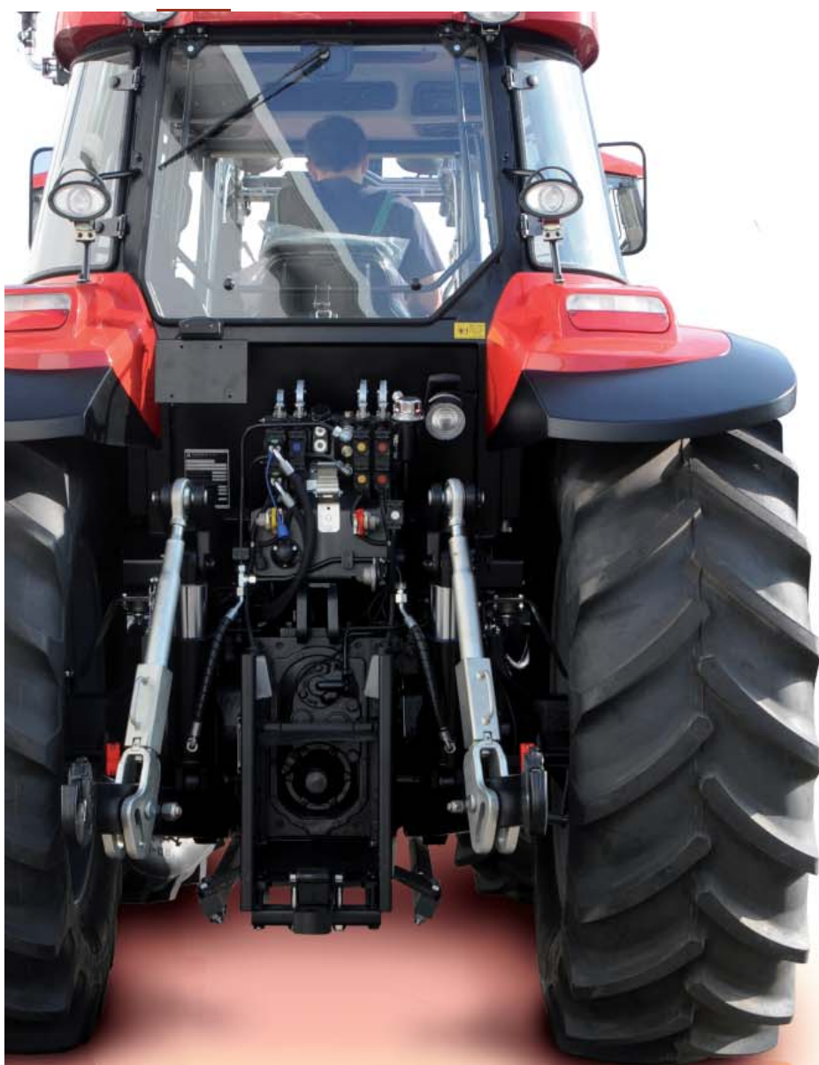
Фотография: два гидроцилиндра диаметром 100 мм обеспечивают грузоподъемность СТН 9200 кг
