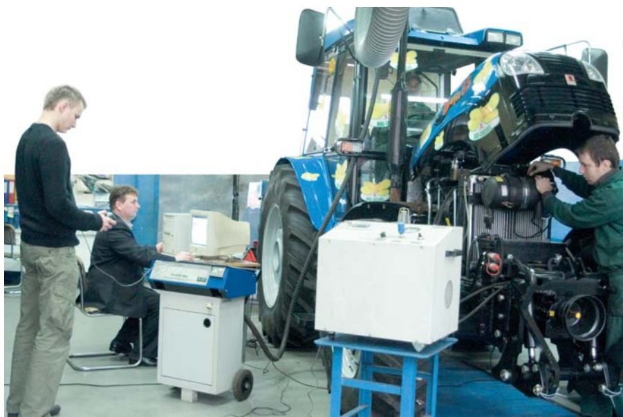
Фотография: Изучение эксплуатационных параметров трактора Zefir 85, работающего на рапсовом масле
