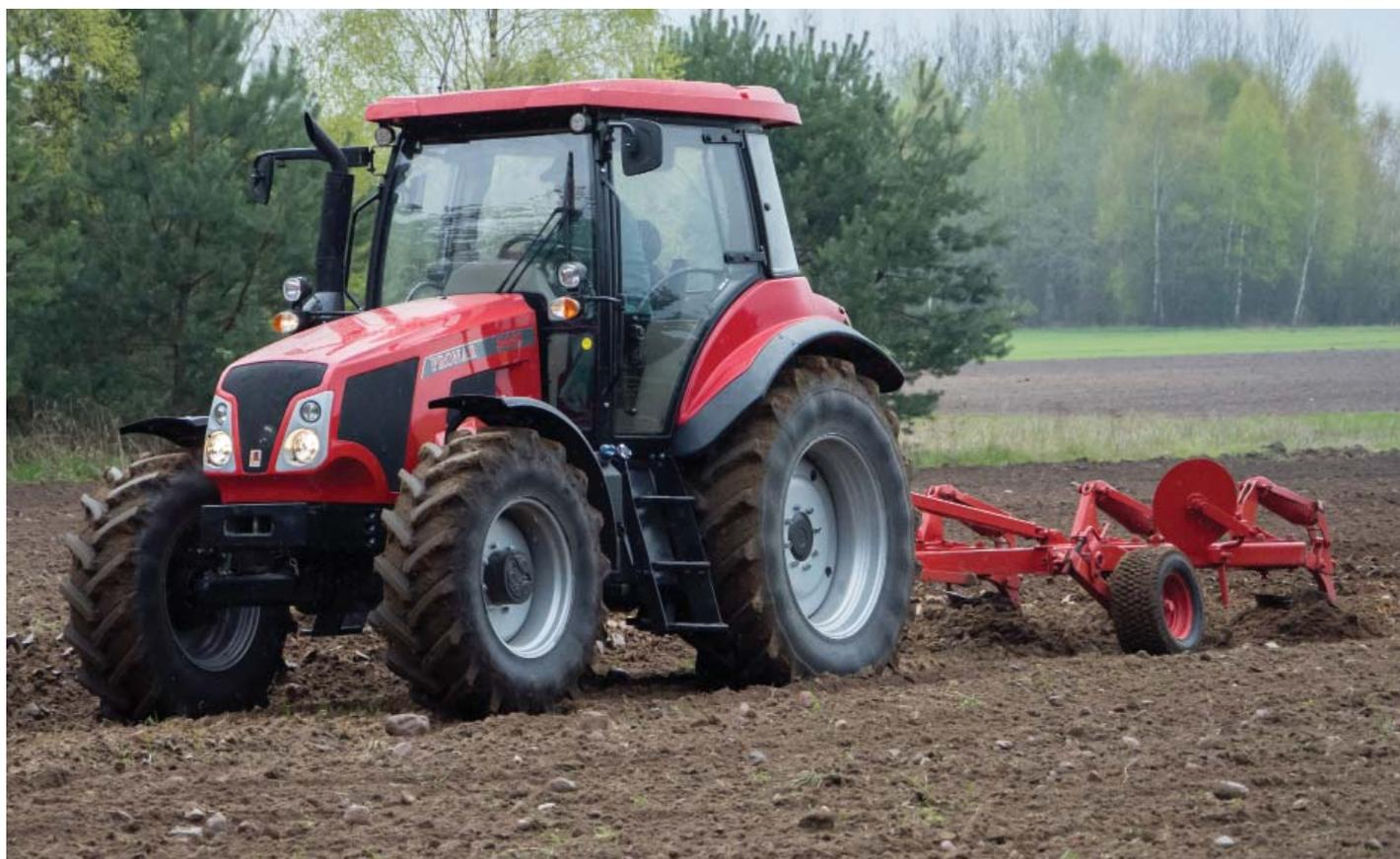
Трактор PRONAR 5440. Видимым элементом соответствия нормам, предусмотренным нормативными документами, которые будут действительны на Этапе IV, является катализатор SCR, установленный перед кабиной.
