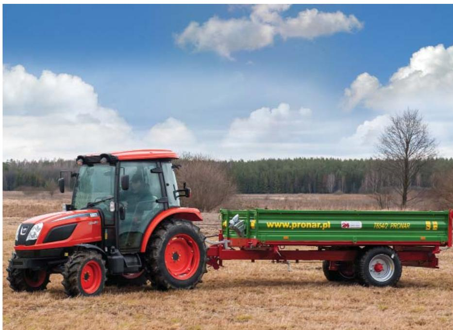
В стандартной версии прицеп PRONAR T654/2 оснащается бортами из профилей высокого качества высотой 500 мм, изготовленных с использованием передовых технологий профилирования металла и лазерной сварки, со стабильными задними стойками и с коваными петлями и замками. Кузов прицепа оснащен механизмом трехстороннего опрокидывания бортов и качающимся задним бортом. В стандартной комплектации доступны также: заслонка разгрузочного люка
