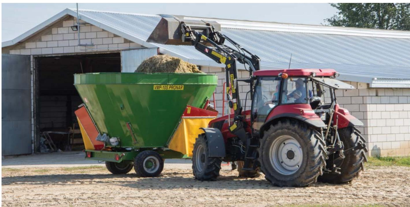
Характерным отличием кормораздатчиков PRONAR является сегментная конструкция бункера. Благодаря ней каждый фермер может адаптировать его вместимость (даже до 12 м<sup>3</sup>) в соответствии с размером стада, устанавливая или демонтируя дополнительные надставки.
