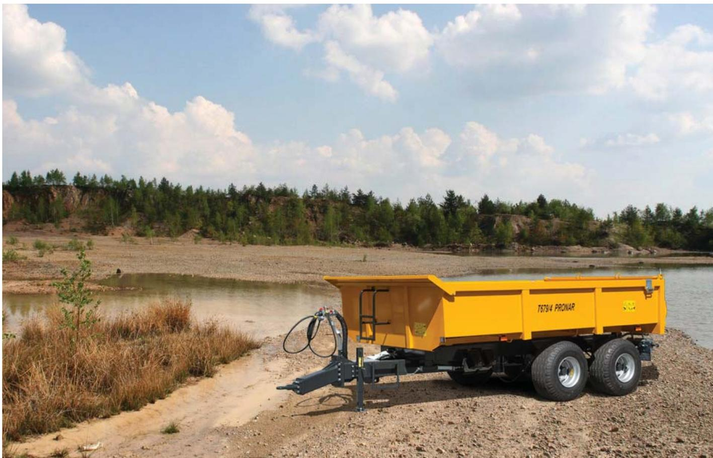
подвески типа тандем. Прицепы оснащены очень стойкими шинами, колесными дисками и ходовыми осями. В прицепах Т701 и Т679/2 используется подвеска тандем с параболическими рессорами. В прицепе Т701 можно выбрать тип подвески: „буги” (на базе очень прочных продольно балансирующих листовых рессор) или тандем (на параболических рессорах). Широкие грузовые платформы позволяют загружать и перевозить на них строительную технику, например, экскаваторы.
