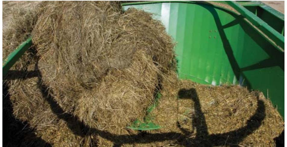
надставкам (дополнительное оснащение) можно увеличить его вместимость до 6 м<sup>3</sup>. Задний ссып помогает в коровниках и свинарниках с узким проходом - при обычной раздаче корма (с обеих сторон бункера) корм мог бы попасть в поилки. В больших и широких хлевах два боковых окна позволяют раздавать корм за один проезд.
