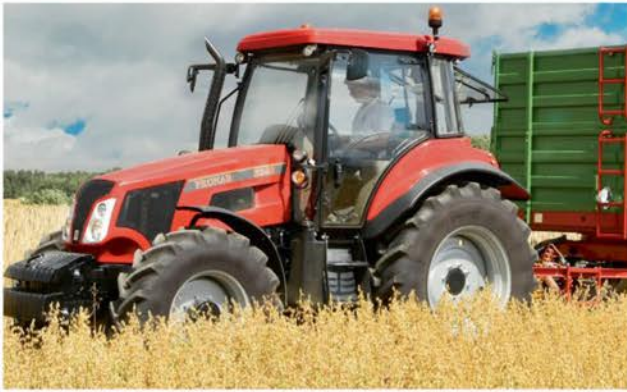
Serię P5 reprezentować ma model Pronar 5340 z silnikiem marki Deutz i przekładnią firmy ZF.
