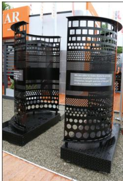
△ W przesiewaczach bębnowych Pronar stosowane są sita z perforacją okrągłą lub prostokątną o dowolnej wielkości oczek dostosowanych do wymagań nabywcy
