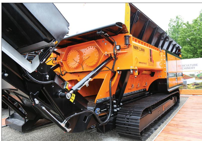
lub Volvo o mocy 428 KM. Maszyna ma ciekawy układ chłodzenia, w którym w fazie usuwania zanieczyszczeń w wentylatorze chłodnicy zmienia się ustawienie łopatek, podczas gdy kierunek obrotów pozostaje taki sam.
