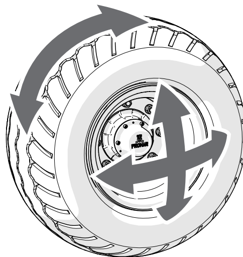
Рисунок 6.9 Проверка люфта подшипников
