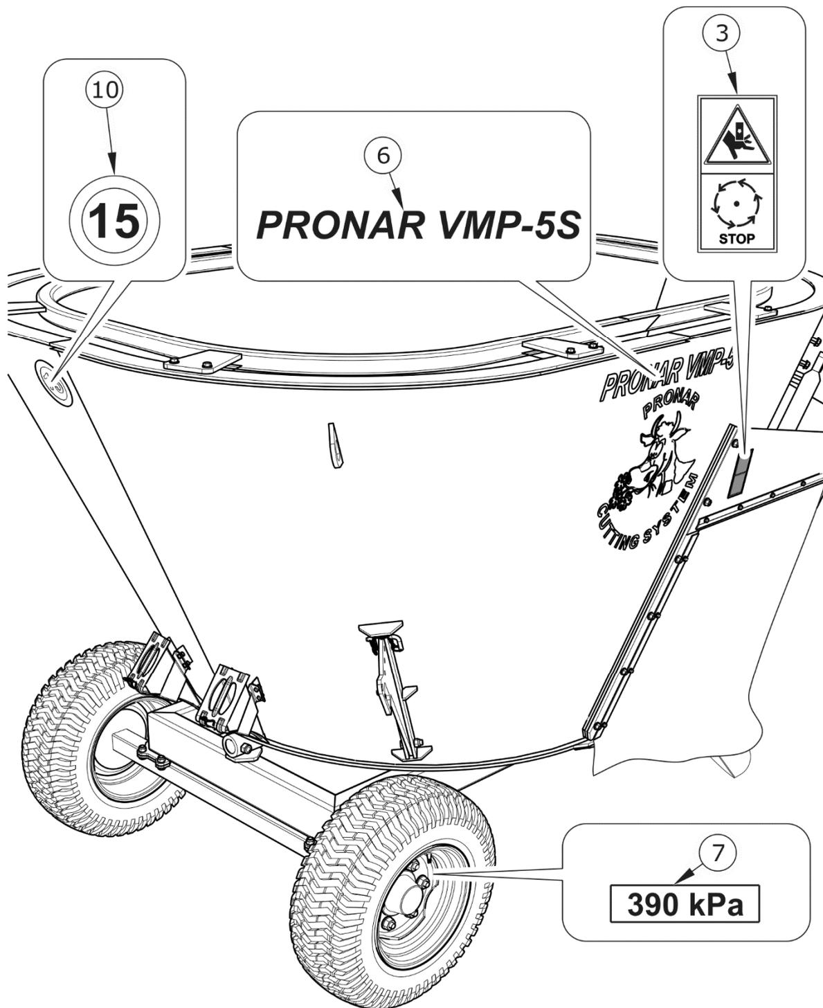
FIGURE 2.3 Emplacement des étiquettes d'information et de mise en garde
