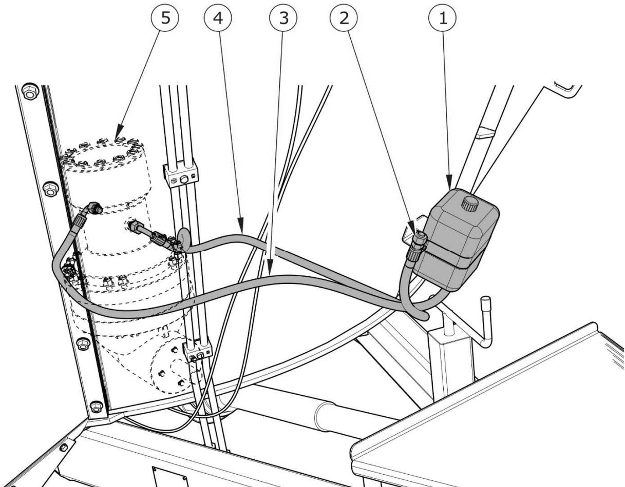
**FIGURE 3.6** Installation de lubrification de la transmission
