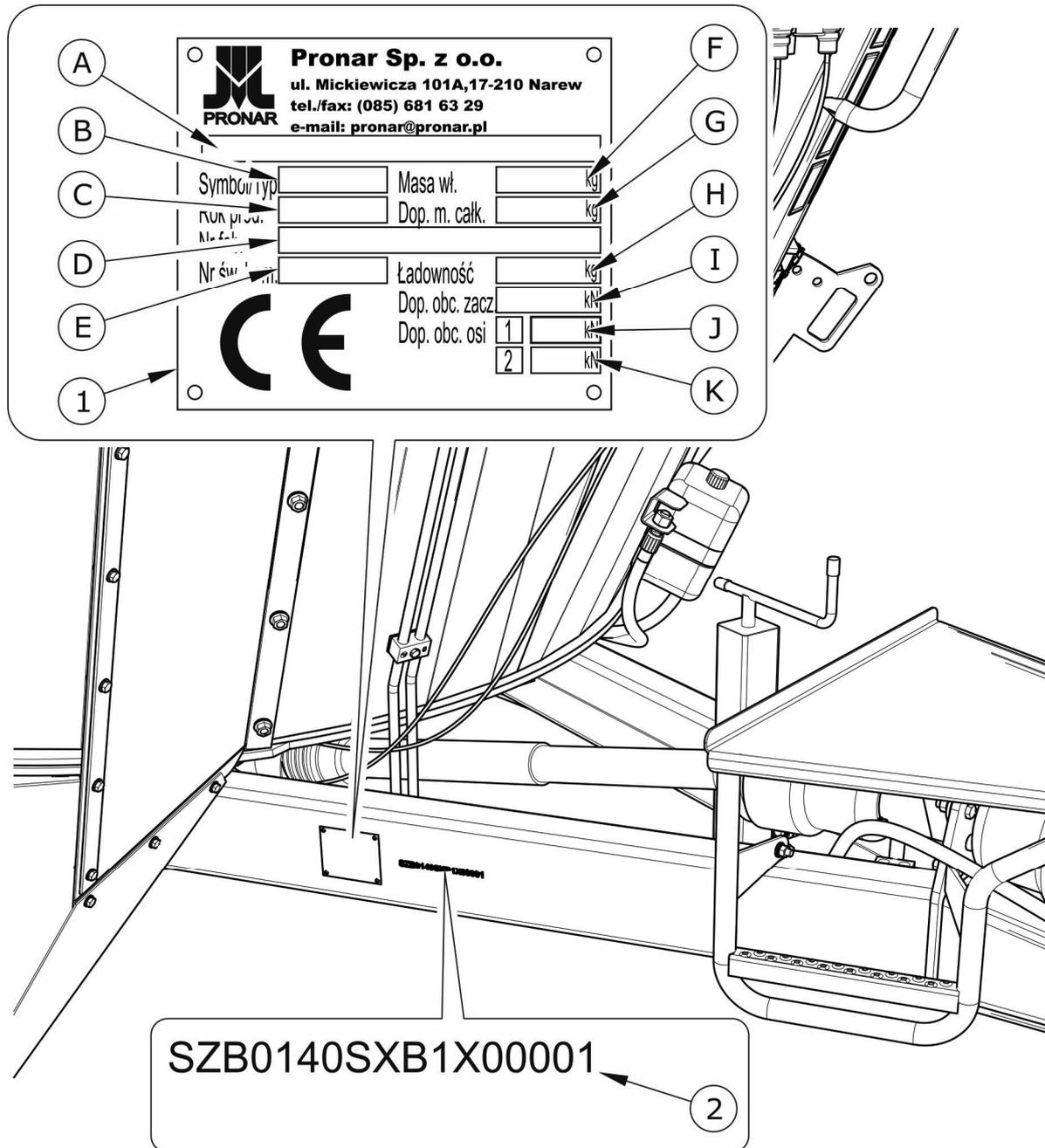
**FIGURE 1.1** Emplacement de la plaque signalétique et emplacement de frappe du numéro d'usine
