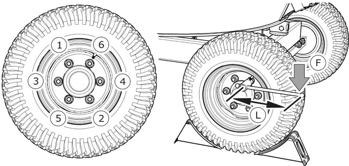
**FIGURE 5.3** Ordre de serrage des écrous
