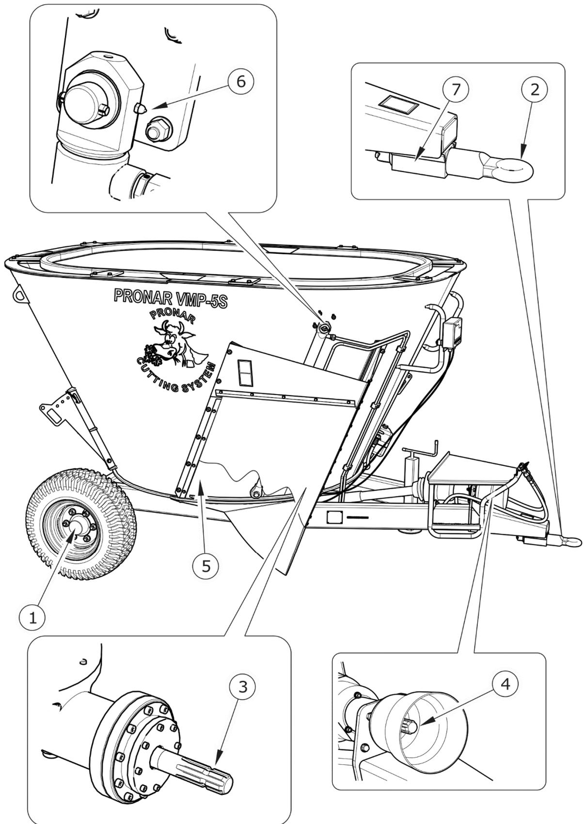
FIGURE 5.4 Points de lubrification du char mélangeur
