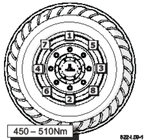
Abbildung 6.14 Die Reihenfolge des Festziehens der Muttern (8 Stück)
