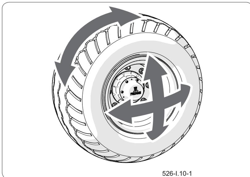
Рисунок 6.12 Проверка зазора
