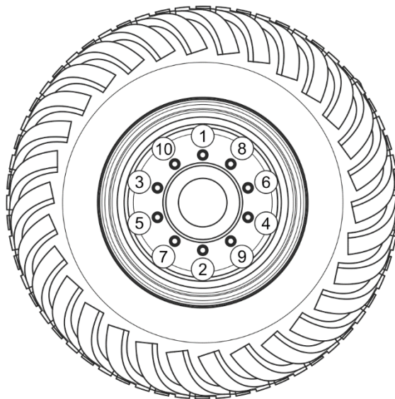
РИСУНОК 5.4 Очередность отвинчивания и завинчивания гаек
