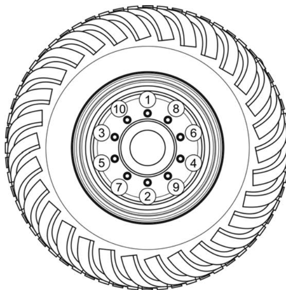
RYSUNEK 5.4 Kolejność odkręcania i dokręcania nakrętek
