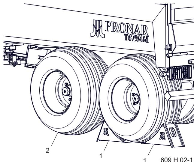
**Рисунок 4.2** Правильная установка клиньев (1) упорные клинья, (2) колесо ходовой оси
