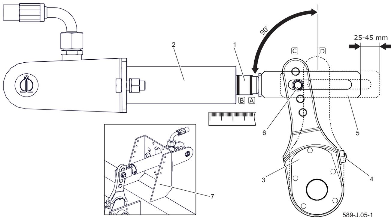
**Рисунок 6.7** Принцип регулировки гидравлического тормоза
