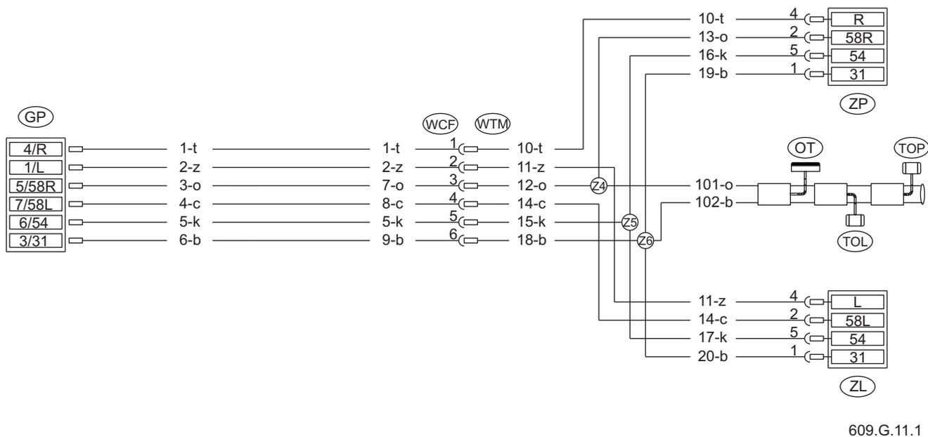
**Рисунок 3.13** Схема электрической системы прицепа.
