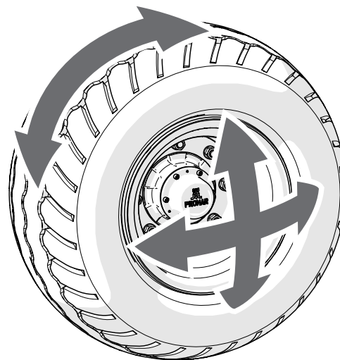
Tegning 5.9 Kontroll av lagerets løshet
