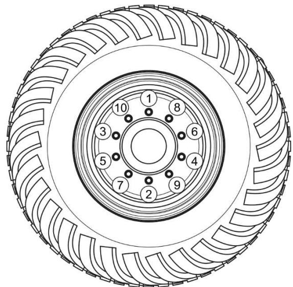
РИСУНОК 5.4 Очередность отвинчивания и завинчивания гаек
