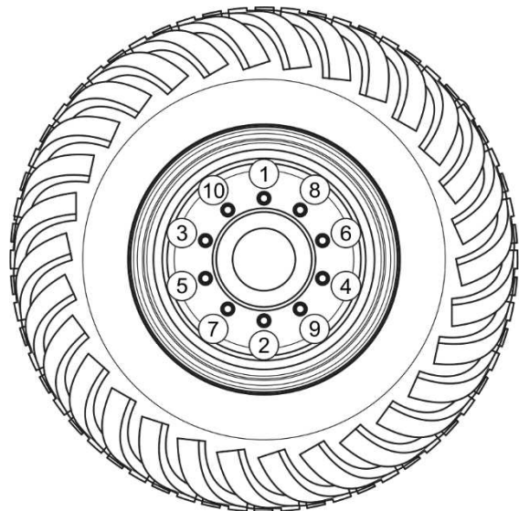
РИСУНОК 5.4 Очередность отвинчивания и завинчивания гаек
