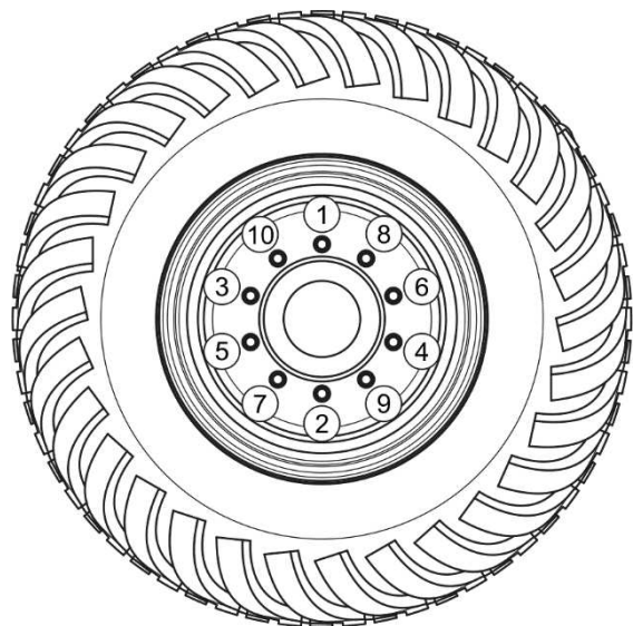
РИСУНОК 5.4 Очередность отвинчивания и завинчивания гаек
