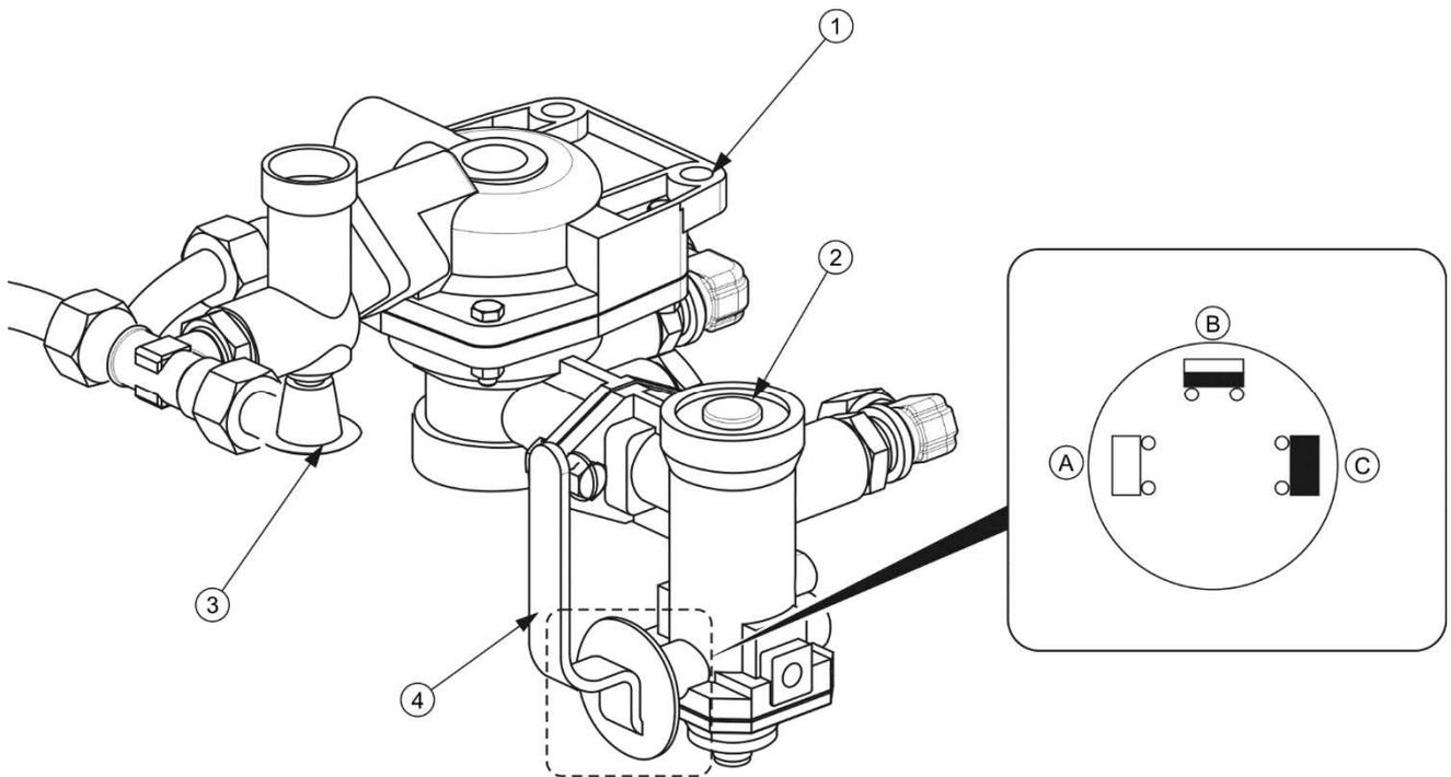
**FIGURE 3.11** Vanne de commande et régulateur de la force de freinage
