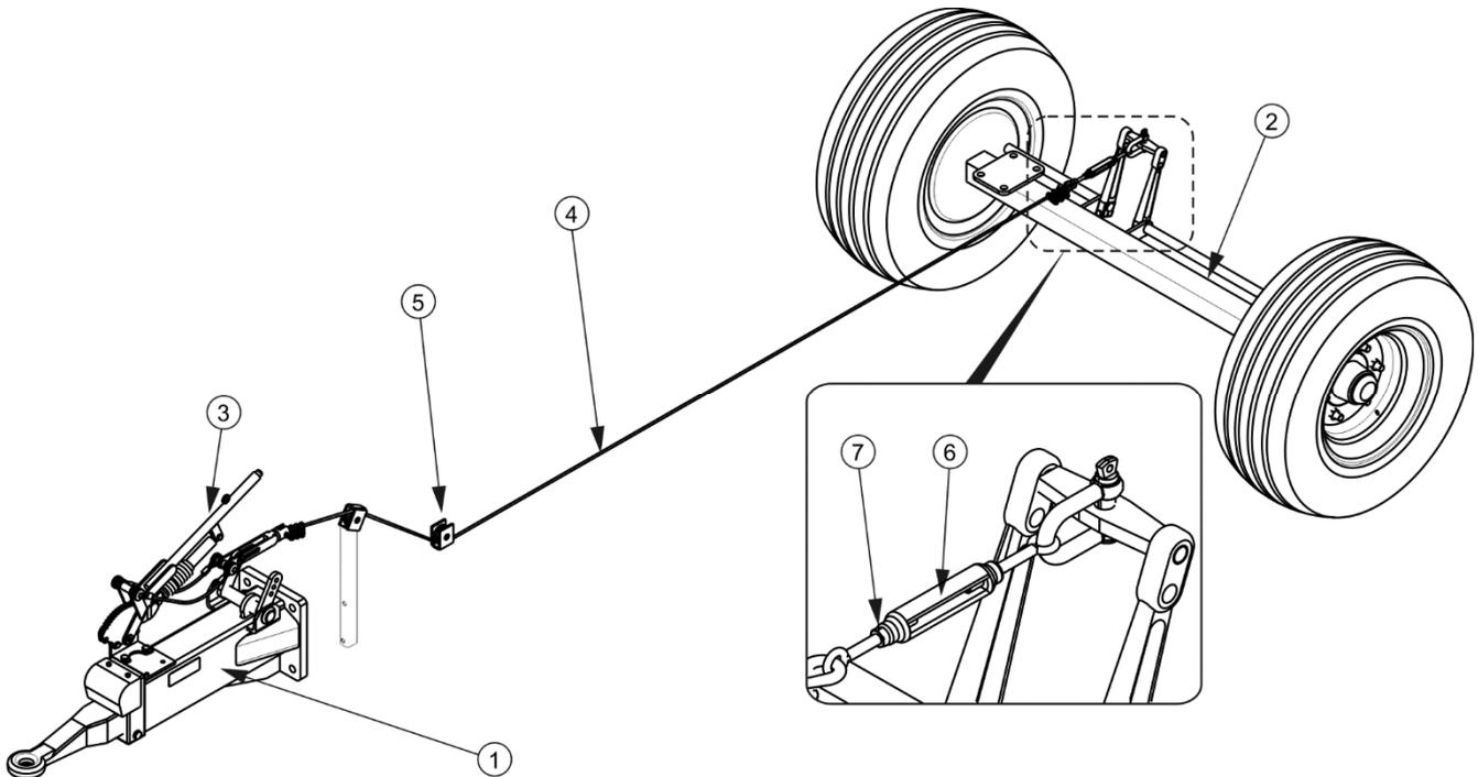
**FIGURE 5.5 Réglage de la tension de câble du frein à inertie**
