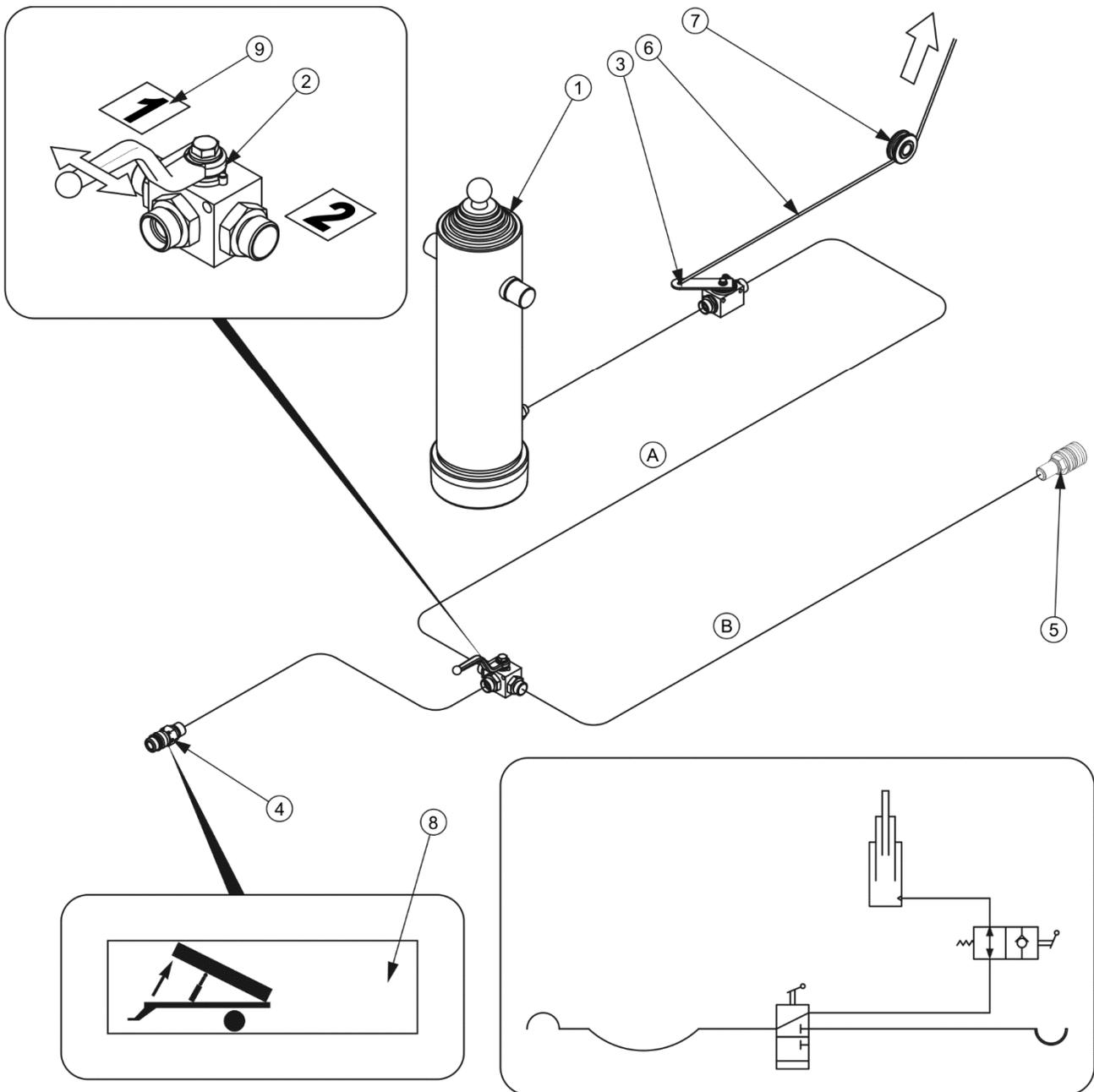
**FIGURE 3.12 Construction et schéma de l'installation hydraulique du dispositif de basculement**
