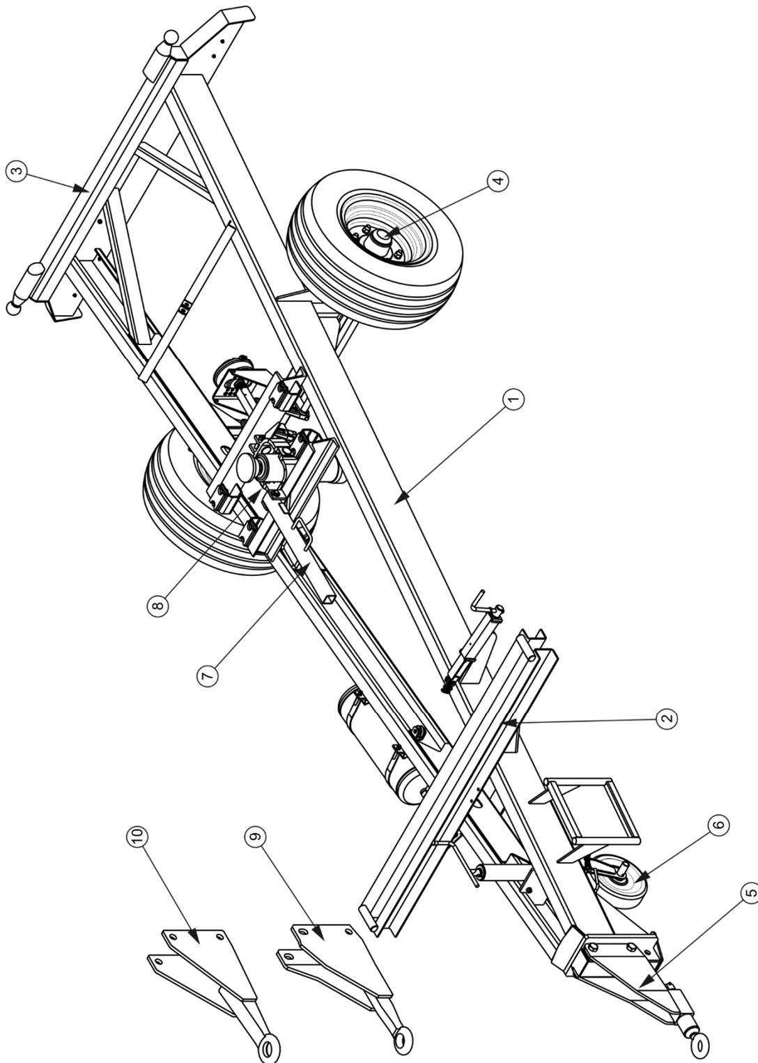
**FIGURE 3.1 Châssis de la remorque avec timon inférieur**
