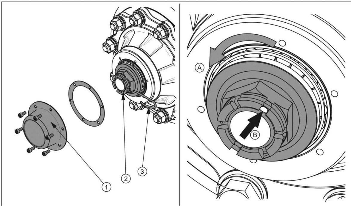
**FIGURE 5.2 Réglage des roulements de l'essieu**
