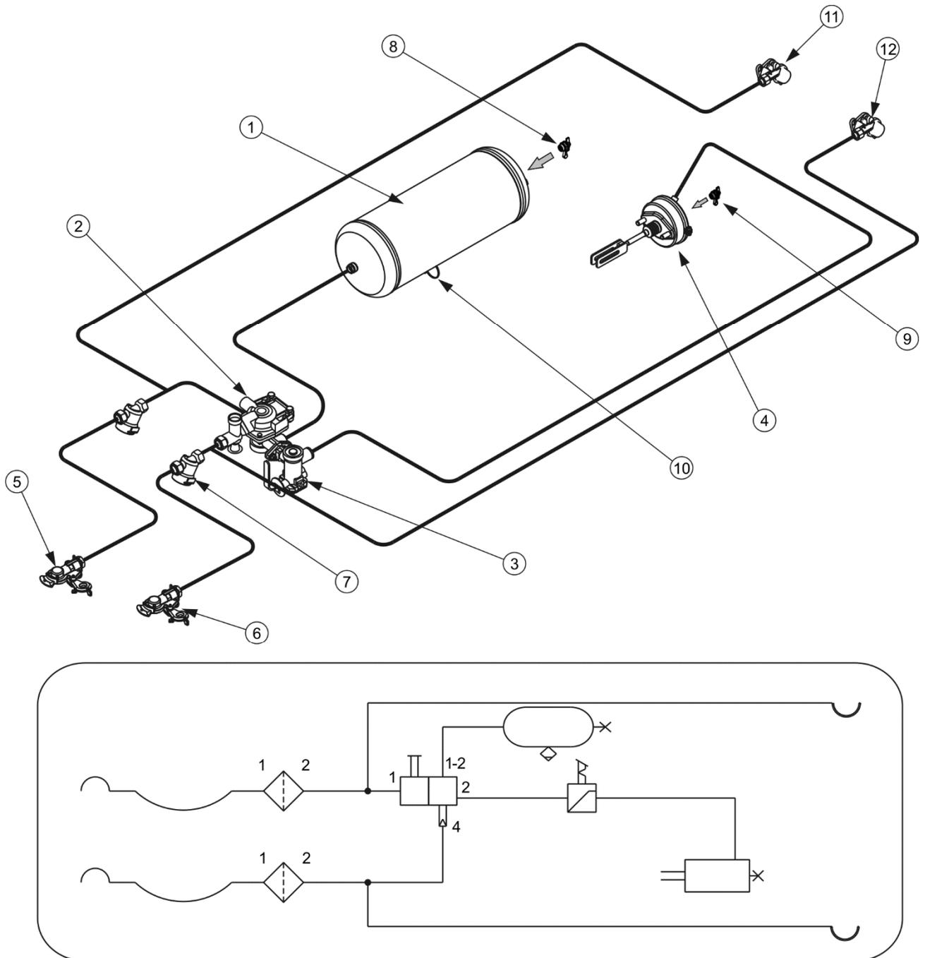
**FIGURE 3.7 Construction et schéma du système de freinage pneumatique à double circuit**
