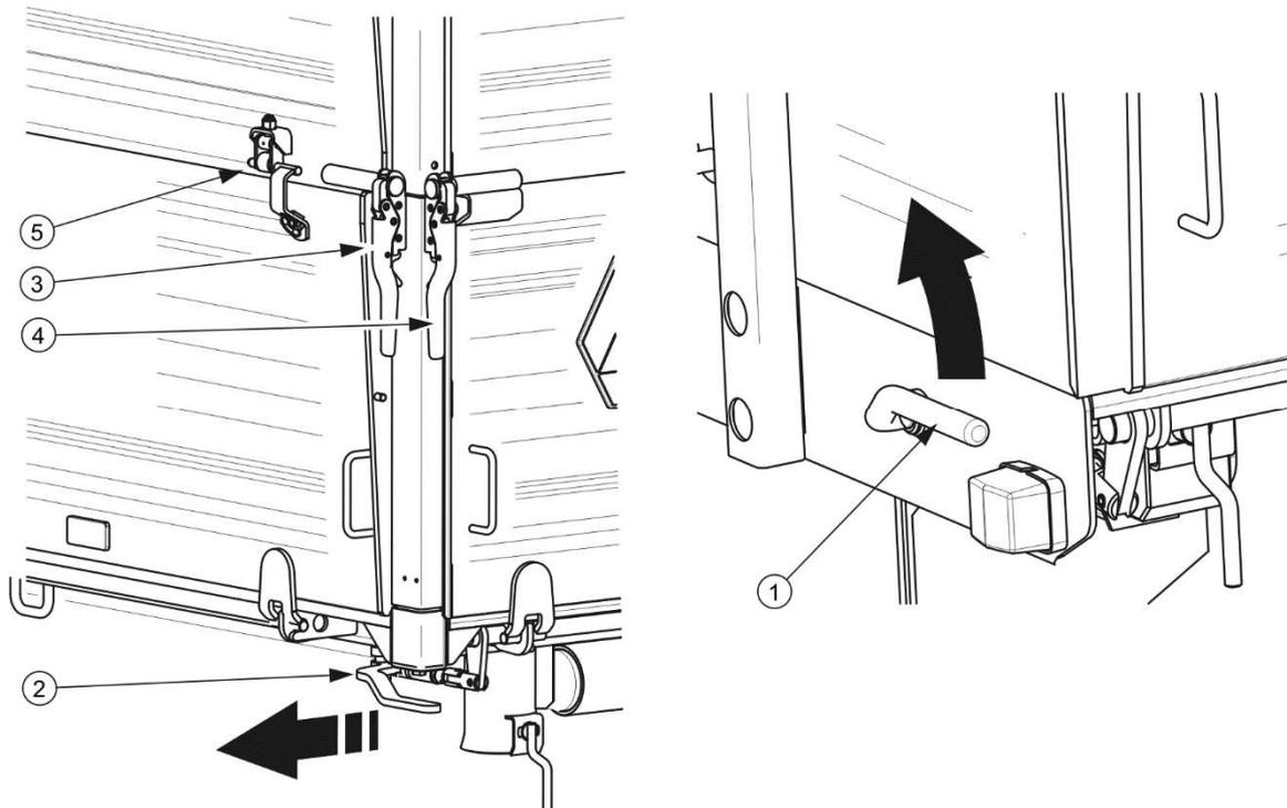
**FIGURE 4.5 Serrures des parois et rehausses de la benne**
