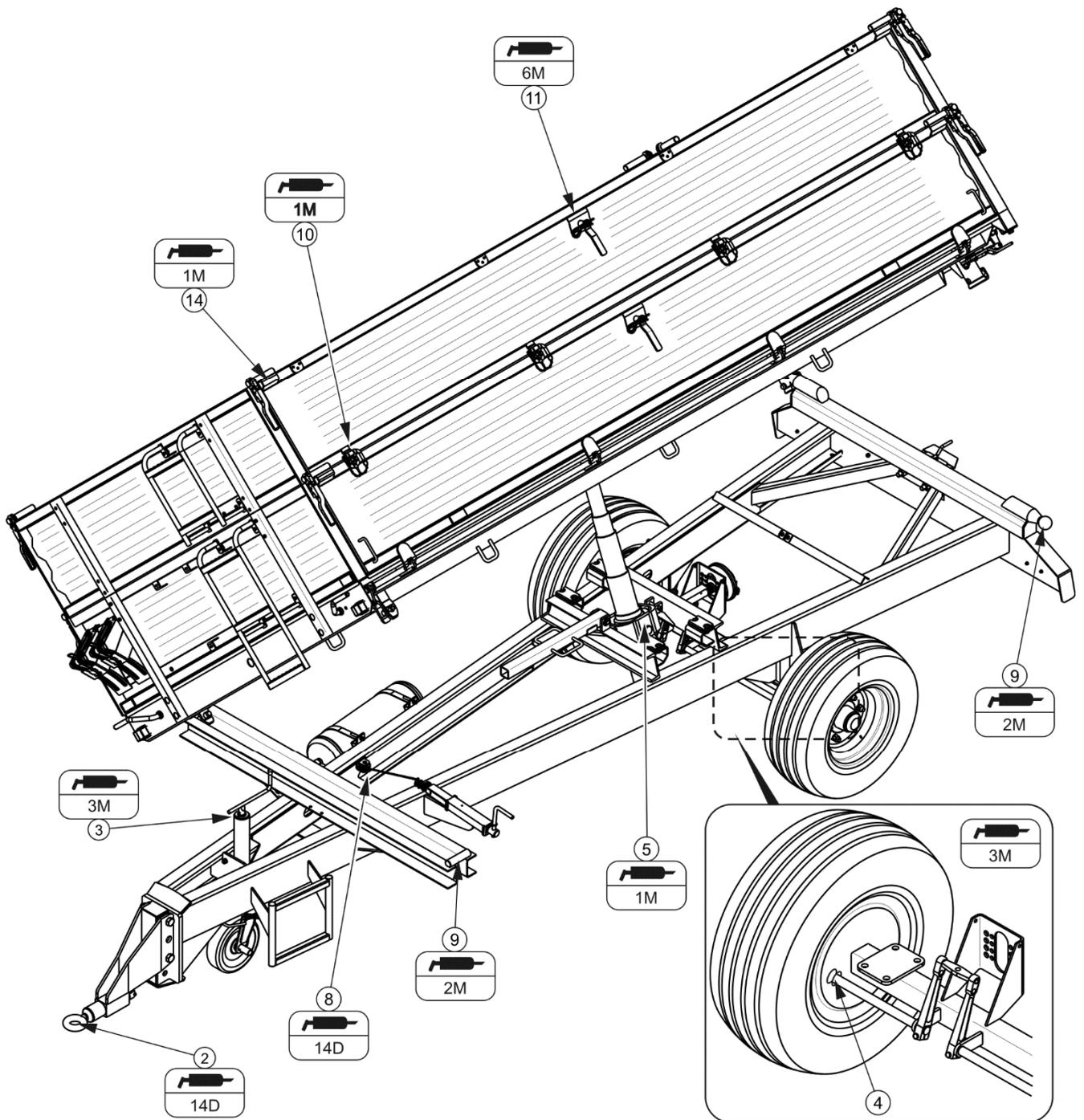
FIGURE 5.9 Points de lubrification de la remorque, partie 1
