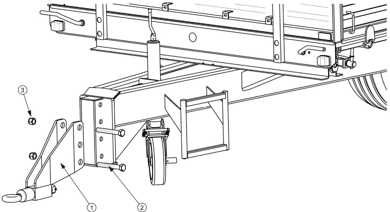
**FIGURE 5.13 Réglage de la position du timon**
