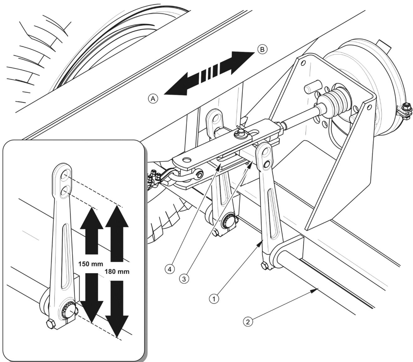
**FIGURE 5.4 Réglage des freins mécaniques d'essieux moteurs**
