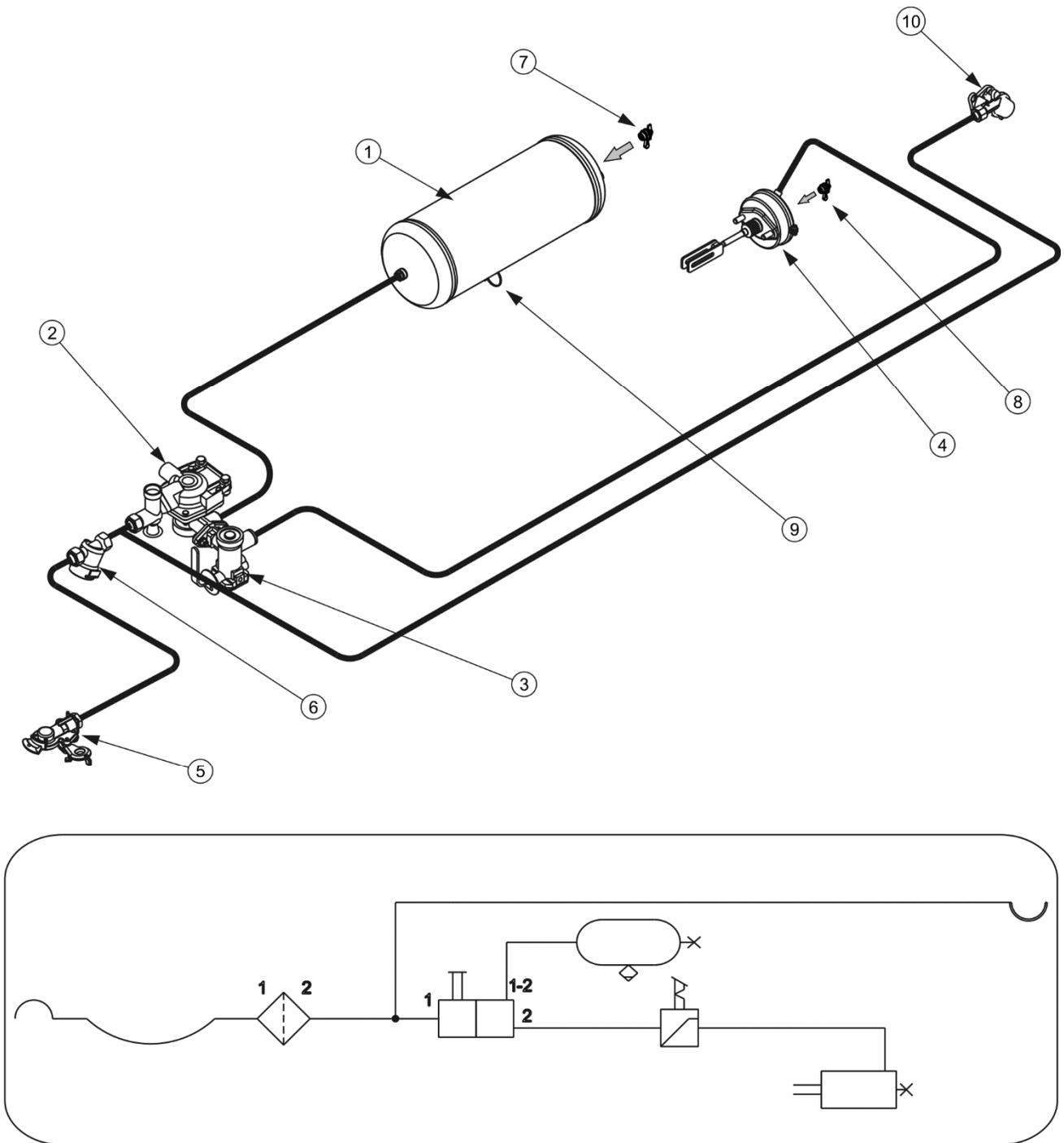
**FIGURE 3.8 Construction et schéma du système de freinage hydraulique à circuit simple**
