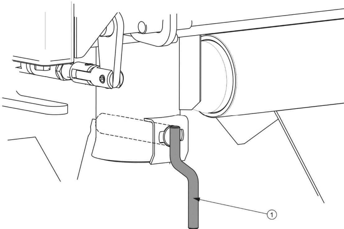
**FIGURE 4.4 Verrouillage des boulons de basculement**
