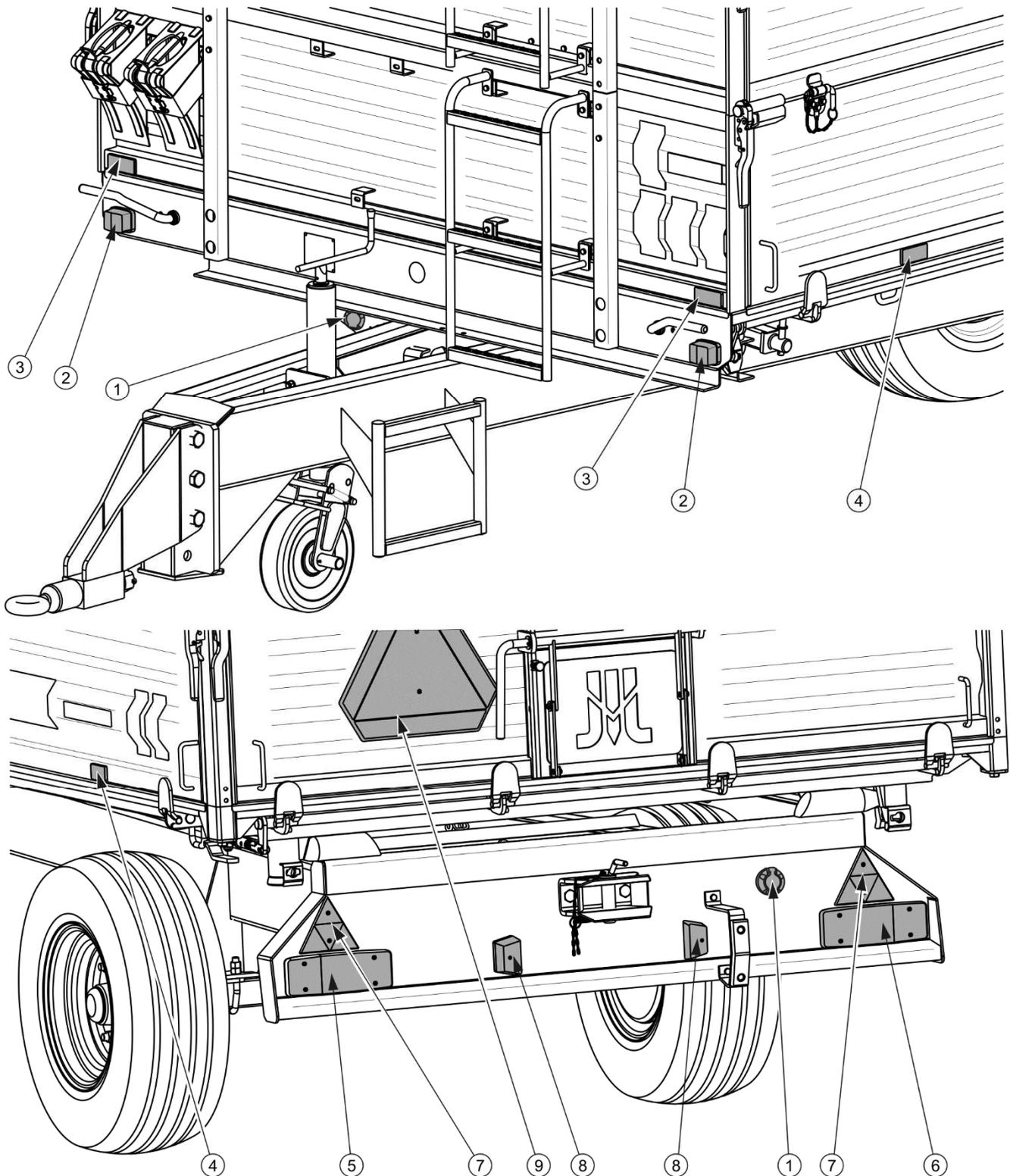
**FIGURE 3.15** Emplacement des éléments électriques et réfléchissants
