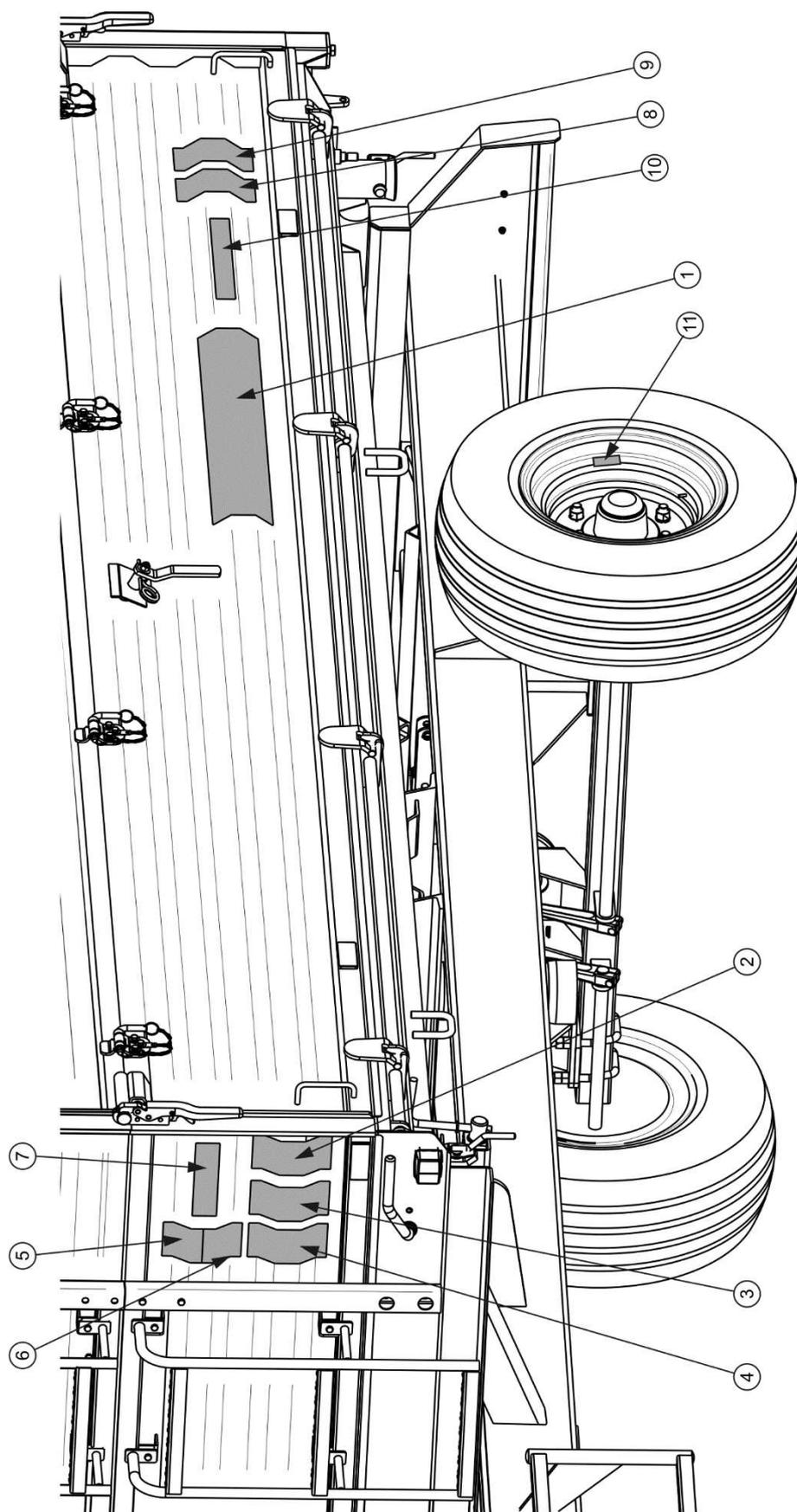
FIGURE 2.3 Emplacement des étiquettes d'information et de mise en garde
