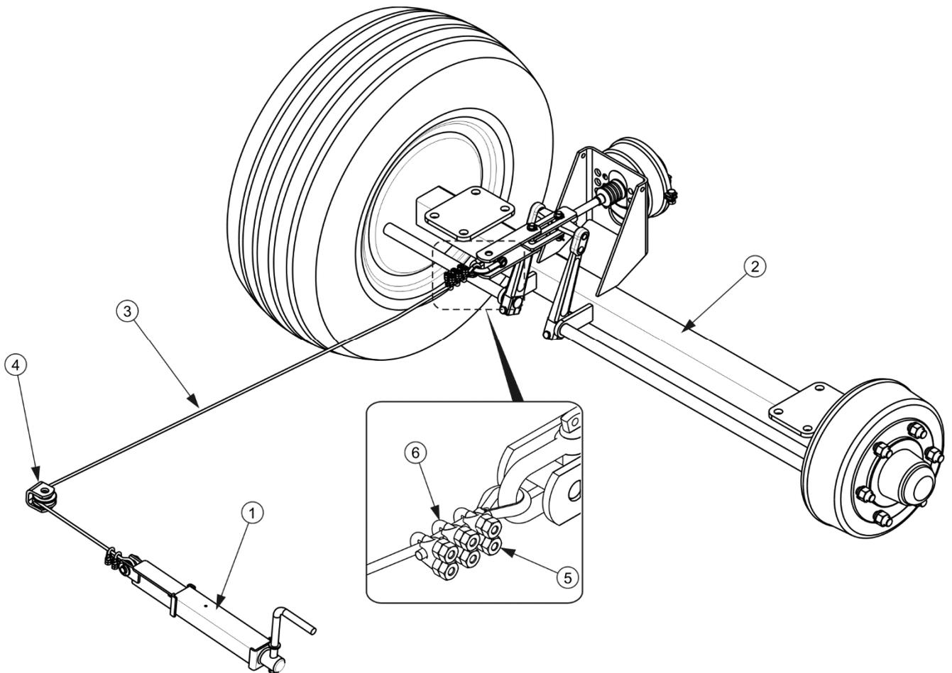
**FIGURE 5.6 Réglage de la tension de câble du frein de stationnement**
