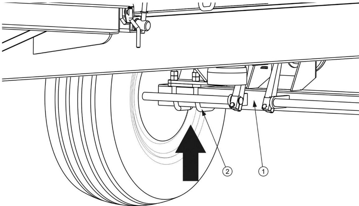
**FIGURE 5.1 Point d'appui du support**
