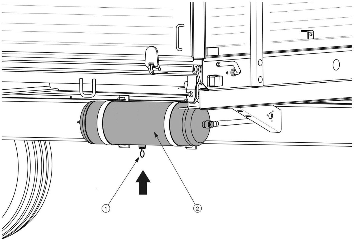
**FIGURE 5.8** Purge du réservoir d'air
