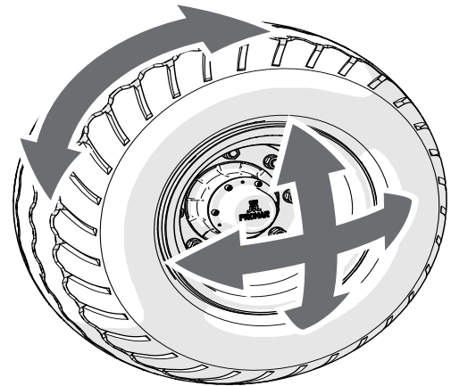
Figuur 5.10 Controle van de lagerspeling van de lopende assen
