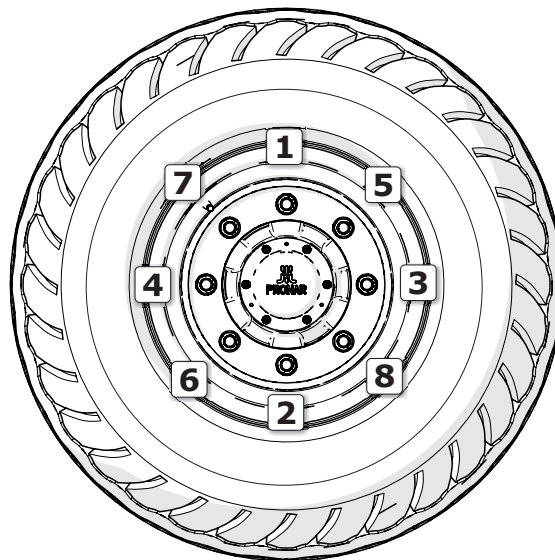
Rysunek 5.14 Kolejność dokręcania nakrętek
