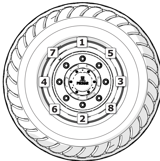
Billede 5.14 Rækkefølge for møtrikkernes stramning
