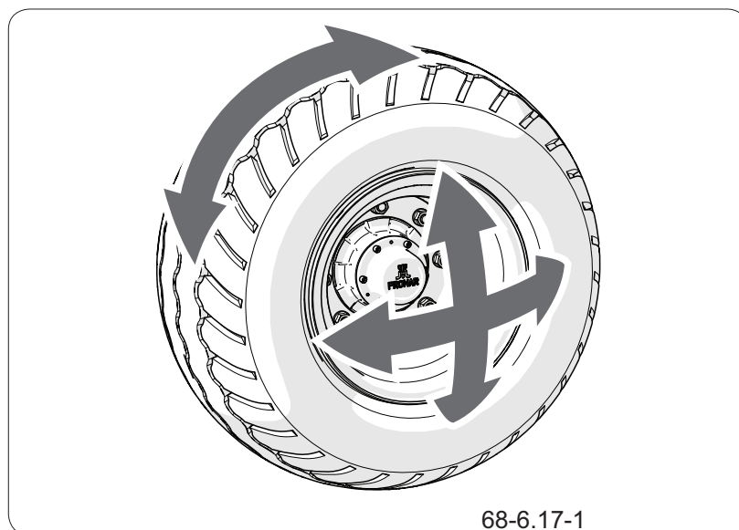
Рисунок 6.6 Проверка люфта подшипников
