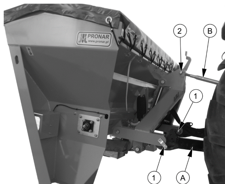
SLIKA 4.1 Povezivanje sa traktorom
