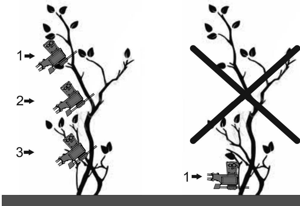
Abb. 4.4 Einstellen der Arbeitsposition und Schneidreihenfolge.
