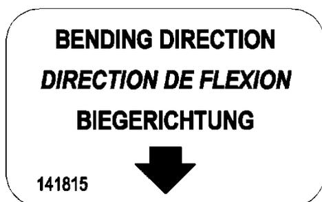
При установке датчика нагрузки соблюдать направление, указанное стрелкой.
