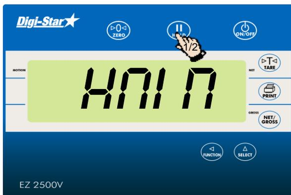
1. Нажать клавишу
