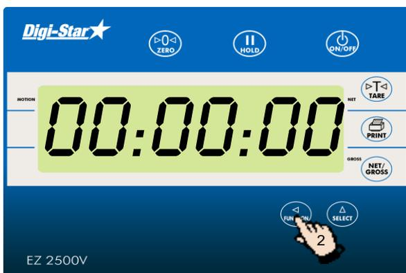
2. Нажать клавишу
