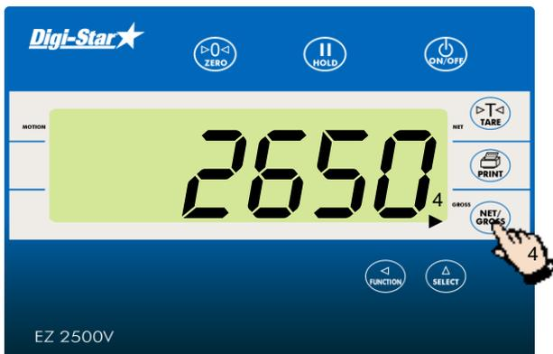
4. Нажать клавишу **NET/GROSS** чтобы отобразить общий вес всех загруженных порций. В данном примере:  $2350 \text{ кг} + 300 \text{ кг} = 2650 \text{ кг}$ . В нижней правой части дисплея мигает стрелка, которая указывает на надпись "GROSS" (вес брутто).
