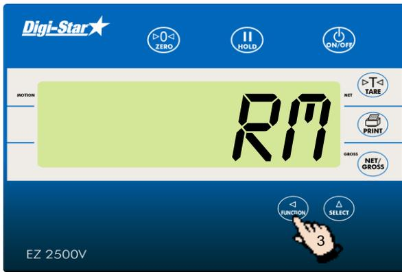
3. Нажать клавишу
