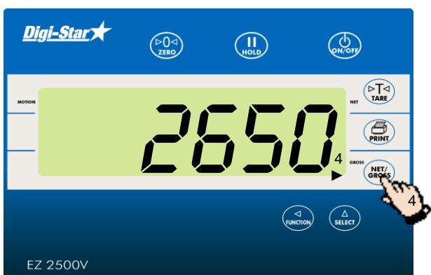
4. Нажать клавишу **NET/GROSS** чтобы отобразить общий вес всех загруженных порций. В данном примере: 2350 кг + 300 кг = 2650 кг. В нижней правой части дисплея мигает стрелка, которая указывает на надпись "GROSS" (вес брутто).
