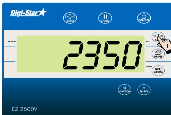
Если нужно загрузить дополнительные порции, следует нажать клавишу для временного обновления системы.
