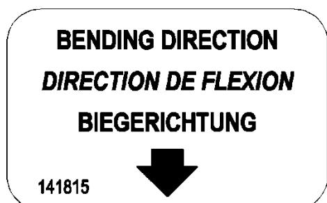
При установке датчика нагрузки соблюдать направление, указанное стрелкой.
