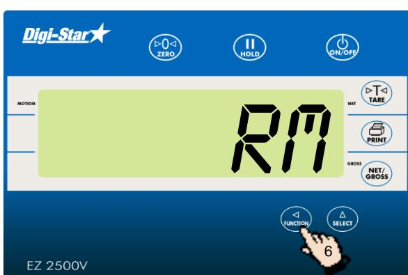
6. Нажать клавишу . Индикатор взвешивания прибавляет значение 1000 кг к значению 500 кг, которое уже внесено в память. На дисплее мигает индикация *Rm*; индикатор взвешивания возвращается в режим веса брутто.
