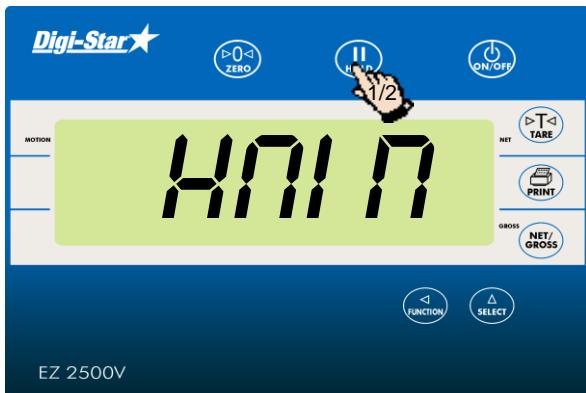
1. Нажать клавишу , чтобы удерживать на дисплее отображаемый вес.
