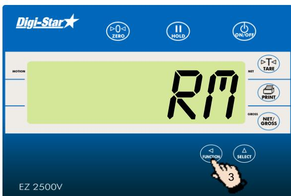
3. Нажать клавишу . Ненадолго отобразится индикация *500 KG* и *Rm*. Значение 500 кг вносится в память, а индикатор взвешивания возвращается в режим веса брутто.
