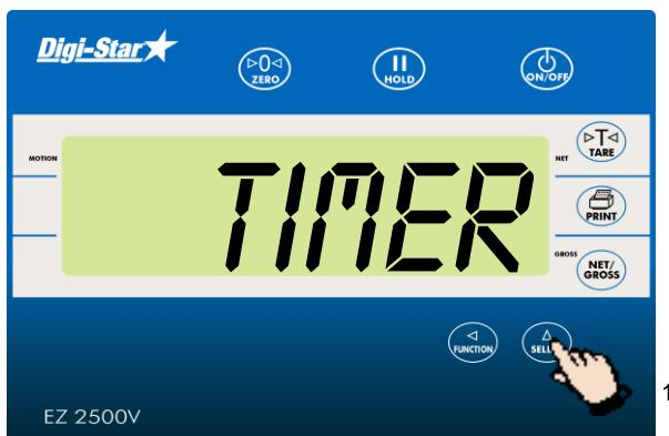
Опцию "Таймер" можно использовать, чтобы задать время смешивания. После смешивания (таймер достигает нуля) индикатор взвешивания выдает громкий звуковой сигнал.
