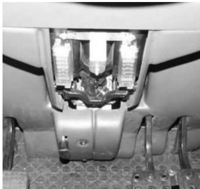
Рис. Е-28 Расположение комплекта предохранителей FB1 и FB2 на рулевой колонке: А - винты; В - крышка
