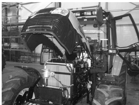
Rysunek 5-32a Maska i osłony boczne silnika (ZEFIR 85 / 85K). 1 - maska silnika; 2 - cięgło zamka maski
