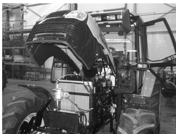
Rysunek 5-32b Maska i osłony boczne silnika (ZEFIR 90 / 90K). 1 - maska silnika; 2 - uchwyty zamka maski
