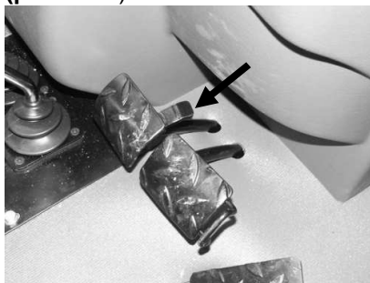
Рисунок 4-18 Планка, блокирующая педали рабочего тормоза.
