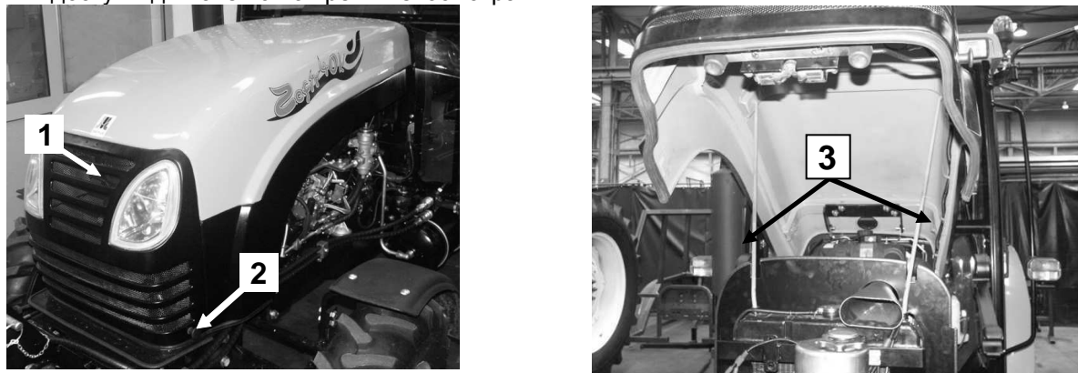
Рисунок 5-30 Капот двигателя. 1 - капот двигателя; 2 - ручка замка капота; 3 – стержневой упор
