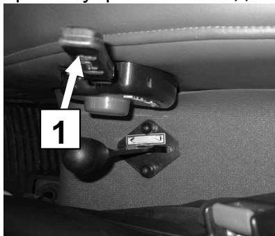
Рисунок 5-6 Рычаг 1 управления подачей топлива (рычаг «газ») (с правой стороны сиденья)
