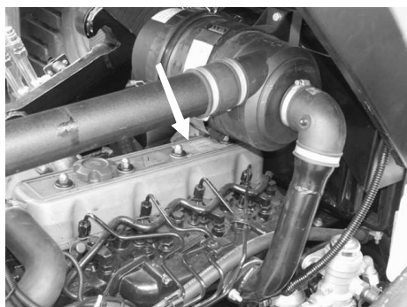
Рисунок 3-2 Расположение заводского щитка двигателя (на крышке головки двигателя).
