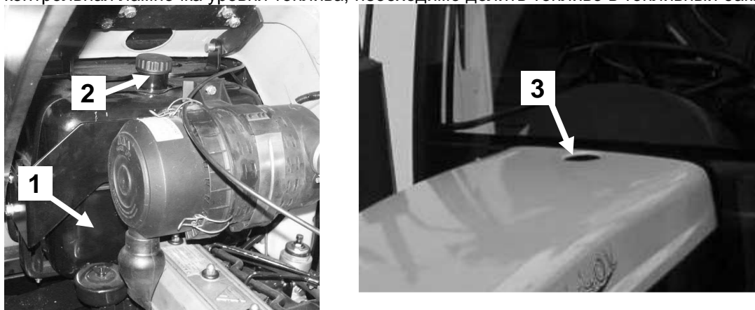
Рисунок 5-29 Топливный бак. 1 – топливный бак; 2 – заливная пробка топливного бака; 3- отверстие в капоте
