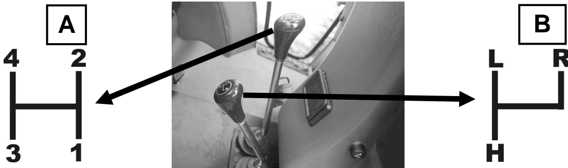
Рисунок 5-8. Рычаг переключения передач трактора ZEFIR.
