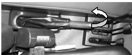
Рисунок 5-3 Стояночный тормоз (аварийный) с левой стороны сиденья.
