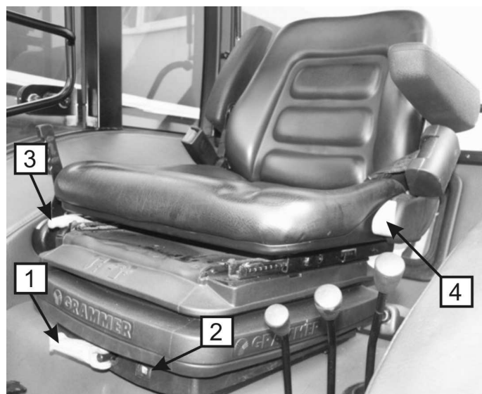
Рисунок 4-14 Расположение регулирующих механизмов сиденья GRAMMER DS 85H/90A
