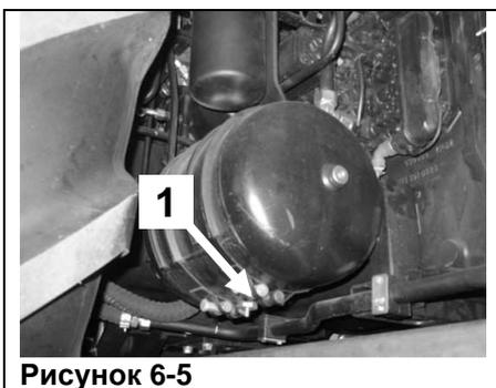
Резервуар пневмосистемы (пневмобак) находится за правым задним колесом.
