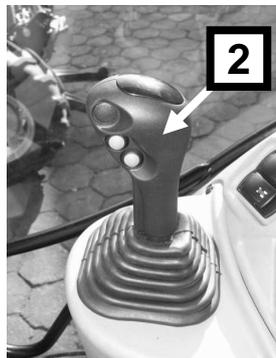
• установить переключатель направления движения трактора в положение движения вперед или назад (в зависимости от того, в каком направлении должен ехать трактор). Направление движения отображается на дисплее LCD (рис. 4-12).
