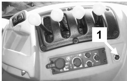
Гнездо зажигалки **1** на напряжение 12 V находится в кабине трактора на правом крыле (рис. 5-31). Чтобы воспользоваться зажигалкой, ее нужно вставить в гнездо до упора. Когда нагревающий элемент разогреется до нужной температуры, зажигалка автоматически отскочит. Гнездо зажигалки также можно использовать для подключения переносного фонаря или других электрических приборов, питающихся от напряжения 12 V.
