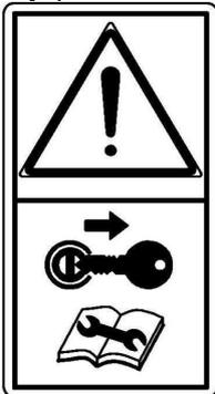
Прежде чем приступить к ремонтным работам или обслуживанию трактора, нужно выключить двигатель и вынуть ключ из замка зажигания.
