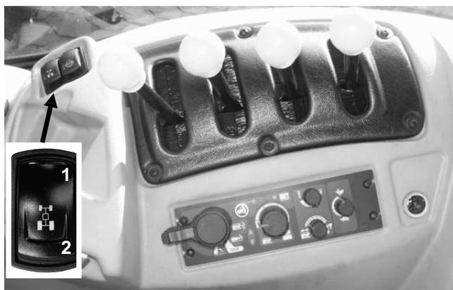
**Рисунок 4-26** Выключатель управления приводом переднего моста можно установить в двух положениях:
