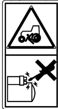
Не закорачивайте клеммы стартера для запуска двигателя. Не запускайте двигатель, стоя на земле. Запускайте двигатель только ключом зажигания с сиденья водителя. При этом стояночный тормоз должен быть включен, а рычаги коробки передач и ВОМ должны находиться в нейтральном положении.
