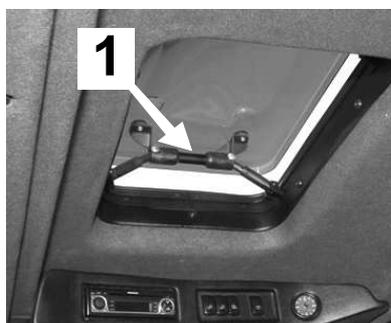
Люк в крыше можно заблокировать в закрытом или частично открытом положении при помощи рычажного механизма с двумя ручками.
