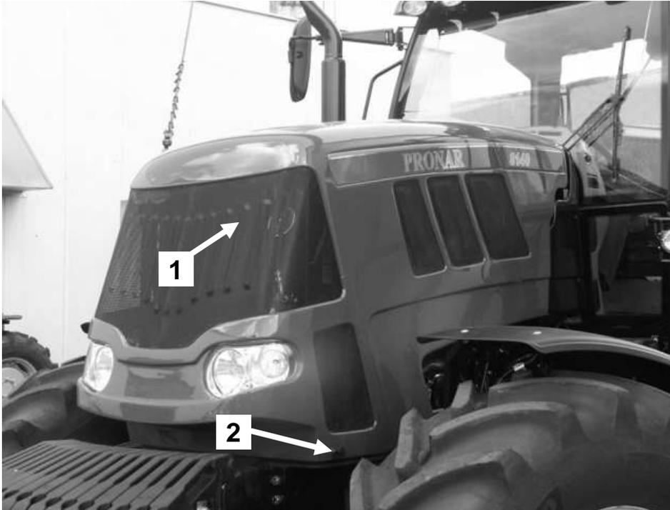
**Рисунок 5-38** Капот и боковые щитки двигателя. 1 - капот; 2 - ручка замка капота
