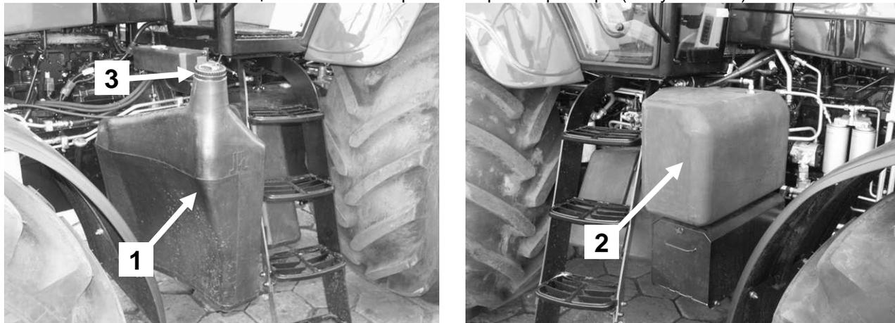
**Рисунок 5-37** Топливный бак. 1 – топливный бак с левой стороны трактора; 2 – топливный бак с правой стороны трактора; 3 –заливная пробка
