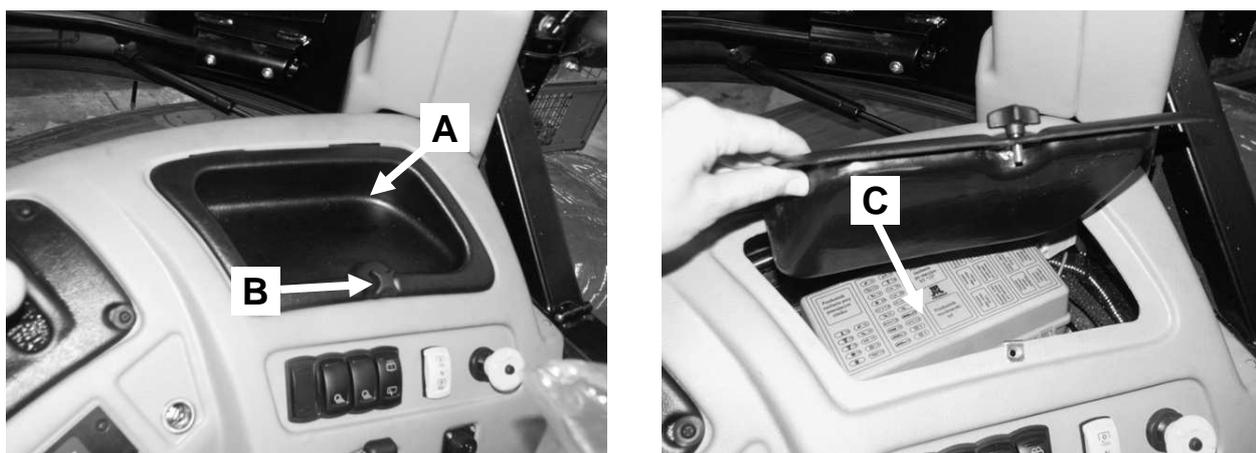
**Рисунок 5-34** Расположение комплекта предохранителей и реле на правом крыле. А- крышка; В- болт; С- коробка предохранителей и реле.
