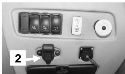
Рисунок 5-30 Присоединение **1** электросети для прицепов и дополнительно гнездо **2** питания +12V 20A для дополнительных устройств, присоединенных к электрической сети трактора.
