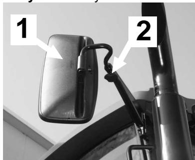
Наружные зеркала заднего вида **1** можно регулировать в любом направлении (вынос и угол наклона). Для изменения положения зеркала нужно слегка отвинтить винты **2**, крепящие держатель зеркала, отрегулировать положение и снова завинтить винты. Зеркала заднего вида должны быть установлены так, чтобы иметь наилучший обзор сзади трактора.
