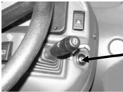
Rys. D-6 Sterowanie rozruchem silnika. 1 – włącznik rozrusznika;
