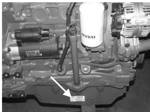
Rys. C-2a Położenie tabliczki silnika IVECO (na misie olejowej z prawej strony silnika)
