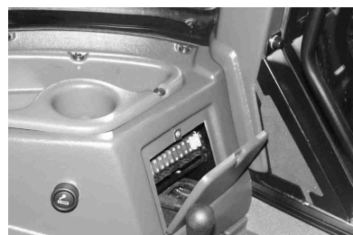
Rys. E-30 Położenie zestawu bezpieczników FB3 na prawym nadkolu. A- śruba; B- pokrywka
