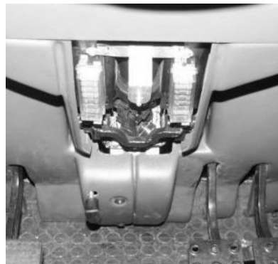
Rys. E-29 Położenie zestawu bezpieczników FB1 i FB2 przy kolumnie kierowniczej. A- śruby; B- pokrywka
