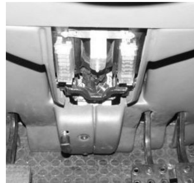
Abb. E-29 Lage der Sicherungssätzen FB1 und FB2 an der Lenksäule. A - Schrauben; B - Abdeckung
