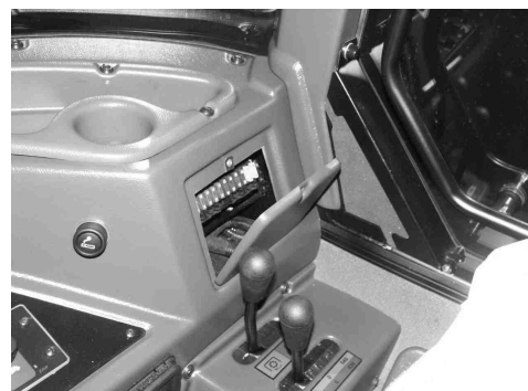
Abb. E-30 Lage des Sicherungssatzes FB3 am rechten Radbogen. A - Schraube; B - Abdeckung
