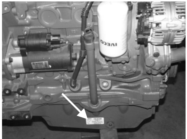
Abb.C-2a Die Lage des Typenschildes des IVECO Motors (an der Ölwanne rechts am Motor)
