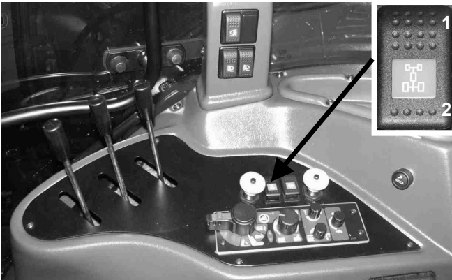
Abb.D-17 Schalter des Vorderachsenantriebs: 1 – Antrieb aus (obere Lage); 2 – Antrieb ein (untere Lage).
