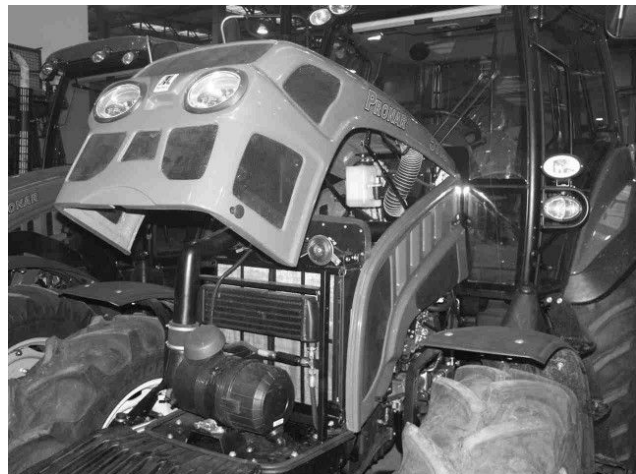
Abb. E-35 Motorhaube und Seitenabdeckungen. 1 – Motorhaube; 2 – Seitenabdeckungen; 3 – Schlösser der Seitenabdeckungen; 4 – Bowdenzug f. Öffnung der Motorhaube
