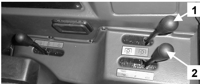
Abb.D-21 Hebel für Drehzalauswahl des Zapfwellenantriebs: 430, 540, 750 oder 1000 Upm.
