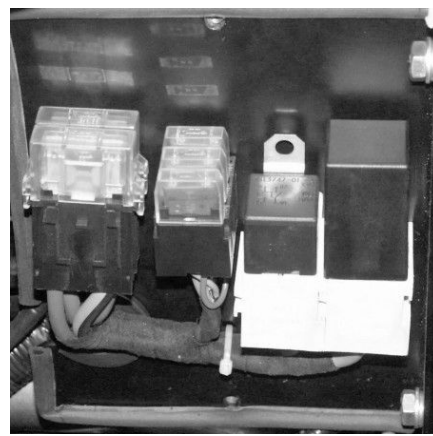
Abb. E-31 Lage der Sicherungssätzen FB4, FB5, FB6. A - Schraube; B - Abdeckung
