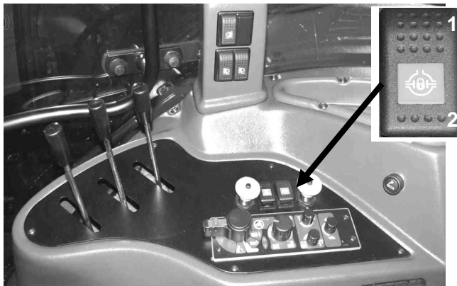
Рисунок 4-28 Управление блокировкой дифференциала заднего моста (находится на панели переключателей с правой стороны сиденья)
