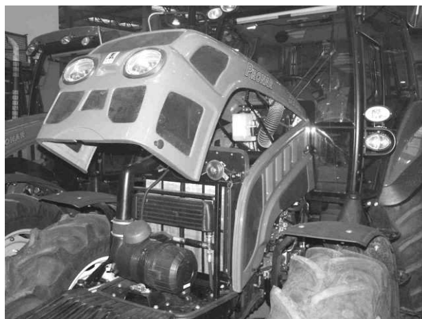
Рисунок 5-41 Капот и боковые щитки двигателя. 1 - капот двигателя; 2 - боковой щиток двигателя; 3 - защелки бокового щитка; 4 - ручка замка капота
