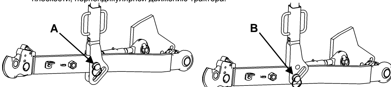
Рисунок 5-13 Способ соединения подвесок с нижними тягово-сцепными устройствами.
