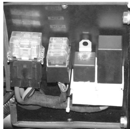
Рисунок 5-36 Расположение комплекта предохранителей FB4, FB5, FB6. А- винт; В- крышка
