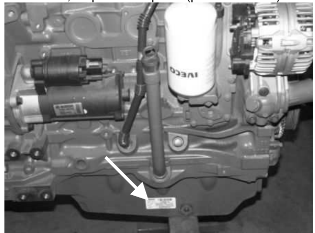
Рисунок 3-2а Расположение заводского щитка двигателя IVECO (на масляном картере, с правой стороны двигателя)
