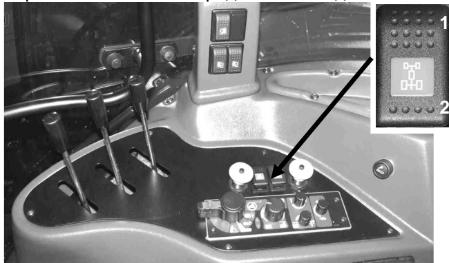
Рисунок 4-27 Выключатель управления приводом переднего моста можно установить в двух положениях:
