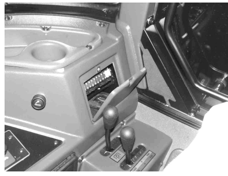
Рисунок 5-35 Расположение комплекта предохранителей FB3 на правом крыле. А- винт; В- крышка
