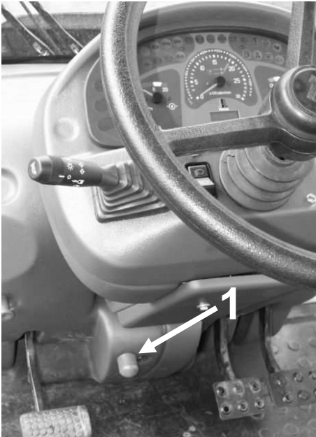
Rys. 19 Cięgnąć blokady nachylenia koła (kolumny) kierownicy.
