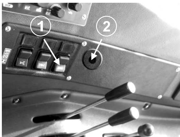
Rys.31c Umieszczenie włącznika i przycisku włączania przedniego WOM. 1- włącznik klawiszowy, 2-przycisk
