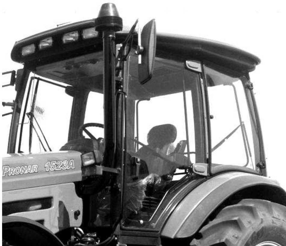
Rys. 5 Kabina Typ KS-04 posiadająca atest bezpieczeństwa OECD nr 4/0 839
