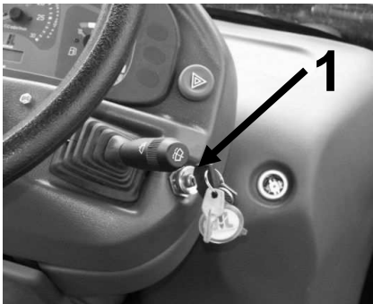
Rys. 8 Sterowanie rozruchem silnika. 1 – włącznik rozrusznika;
