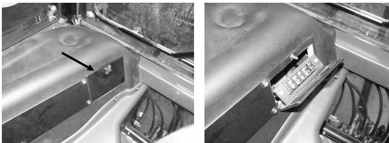
Rys. 49a Położenie zestawu bezpieczników na prawym nadkolu.
