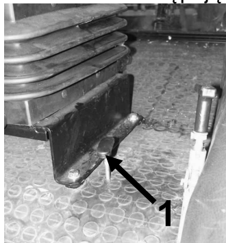
Rys. 31 Sterowanie WOM, obroty: zależne - niezależne 1 - dźwignia włączająca obroty „zależne – niezależne”;
