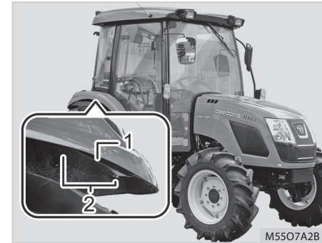
(1) Pokrywka ochronna (2) Śruba mocująca
